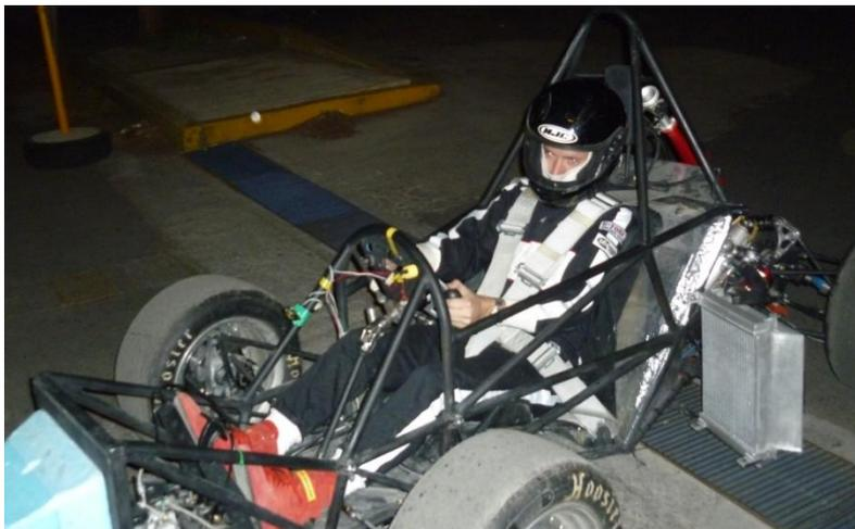
Fig. 4.7. Pruebas del vehículo, el habitáculo cumple con las medidas diseñadas.
