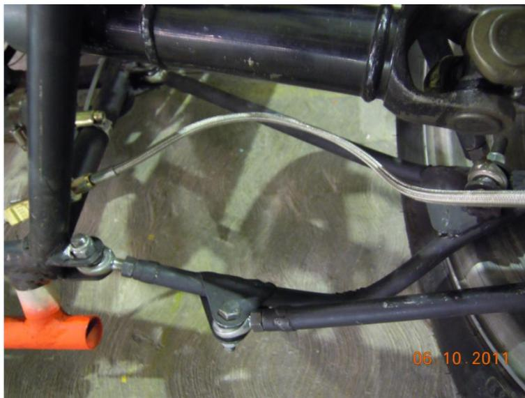
Fig. 5.1. Resultado del impacto de una de las ruedas contra la banqueta de un estacionamiento de la Facultad de Ingeniería.
