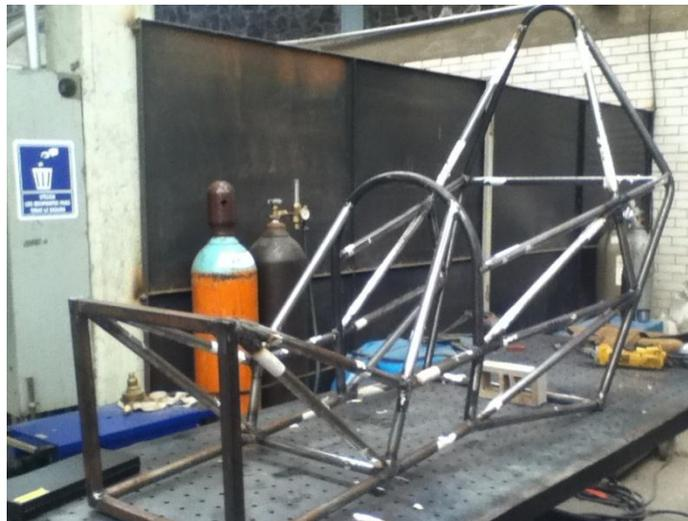
Fig. 4.3. Resultado del paso 3 del proceso de soldadura: zona frontal y habitáculo completos.
