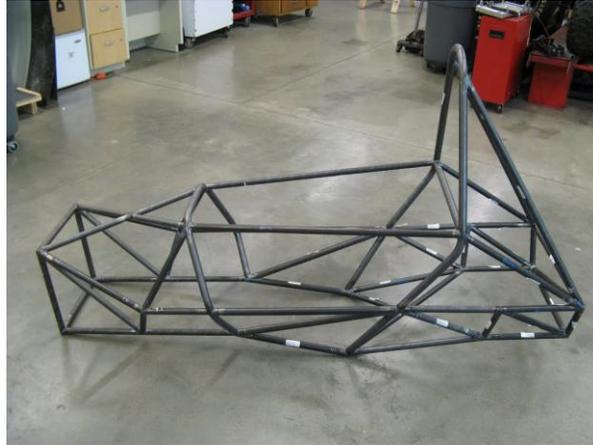
Fig. 3.12. Prototipo Formula SAE 2009 de la UWM.
