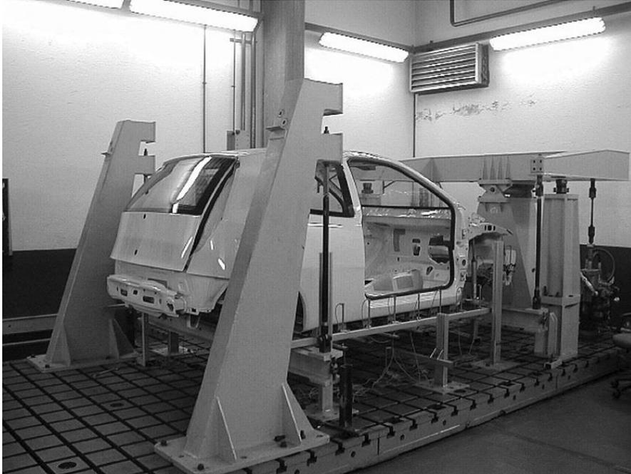
Fig. 2.9. Banco preparado para la prueba de torsión de un auto comercial. [5]
