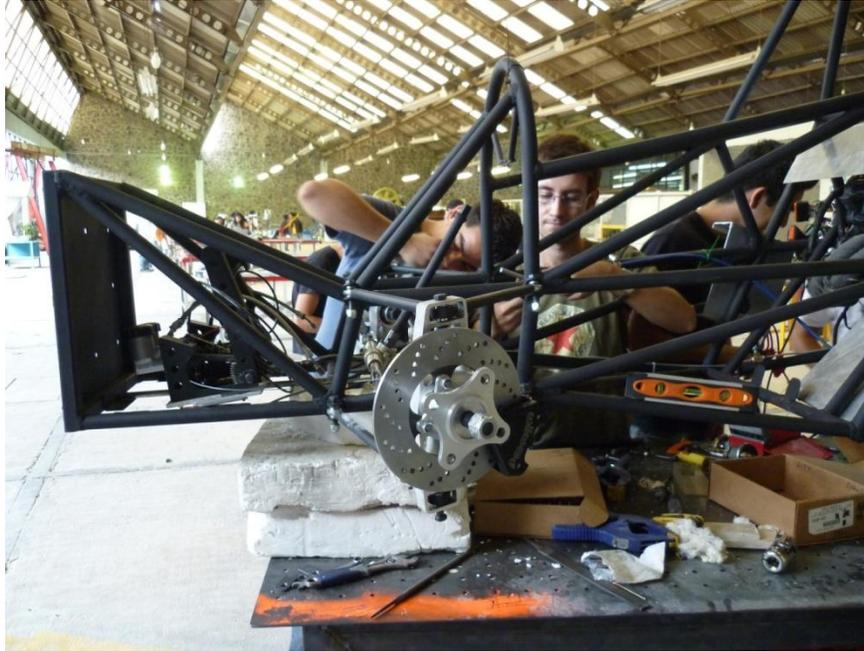
Fig. 4.6. Zona frontal del chasis durante el proceso de ensamble del vehículo.
