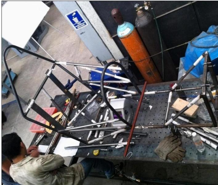
Fig. 4.1. Montaje del bastidor en la mesa de soldadura para el paso 2 del proceso de soldado.
