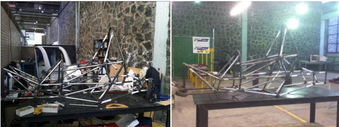
Fig. 4.5. Etapa final de soldadura y resultado.
