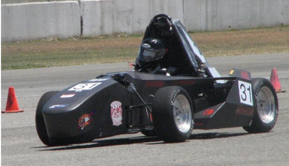
Fig. 2.12. El bastidor 2010 era demasiado ancho para los pilotos.
