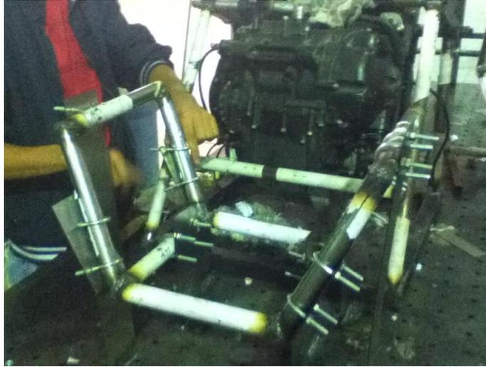
Fig. 4.4. Zona trasera del chasis y banco del motor.
