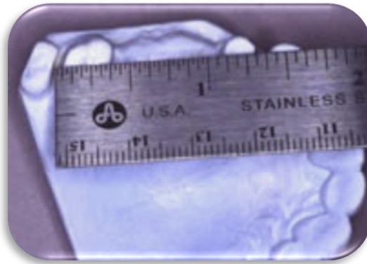
Figura 24. Medición de la brecha para determinar el tamaño de la fibra. 80
