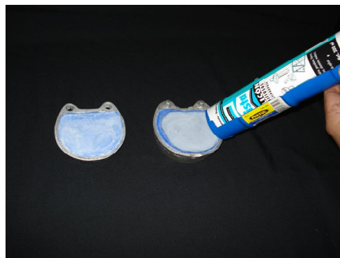
fig. 13: Inyección del silicón
