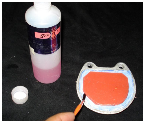
Fig. 6: Colocación del separador.
