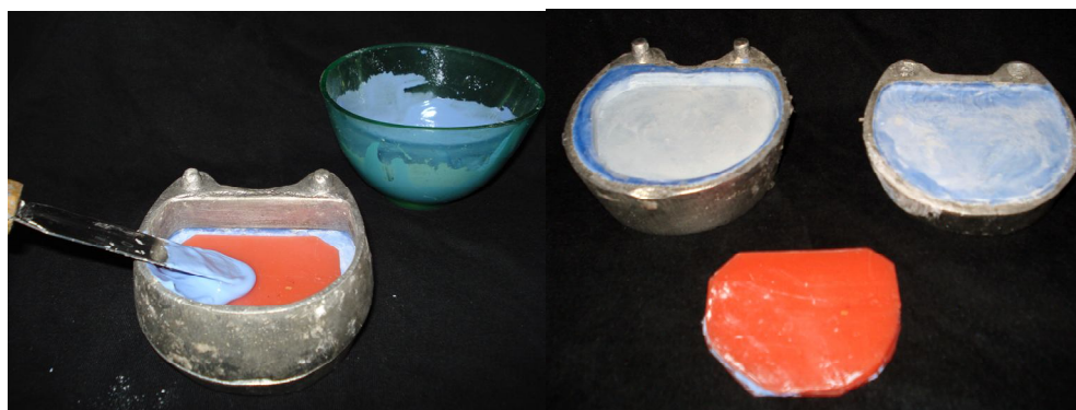
Fig. 7: Llenado de la parte superior de la mufla. Fig. 8: Retirado del patrón de cera.
