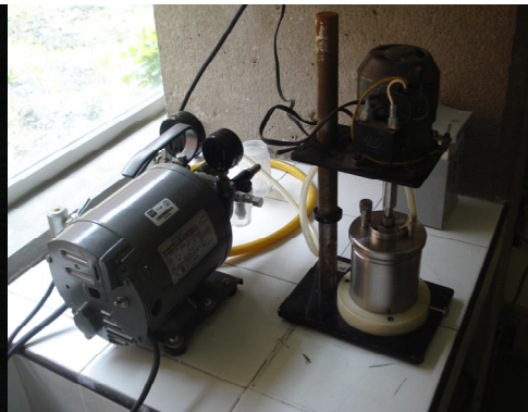
Fig. 15: Homogenización del silicón con el \text{SiO}_2
