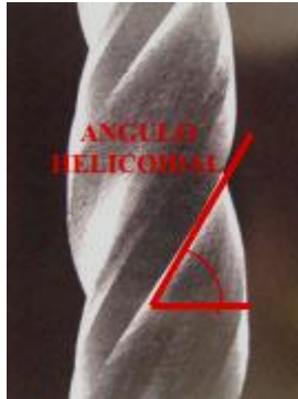
Fig. 15(Ángulo helicoidal de sistema rotatorio K3).
