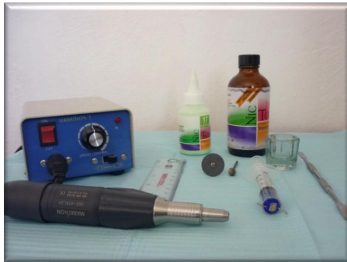
Fig. 77 (Material utilizado para la fijación de los cubos de acrílico en la regla previamente cortada).
