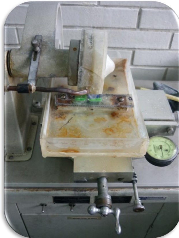
Fig. 78 (Recortadora de disco de diamante del Laboratorio de Materiales Dentales del Posgrado de Odontología, para obtener los cortes transversales).
