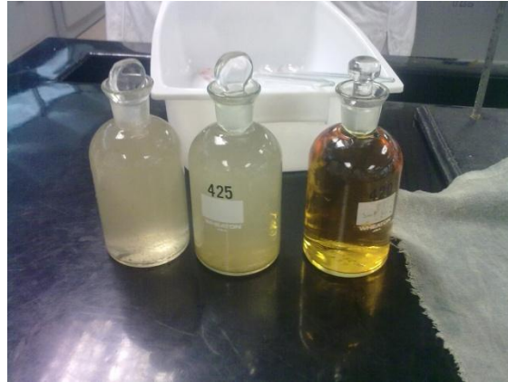
Figura 28 Adición de ácido sulfúrico concentrado a las muestras
