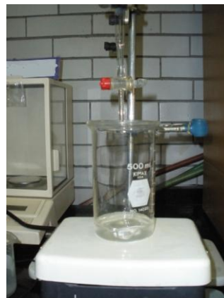
Figura 13 Montaje de equipos y materiales para la prueba de grado de desacetilación del quitosán
