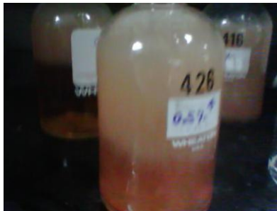
Figura 35 Adición del álcali-yoduro a cada una de las muestras
