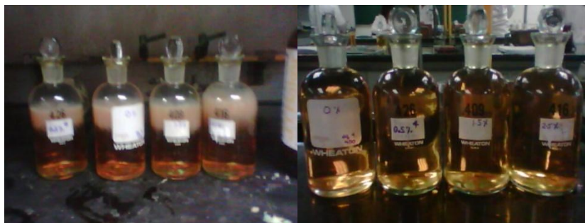
Figura 36 Adición del ácido sulfúrico concentrado
