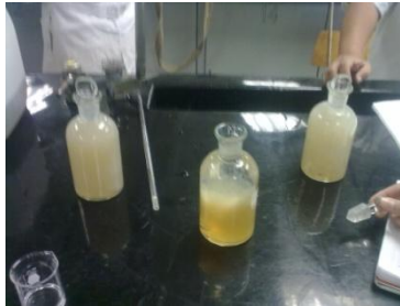
Figura 26 Frascos Winkler con las muestras para determinación de OD
