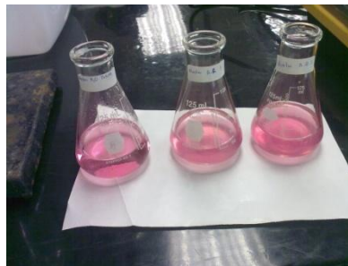
Figura 19 Muestras para determinación de dureza de calcio
