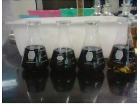
Figura 37 Adición del almidón como indicador
