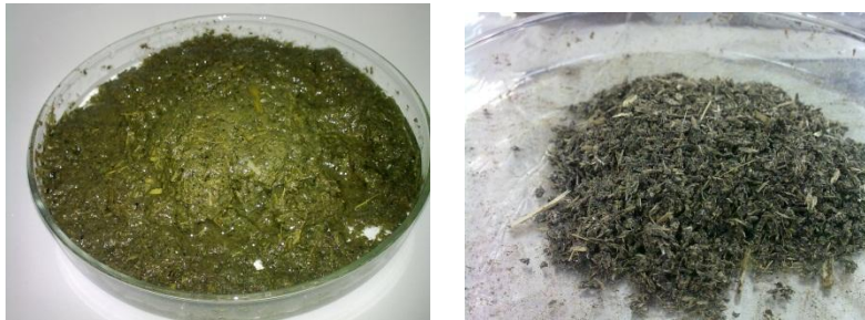
Figura 53 Dsecación de los lodos generados por la coagulación de las aguas residuales con ambos agentes coagulantes.
