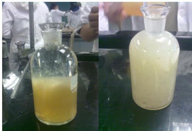
Figura 27 Adición de la solución de Sulfato de manganeso y álcali yoduro
