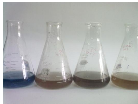
Figura 23 Viraje de color en la titulación
