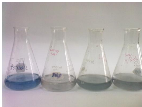
Figura 23 Viraje de color en la titulación
