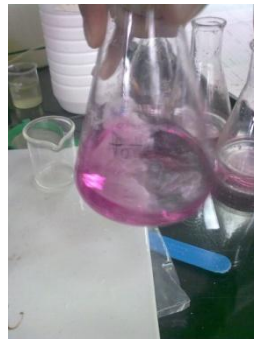
Figura 22 Titulación de las muestras con EDTA 0.01M
