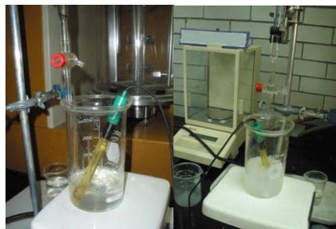
Figura 15 Valoración de la solución ácida de quitosán con hidróxido de sodio
