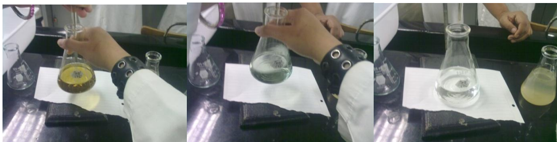
Figura 30 Titulación de las muestras de A.P
