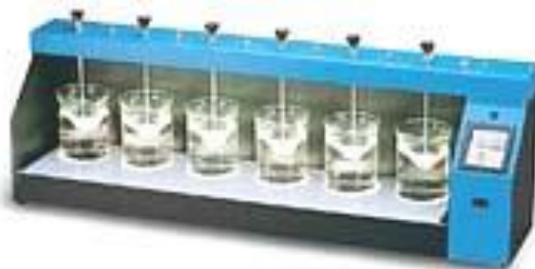
Figura 4 Aparato para llevar a cabo el Ensayo de Jarras
