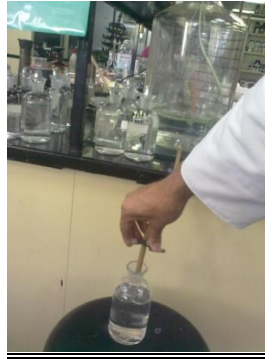
Figura 31 Rellenado de los frascos Winkler con solución nutritiva para DBO
