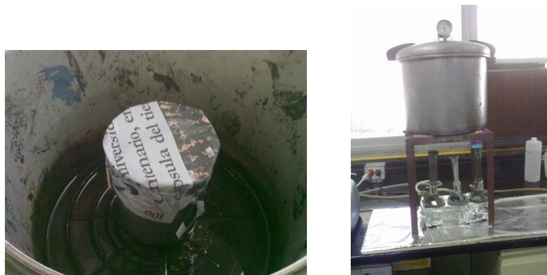
Figura 54 Esterilización de la tierra de cultivo en autoclave.
