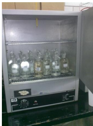
Figura 33 Introducción de los frascos en la estufa para su incubación
