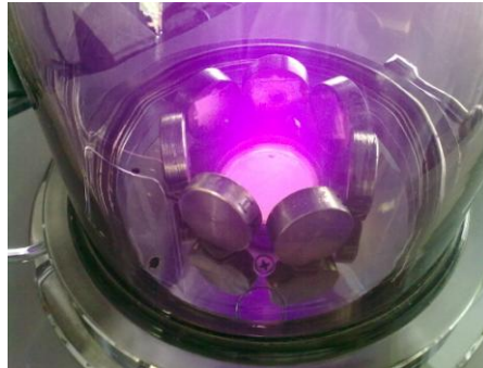
Figura 49 Aparato para baño de oro marca Fine Coat-ion sputter, modelo JFC-1100
