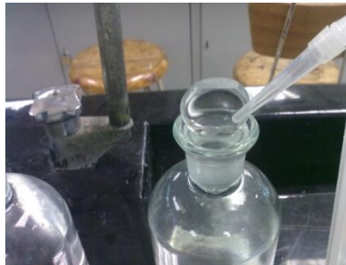
Figura 32 Colocación del tapón de agua en cada uno de los frascos Winkler
