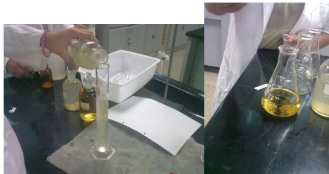
Figura 29 Titulación de las muestras de A.R
