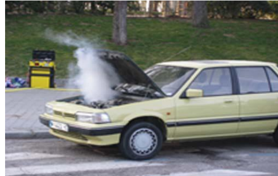
Imagen 20: Incendio provocado por un corto circuito en el arnés del motor.
