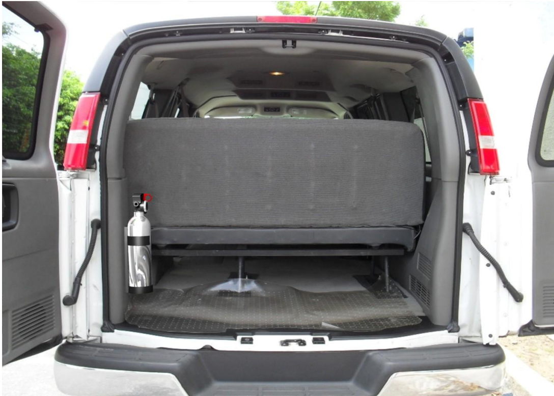
Imagen 69: Vista renderizada de la válvula y extintor montados en la parte posterior de una camioneta tipo Van.
