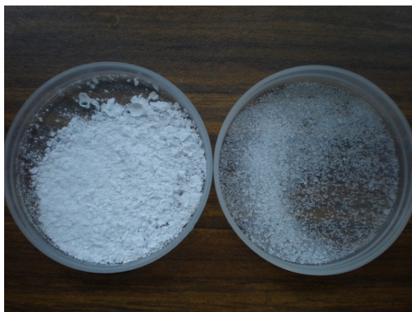
Figura 4.2. Cloruro de sodio antes y después de la liofilización
