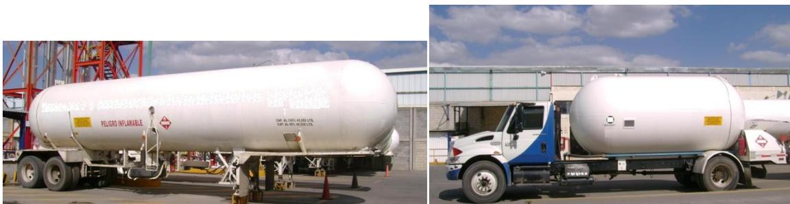
*Figura 2.5.* Fotografías de las pipas de transporte. A la izquierda se observa la pipa de 45,000Lt de capacidad máxima y a la derecha la pipa de 17,000Lt de capacidad máxima
