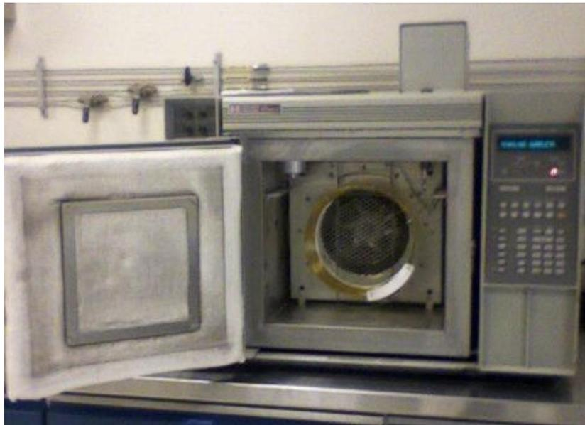
*Figura 2.10.* Fotografía del cromatógrafo de gases utilizado, se observa el horno abierto con la columna capilar enrollada dentro
