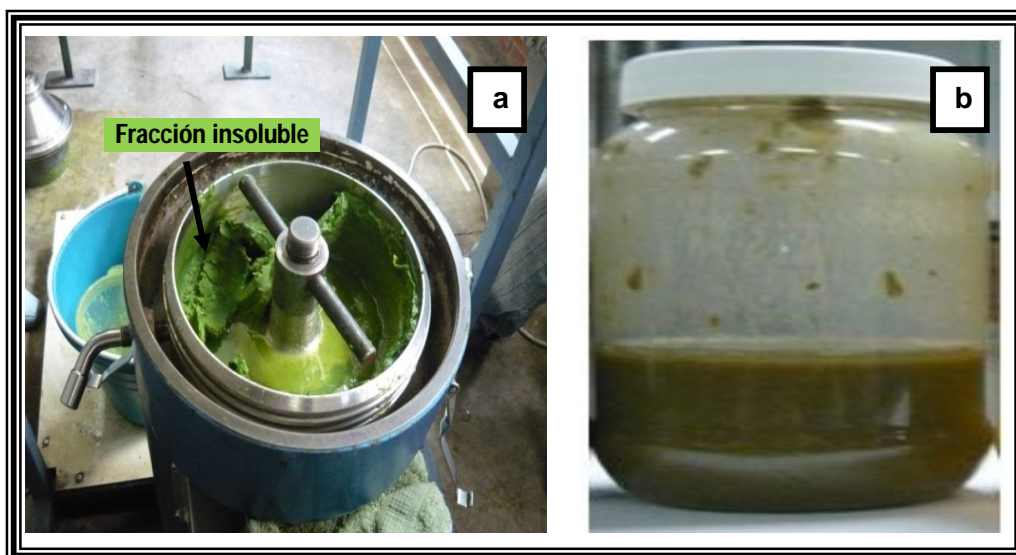
Figura 2.21 a) Fase pesada en tazón; Figura 2.21 b) Sólidos recolectados de la fase pesada
