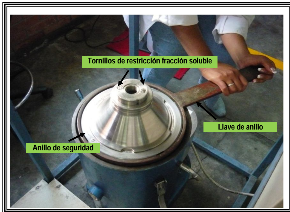
Figura 2.17 Cierre del Anillo de seguridad
