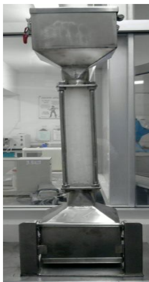
Figura 13. Equipo para medir el volumen específico del pan
