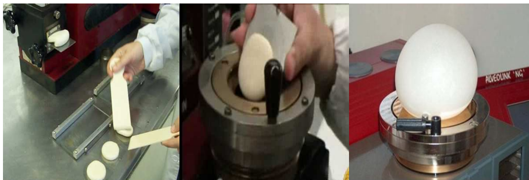
Figura 11. Procedimiento de uso del alveógrafo Chopin
