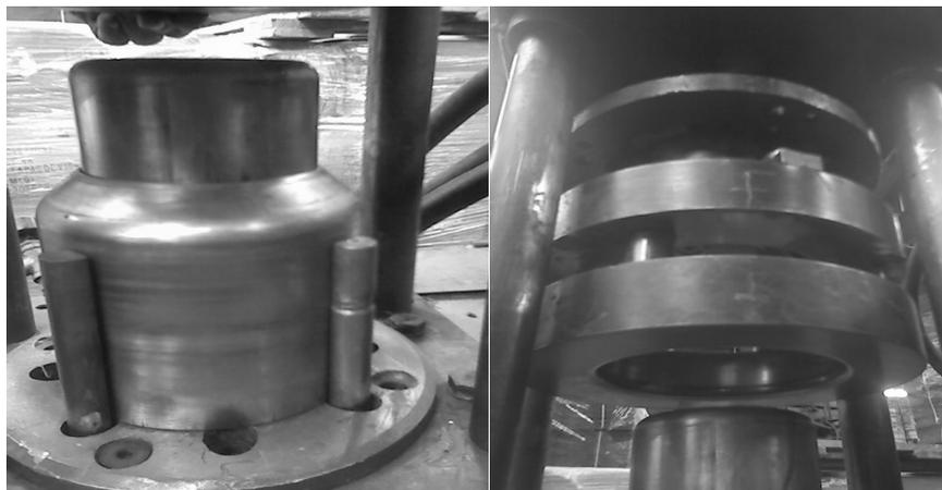
**Figura 20.** Punzones y matrices de un embutido de doble acción
