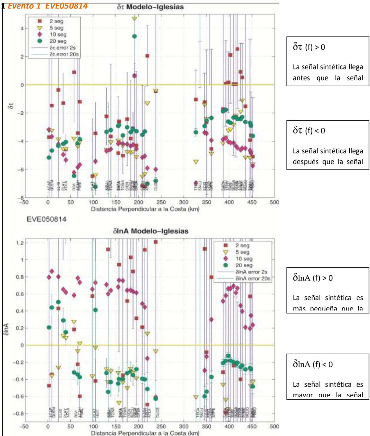
Figura 4.35, Medidas de *multi-taper* entre 2 y 20 s (i.e. de 0.5 a 0.05 Hz) con sus respectivos errores (barras verticales) para las discrepancias en fase  $\delta\tau (f)$  (i.e. tiempos de arribo) (arriba) y en amplitud  $\delta\ln A (f)$  (abajo). Para este evento y este modelo se emplearon 44 estaciones. Los nombres de las estaciones se encuentran en la parte inferior de cada imagen.
