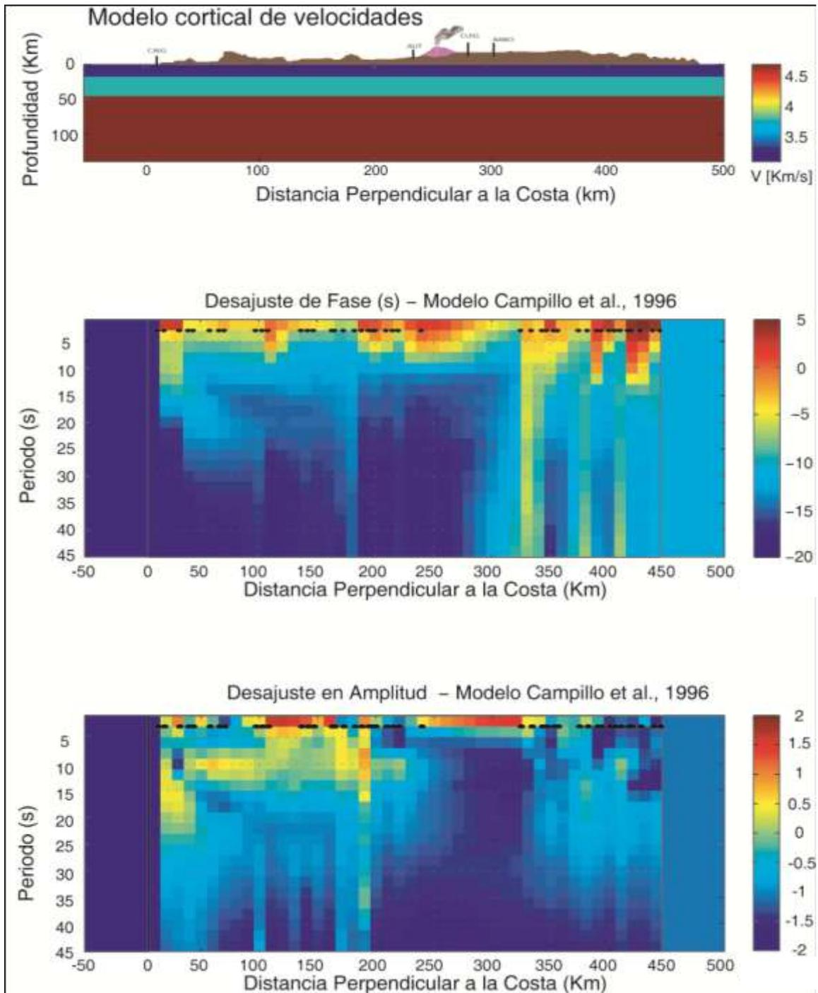
Figura 5.1 Resultados del análisis espectral para el evento 1 EVE050814 en el modelo cortical de velocidades propuesto por Campillo et al. (1996) (Sección 3.4), Modelo cortical de velocidades de ondas S (arriba), desajuste en fase (en medio) y desajuste en amplitud (abajo) para periodos de 2-50 s (0.5-0.02 Hz). Los puntos negros muestran las estaciones usadas en el análisis.
