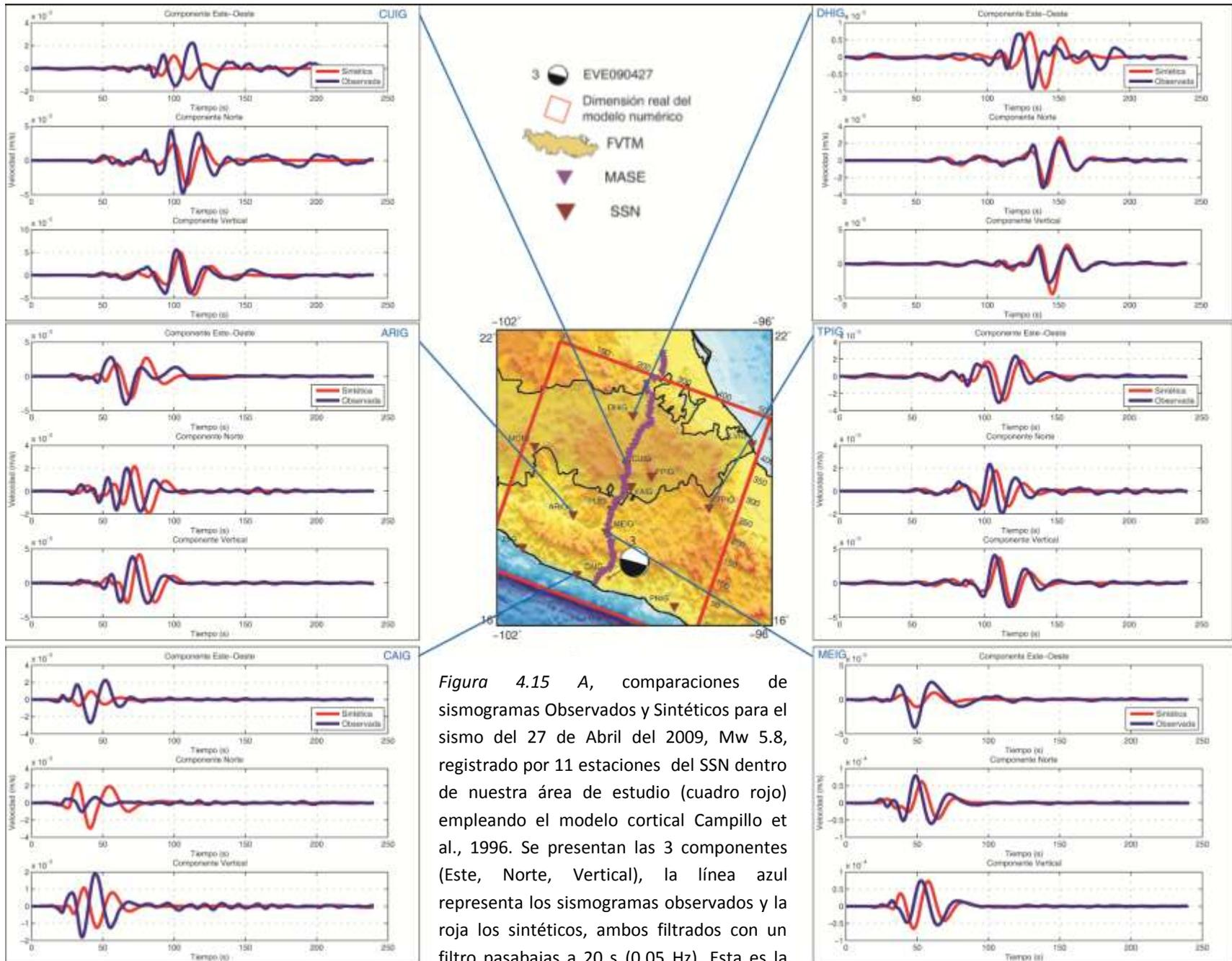
Figura 4.15 A, comparaciones de sismogramas Observados y Sintéticos para el sismo del 27 de Abril del 2009, Mw 5.8, registrado por 11 estaciones del SSN dentro de nuestra área de estudio (cuadro rojo) empleando el modelo cortical Campillo et al., 1996. Se presentan las 3 componentes (Este, Norte, Vertical), la línea azul representa los sismogramas observados y la roja los sintéticos, ambos filtrados con un filtro pasabajas a 20 s (0.05 Hz). Esta es la
