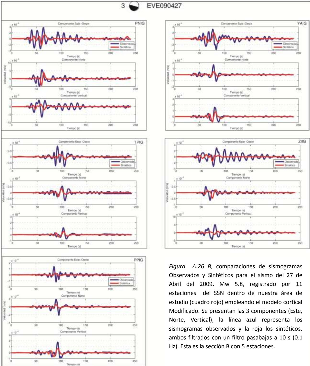
*Figura A.26 B*, comparaciones de sismogramas Observados y Sintéticos para el sismo del 27 de Abril del 2009, Mw 5.8, registrado por 11 estaciones del SSN dentro de nuestra área de estudio (cuadro rojo) empleando el modelo cortical Modificado. Se presentan las 3 componentes (Este, Norte, Vertical), la línea azul representa los sismogramas observados y la roja los sintéticos, ambos filtrados con un filtro pasabajos a 10 s (0.1 Hz). Esta es la sección B con 5 estaciones.
