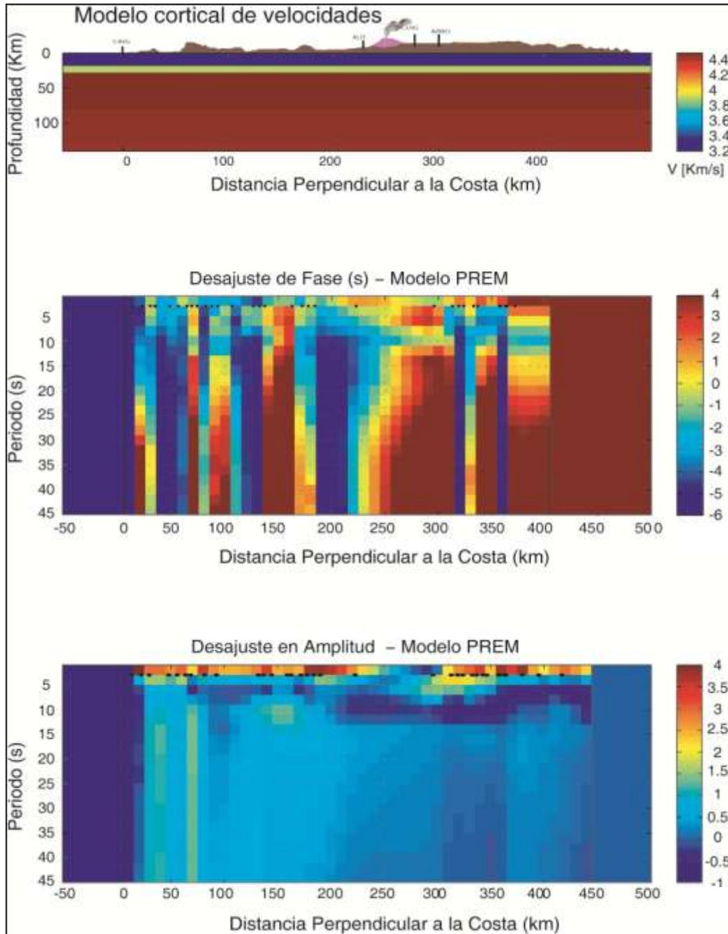
Figura 5.3 Resultados del análisis espectral para el evento 2 EVE070413 en el modelo cortical de velocidades propuesto por PREM (1982) (Sección 3.4), Modelo cortical de velocidades de ondas S (arriba), desajuste en fase (en medio) y desajuste en amplitud (abajo) para periodos de 2-50 s (0.5-0.02 Hz). Los puntos negros muestran las estaciones usadas en el análisis.
