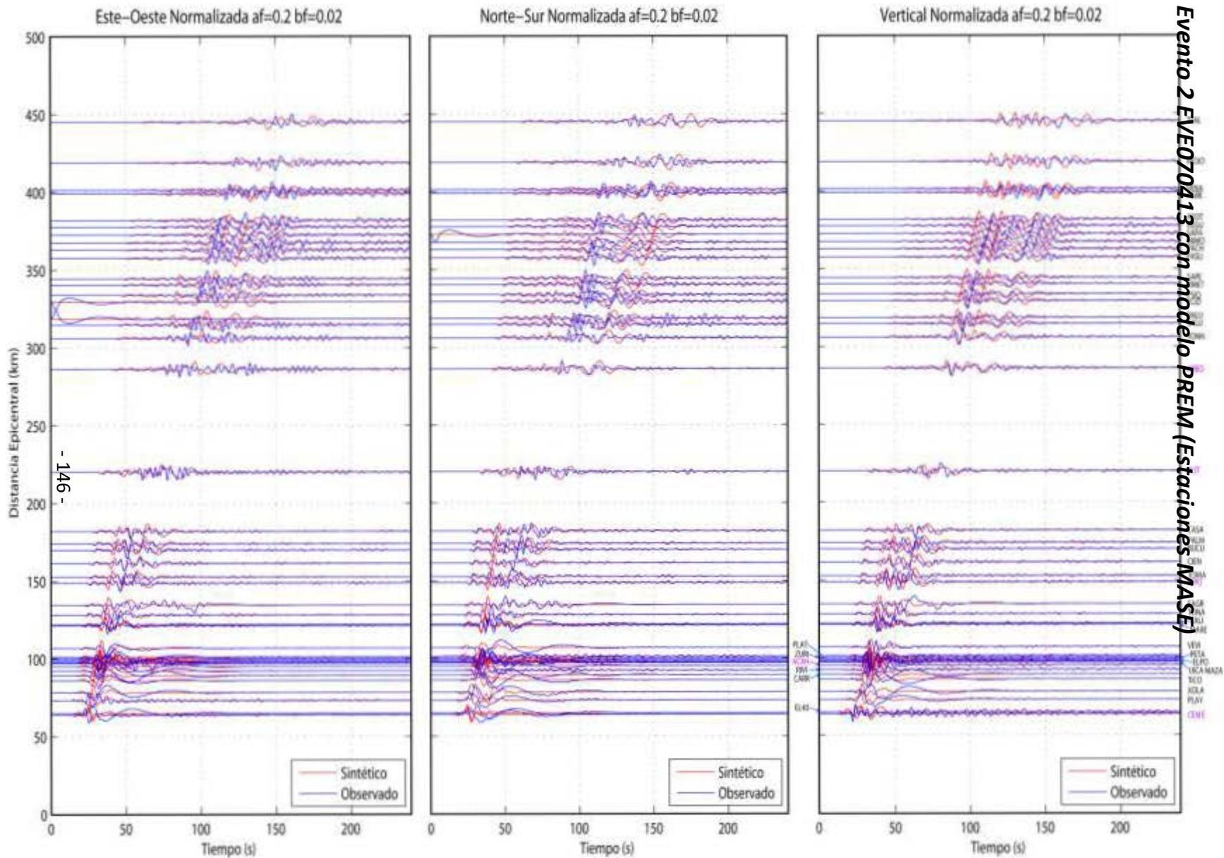
Figura A.2, Comparaciones de sismogramas Observados y Sintéticos para el sismo de Atoyac Mw 5.9 del 13 de Abril de 2007 empleando el modelo cortical PREM (1982) a lo largo de 45 estaciones del arreglo MASE. Se presentan las 3 componentes (Este, Norte, Vertical) los sismogramas están ordenados por distancia epicentral a partir de la costa (Acapulco), la línea azul representa los sismogramas observados y la roja los sintéticos, ambos filtrados con un filtro pasabajas a 5 s (0.2 Hz).
