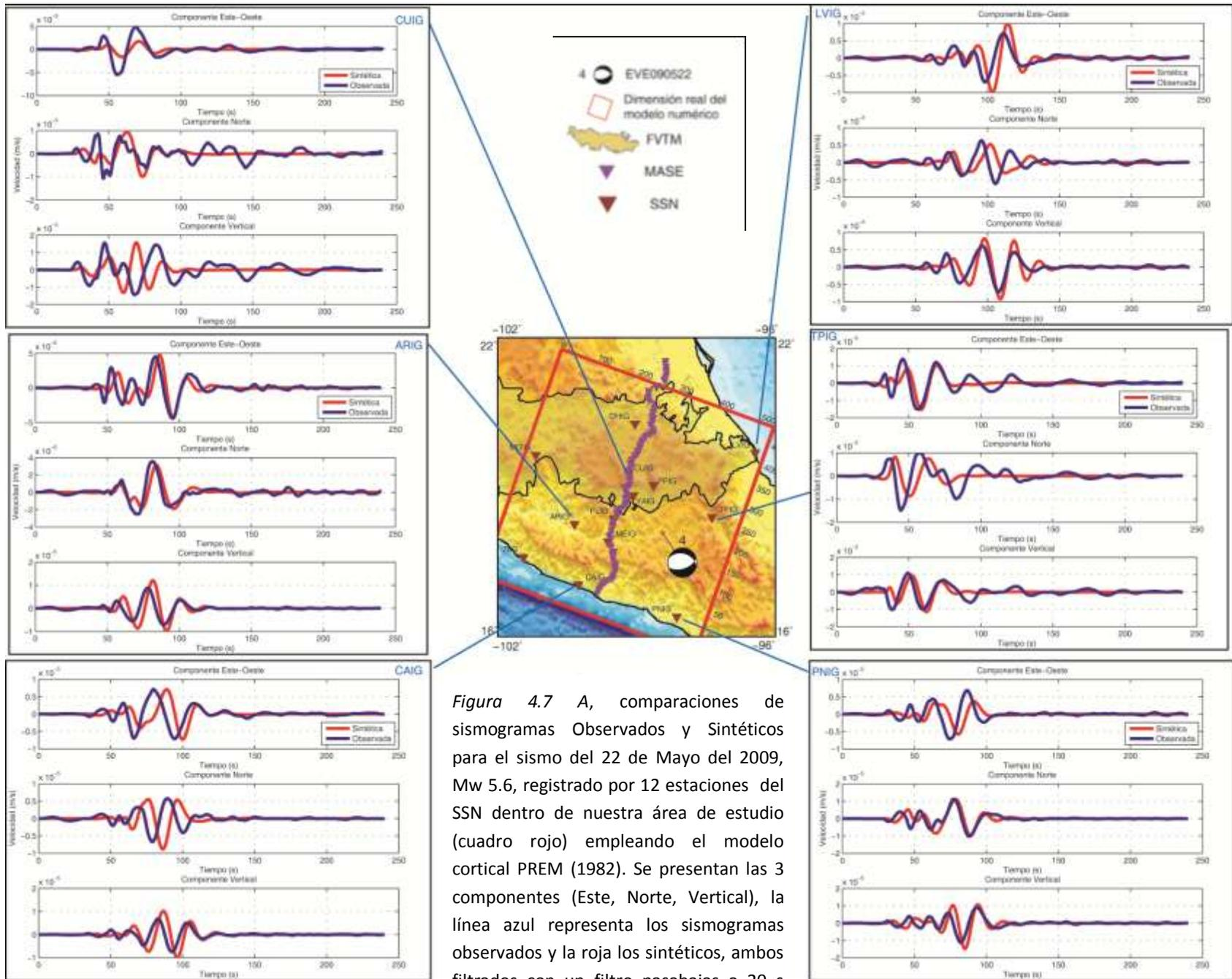
Figura 4.7 A, comparaciones de sismogramas Observados y Sintéticos para el sismo del 22 de Mayo del 2009, Mw 5.6, registrado por 12 estaciones del SSN dentro de nuestra área de estudio (cuadro rojo) empleando el modelo cortical PREM (1982). Se presentan las 3 componentes (Este, Norte, Vertical), la línea azul representa los sismogramas observados y la roja los sintéticos, ambos filtrados con un filtro pasabajos a 20 s (0.05 Hz). Esta es la sección A con 6
