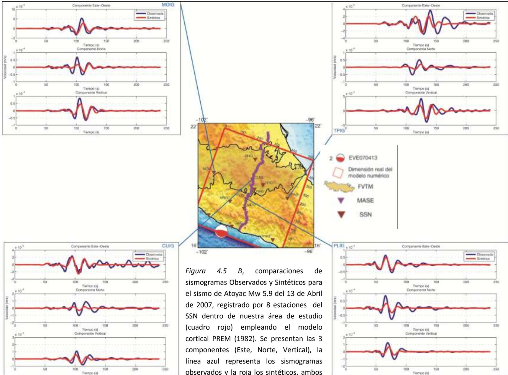
Figura 4.5 B, comparaciones de sismogramas Observados y Sintéticos para el sismo de Atoyac Mw 5.9 del 13 de Abril de 2007, registrado por 8 estaciones del SSN dentro de nuestra área de estudio (cuadro rojo) empleando el modelo cortical PREM (1982). Se presentan las 3 componentes (Este, Norte, Vertical), la línea azul representa los sismogramas observados y la roja los sintéticos, ambos filtrados con un filtro pasabajas a 20 s
