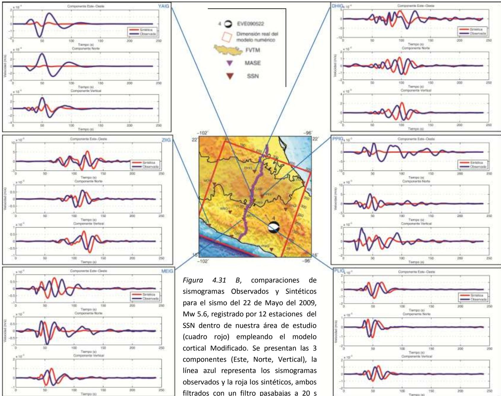
Figura 4.31 B, comparaciones de sismogramas Observados y Sintéticos para el sismo del 22 de Mayo del 2009, Mw 5.6, registrado por 12 estaciones del SSN dentro de nuestra área de estudio (cuadro rojo) empleando el modelo cortical Modificado. Se presentan las 3 componentes (Este, Norte, Vertical), la línea azul representa los sismogramas observados y la roja los sintéticos, ambos filtrados con un filtro pasabajas a 20 s (0.05 Hz). Esta es la sección B con 6
