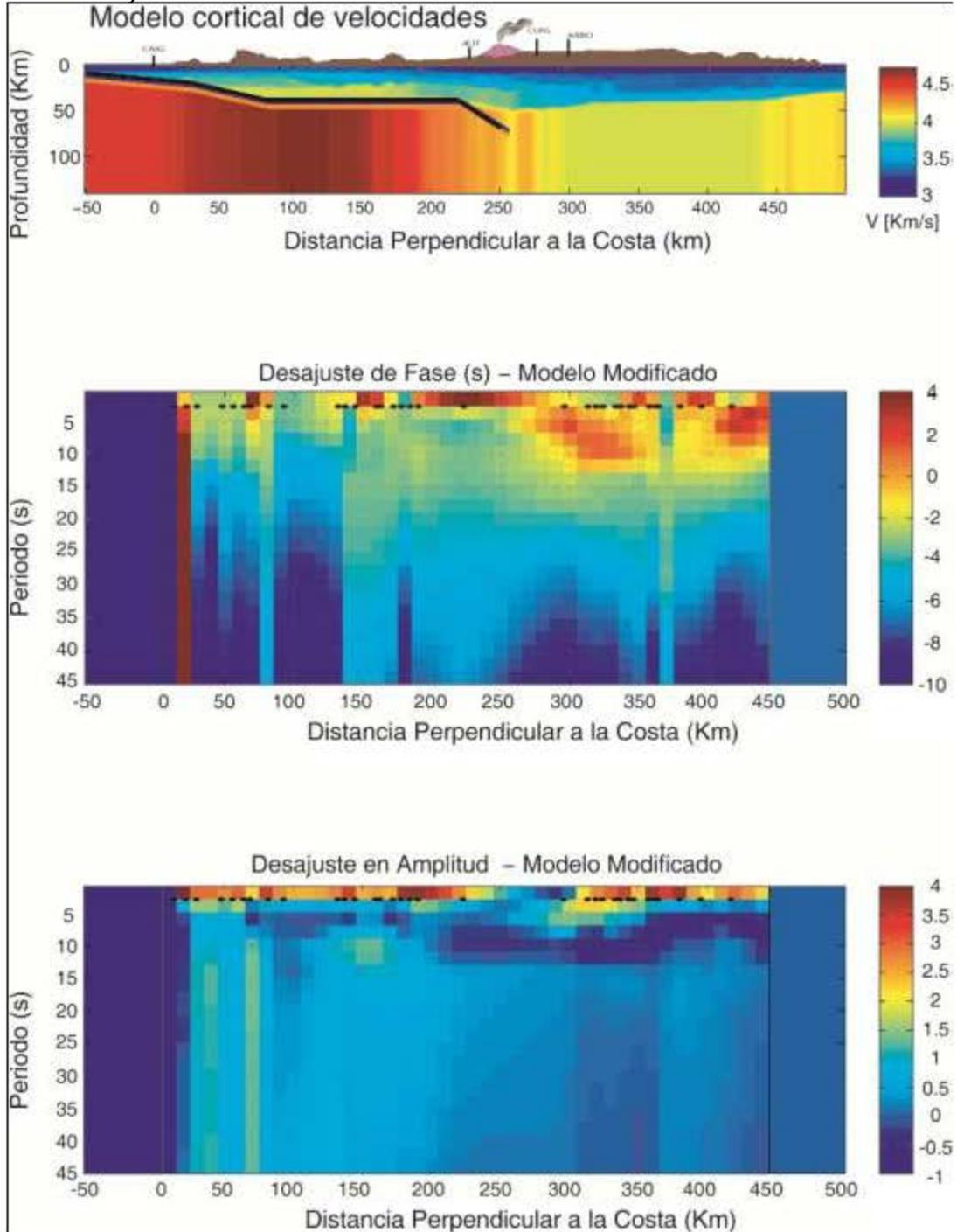
Figura 5.6 Resultados del análisis espectral para el evento 2 EVE070413 en el modelo cortical de velocidades propuesto por el Modelo Modificado (Sección 3.4), Modelo cortical de velocidades de ondas S (arriba), desajuste en fase (en medio) y desajuste en amplitud (abajo) para periodos de 2-50 s (0.5-0.02 Hz). Los puntos negros muestran las estaciones usadas en el análisis.
