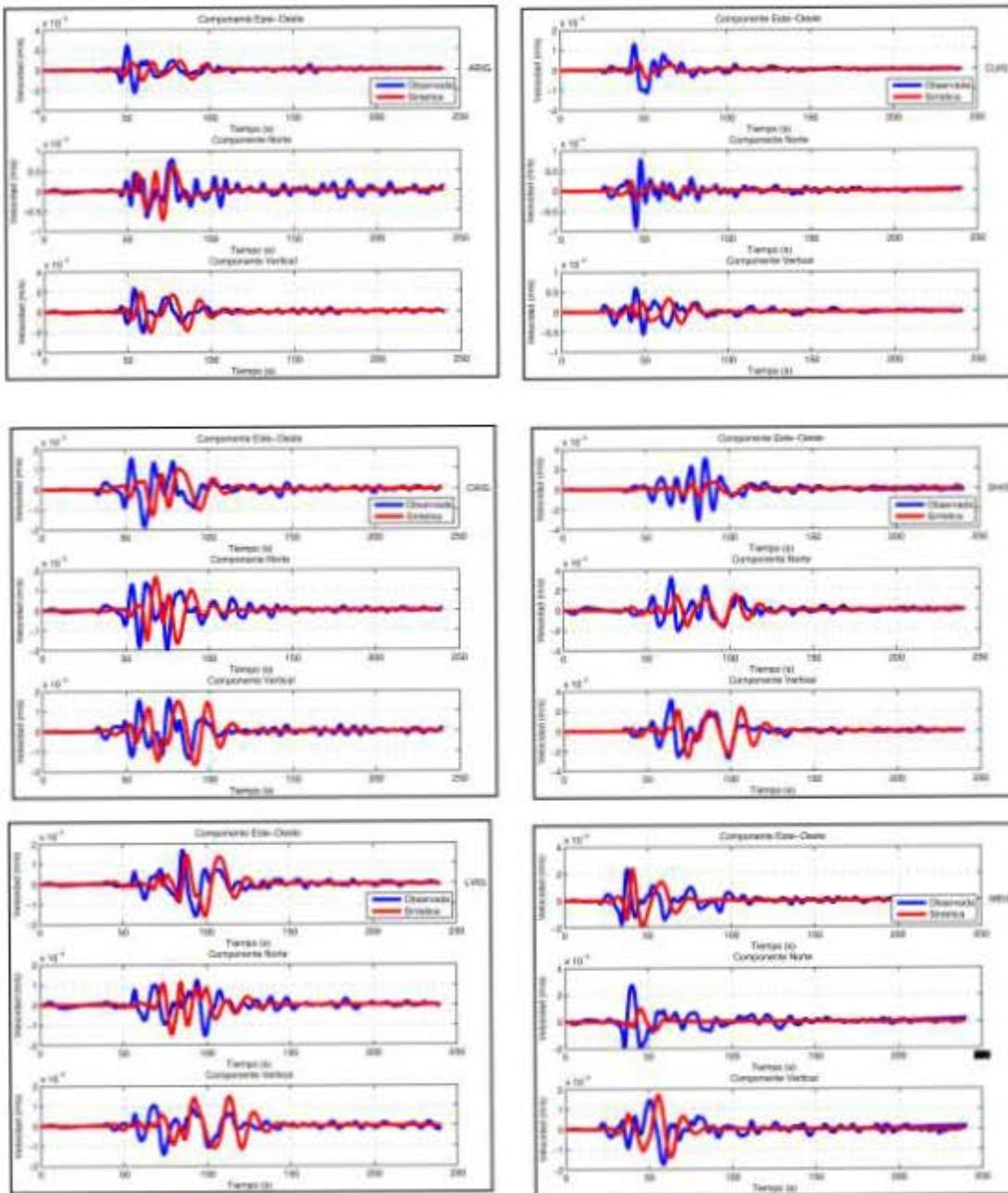
Figura A.5-A, comparaciones de sismogramas Observados y Sintéticos para el sismo del 22 de Mayo del 2009, Mw 5.6, registrado por 12 estaciones del SSN dentro de nuestra área de estudio (cuadro rojo) empleando el modelo cortical PREM (1982). Se presentan las 3 componentes (Este, Norte, Vertical), la línea azul representa los sismogramas observados y la roja los sintéticos, ambos filtrados con un filtro pasabajos a 10 s (0.1 Hz). Esta es la sección A con 6 estaciones.
