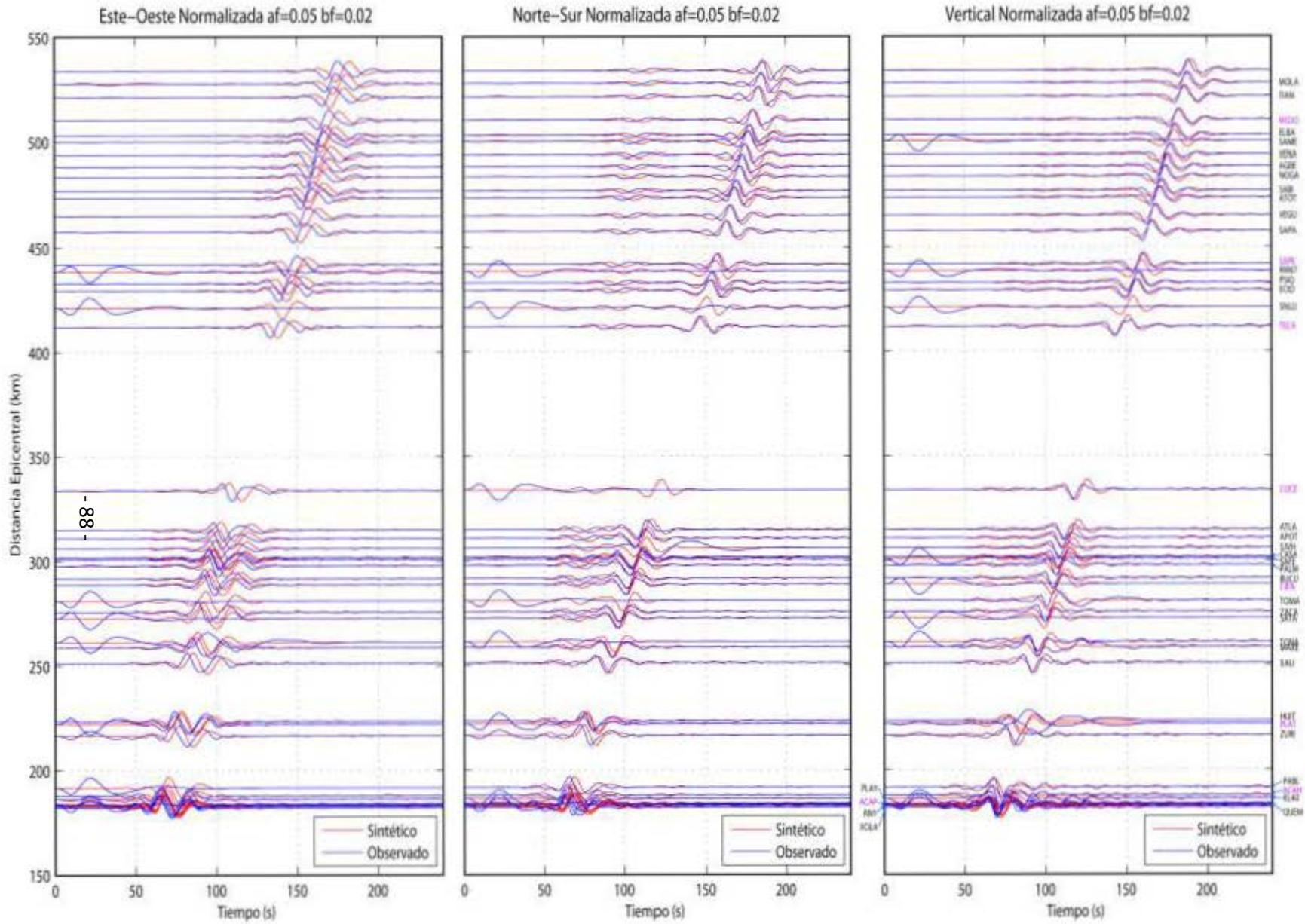
Figura 4.19, Comparaciones de sismogramas Observados y Sintéticos para el sismo del 14 de agosto del 2005 Mw 5.4, empleando el modelo cortical Iglesias et al., 2010 a lo largo de 44 estaciones del arreglo MASE. Se presentan las 3 componentes (Este, Norte, Vertical) los sismogramas están ordenados por distancia epicentral a partir de la costa (Acapulco), la línea azul representa los sismogramas observados y la roja los sintéticos, ambos filtrados con un filtro pasabajas a 20 s (0.1 Hz).
