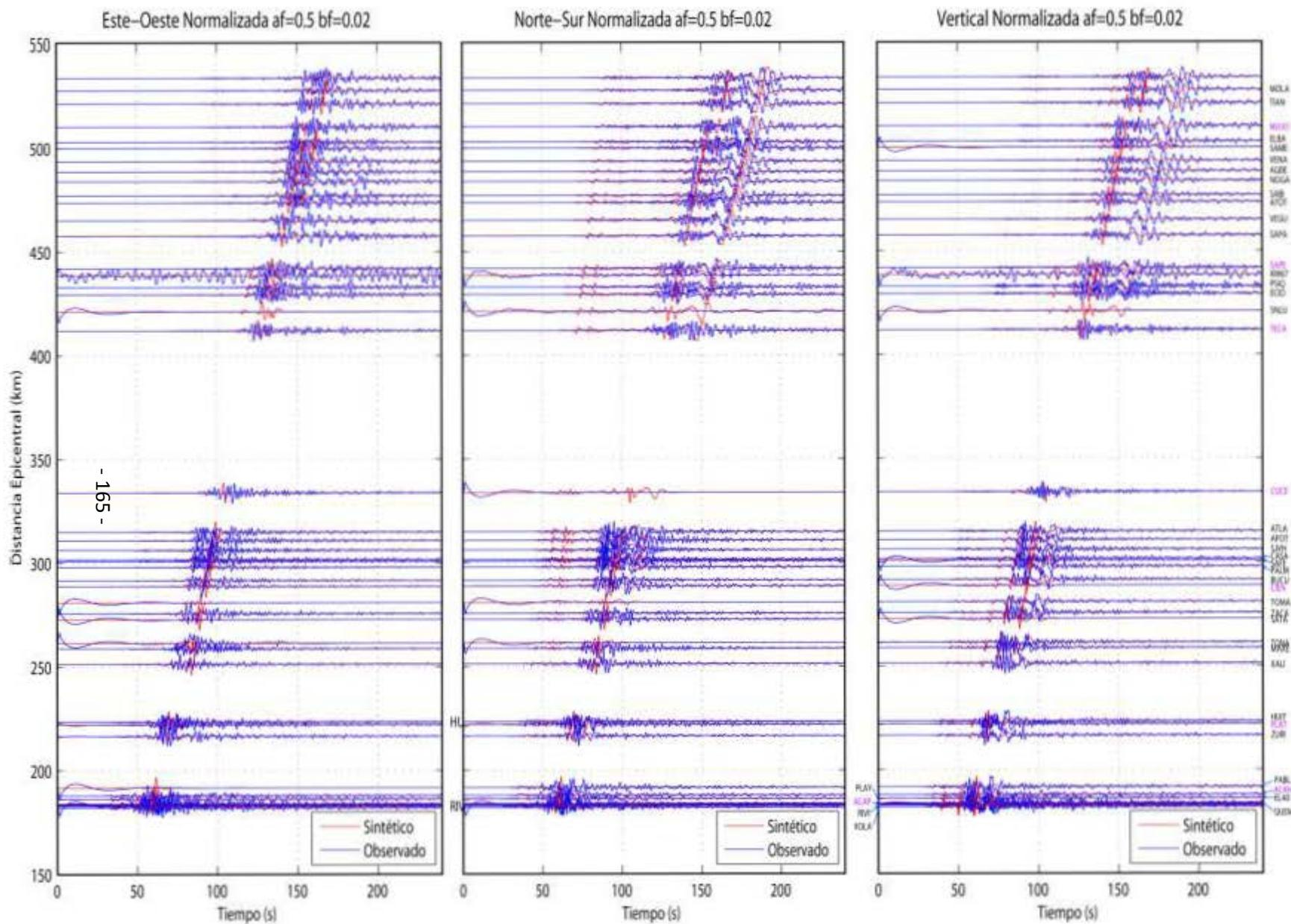
Figura A.15, Comparaciones de sismogramas Observados y Sintéticos para el sismo del 14 de agosto del 2005 Mw 5.4, empleando el modelo cortical Iglesias et al., 2010 a lo largo de 44 estaciones del arreglo MASE. Se presentan las 3 componentes (Este, Norte, Vertical) los sismogramas están ordenados por distancia epicentral a partir de la costa (Acapulco), la línea azul representa los sismogramas observados y la roja los sintéticos, ambos filtrados con un filtro pasabajos a 2 s (0.5 Hz).
