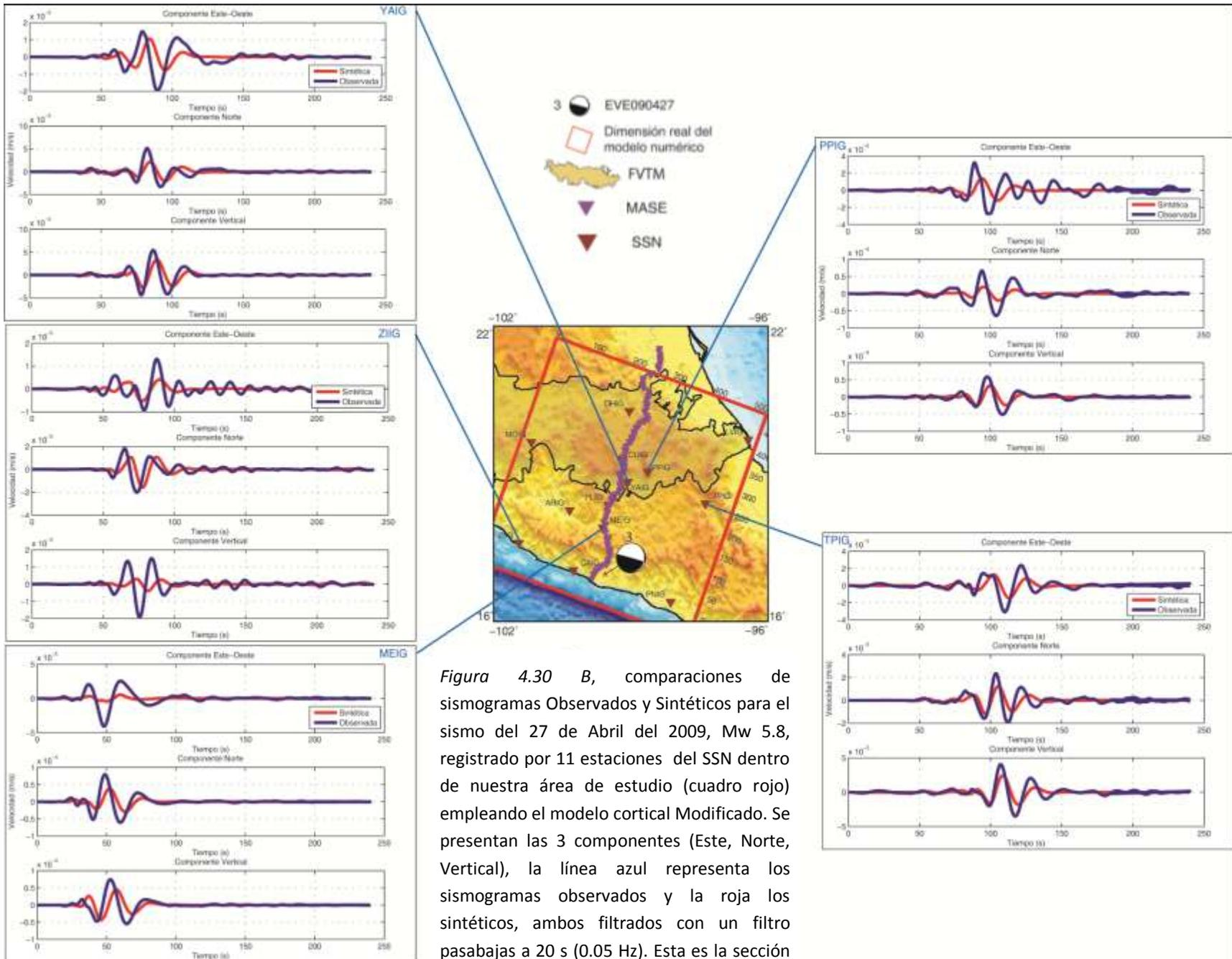
Figura 4.30 B, comparaciones de sismogramas Observados y Sintéticos para el sismo del 27 de Abril del 2009, Mw 5.8, registrado por 11 estaciones del SSN dentro de nuestra área de estudio (cuadro rojo) empleando el modelo cortical Modificado. Se presentan las 3 componentes (Este, Norte, Vertical), la línea azul representa los sismogramas observados y la roja los sintéticos, ambos filtrados con un filtro pasabajos a 20 s (0.05 Hz). Esta es la sección
