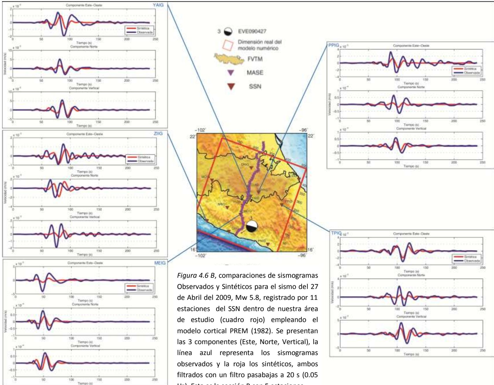
Figura 4.6 B, comparaciones de sismogramas Observados y Sintéticos para el sismo del 27 de Abril del 2009, Mw 5.8, registrado por 11 estaciones del SSN dentro de nuestra área de estudio (cuadro rojo) empleando el modelo cortical PREM (1982). Se presentan las 3 componentes (Este, Norte, Vertical), la línea azul representa los sismogramas observados y la roja los sintéticos, ambos filtrados con un filtro pasabajas a 20 s (0.05 Hz). Esta es la sección B con 5 estaciones.
