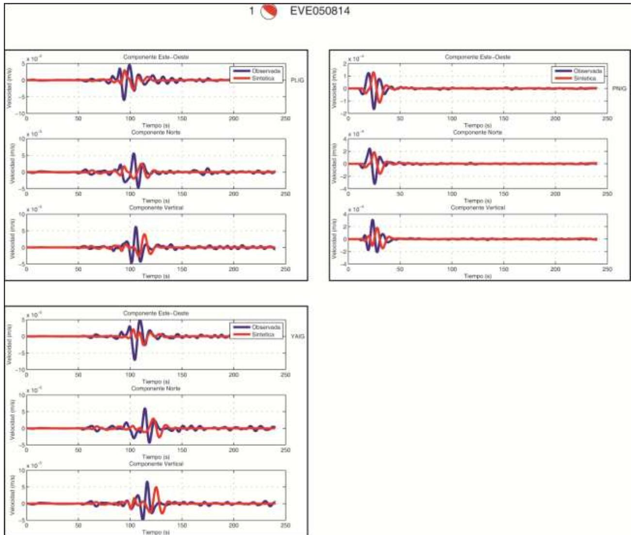
Figura A.9- B, comparaciones de sismogramas Observados y Sintéticos para el sismo del 14 de Agosto del 2005, Mw 5.4, registrado por 9 estaciones del SSN dentro de nuestra área de estudio (cuadro rojo) empleando el modelo cortical Campillo et al., 1996. Se presentan las 3 componentes (Este, Norte, Vertical), la línea azul representa los sismogramas observados y la roja los sintéticos, ambos filtrados con un filtro pasabajas a 10 s (0.1 Hz). Esta es la sección B con 3 estaciones.
