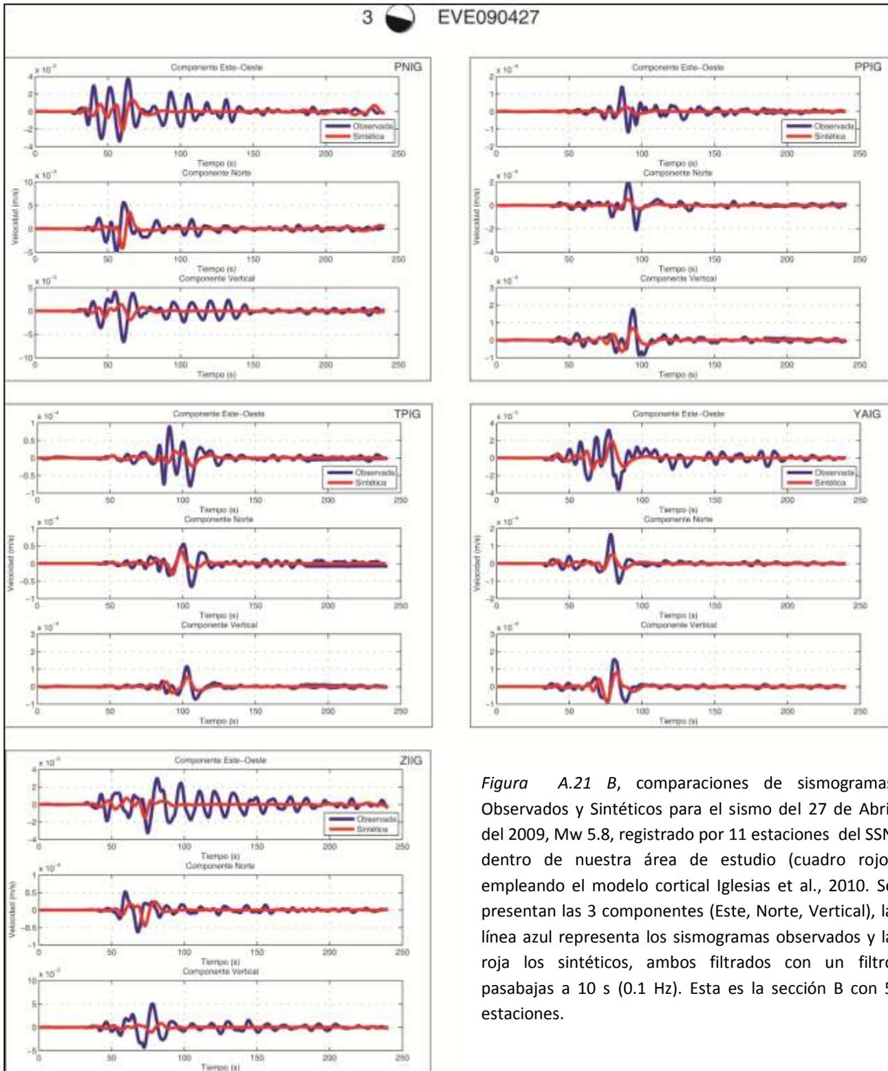
Figura A.21 B, comparaciones de sismogramas Observados y Sintéticos para el sismo del 27 de Abril del 2009, Mw 5.8, registrado por 11 estaciones del SSN dentro de nuestra área de estudio (cuadro rojo) empleando el modelo cortical Iglesias et al., 2010. Se presentan las 3 componentes (Este, Norte, Vertical), la línea azul representa los sismogramas observados y la roja los sintéticos, ambos filtrados con un filtro pasabajas a 10 s (0.1 Hz). Esta es la sección B con 5 estaciones.
