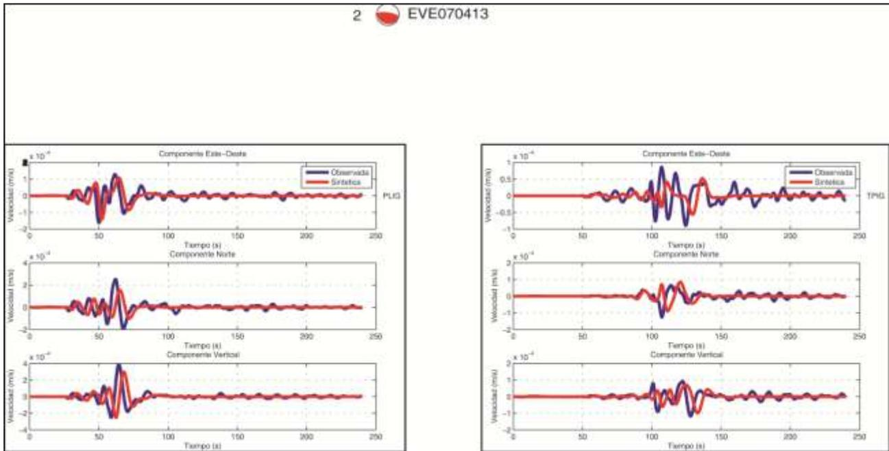
Figura A.12 B, comparaciones de sismogramas Observados y Sintéticos para el sismo de Atoyac Mw 5.9 del 13 de Abril de 2007, registrado por 8 estaciones del SSN dentro de nuestra área de estudio (cuadro rojo) empleando el modelo cortical Campillo et al., 1996. Se presentan las 3 componentes (Este, Norte, Vertical), la línea azul representa los sismogramas observados y la roja los sintéticos, ambos filtrados con un filtro pasabajas a 10 s (0.1 Hz). Esta es la sección B con 2 estaciones.
