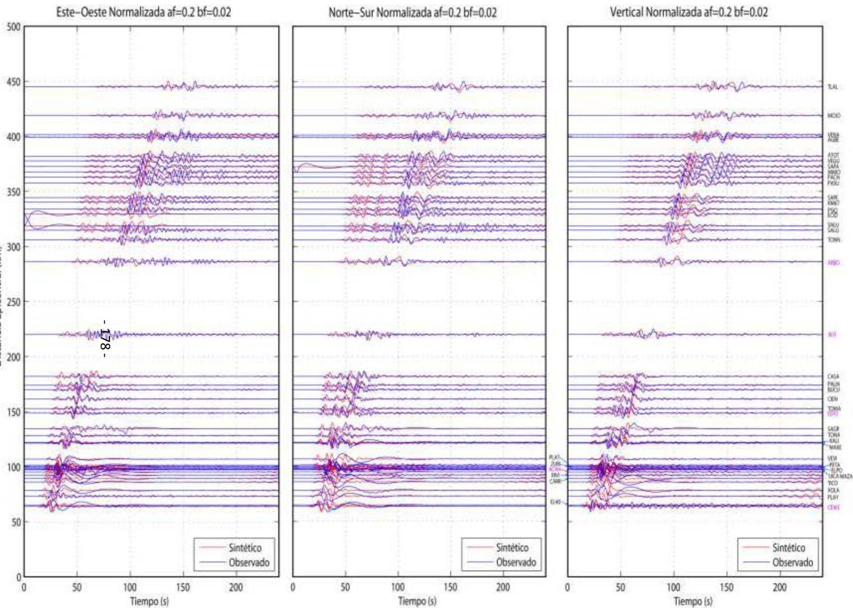
Figura A.24, Comparaciones de sismogramas Observados y Sintéticos para el sismo de Atoyac del 13 de abril del 2007, Mw 5.9, empleando el modelo Modificado a lo largo de 45 estaciones del arreglo MASE. Se presentan las 3 componentes (Este, Norte, Vertical) los sismogramas están ordenados por distancia epicentral a partir de la costa (Acapulco), la línea azul representa los sismogramas observados y la roja los sintéticos, ambos filtrados con un filtro pasabañas a 5 s (0.2 Hz).
