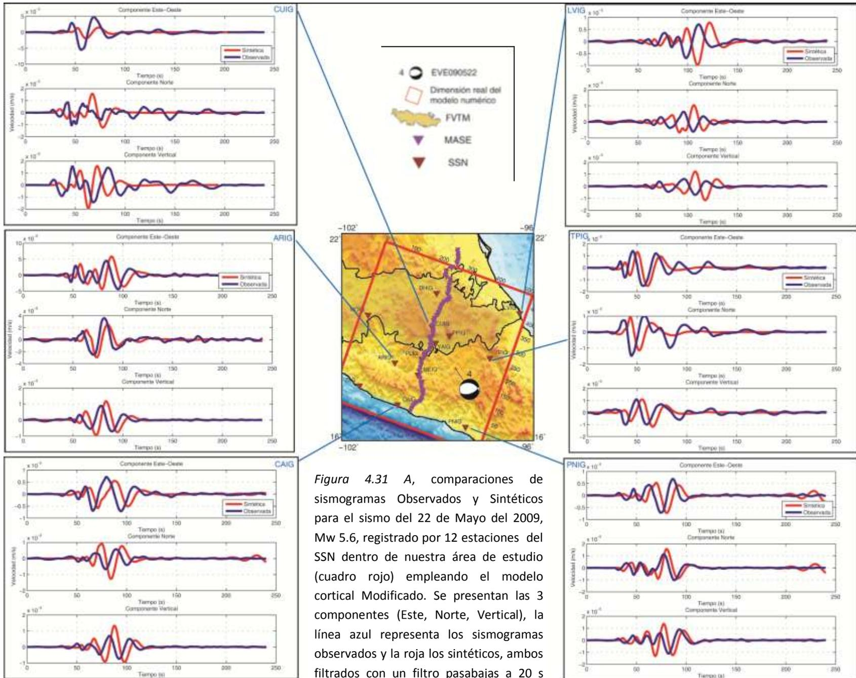
Figura 4.31 A, comparaciones de sismogramas Observados y Sintéticos para el sismo del 22 de Mayo del 2009, Mw 5.6, registrado por 12 estaciones del SSN dentro de nuestra área de estudio (cuadro rojo) empleando el modelo cortical Modificado. Se presentan las 3 componentes (Este, Norte, Vertical), la línea azul representa los sismogramas observados y la roja los sintéticos, ambos filtrados con un filtro pasabajos a 20 s (0.05 Hz). Esta es la sección A con 6
