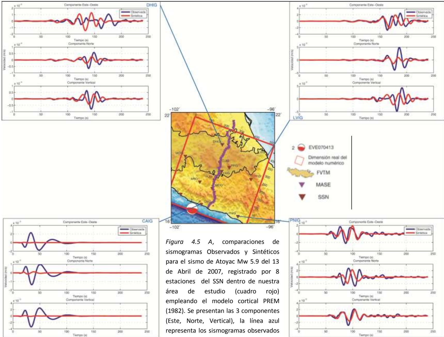
Figura 4.5 A, comparaciones de sismogramas Observados y Sintéticos para el sismo de Atoyac Mw 5.9 del 13 de Abril de 2007, registrado por 8 estaciones del SSN dentro de nuestra área de estudio (cuadro rojo) empleando el modelo cortical PREM (1982). Se presentan las 3 componentes (Este, Norte, Vertical), la línea azul representa los sismogramas observados y la roja los sintéticos, ambos filtrados con un filtro pasabajas a 20 s (0.05 Hz).
