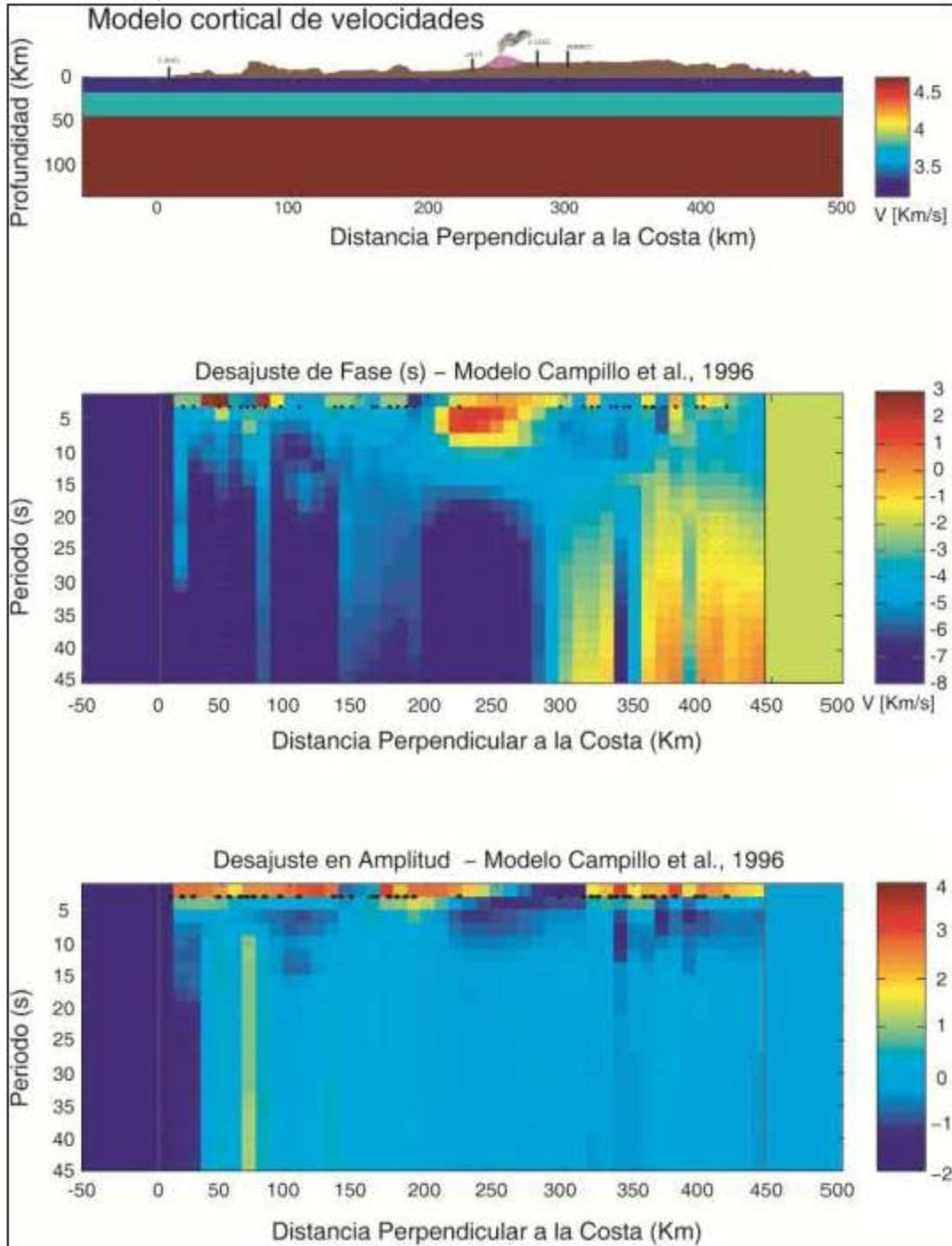
Figura 5.4 Resultados del análisis espectral para el evento 2 EVE070413 en el modelo cortical de velocidades propuesto por Campillo et al., 1996 (Sección 3.4), Modelo cortical de velocidades de ondas S (arriba), desajuste en fase (en medio) y desajuste en amplitud (abajo) para periodos de 2-50 s (0.5-0.02 Hz). Los puntos negros muestran las estaciones usadas en el análisis.
