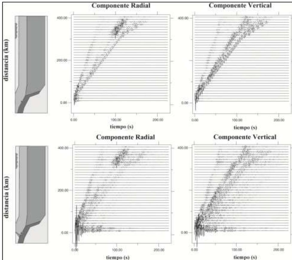
Figura 2.9, Acelerogramas sintéticos para los modelos de la corteza, sin tomar en cuenta el prisma de acreción y el agua (arriba) y tomando en cuenta estas características (abajo), ambos filtrados con un filtro pasabandas entre 0.2 y 0.5 Hz. En ambos modelos utilizaron la posición de la fuente 1 de la Figura 2.6, (tomado y modificado de Shapiro et al., 2002).
