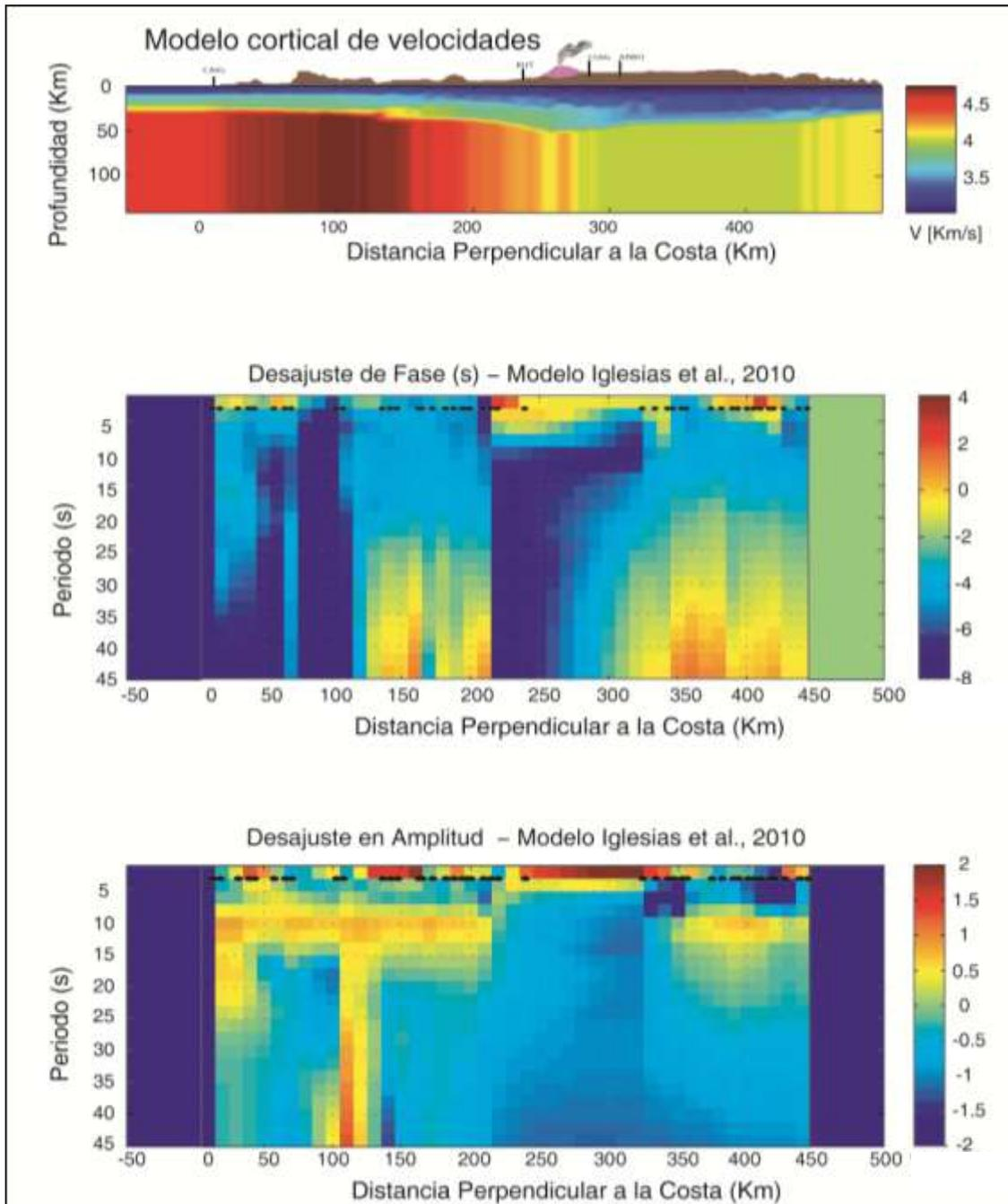
Figura 5.2 Resultados del análisis espectral para el evento 1 EVE050814 en el modelo cortical de velocidades propuesto por Iglesias et al. (2010) (Sección 3.4), Modelo cortical de velocidades de ondas S (arriba), desajuste en fase (en medio) y desajuste en amplitud (abajo) para periodos de 2-50 s (0.5-0.02 Hz). Los puntos negros muestran las estaciones usadas en el análisis.
