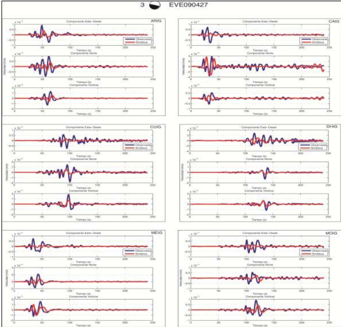
Figura A.21 A, comparaciones de sismogramas Observados y Sintéticos para el sismo del 27 de Abril del 2009, Mw 5.8, registrado por 11 estaciones del SSN dentro de nuestra área de estudio (cuadro rojo) empleando el modelo cortical Iglesias et al., 2010. Se presentan las 3 componentes (Este, Norte, Vertical), la línea azul representa los sismogramas observados y la roja los sintéticos, ambos filtrados con un filtro pasabajas a 10 s (0.1 Hz). Esta es la sección A con 6 estaciones.
