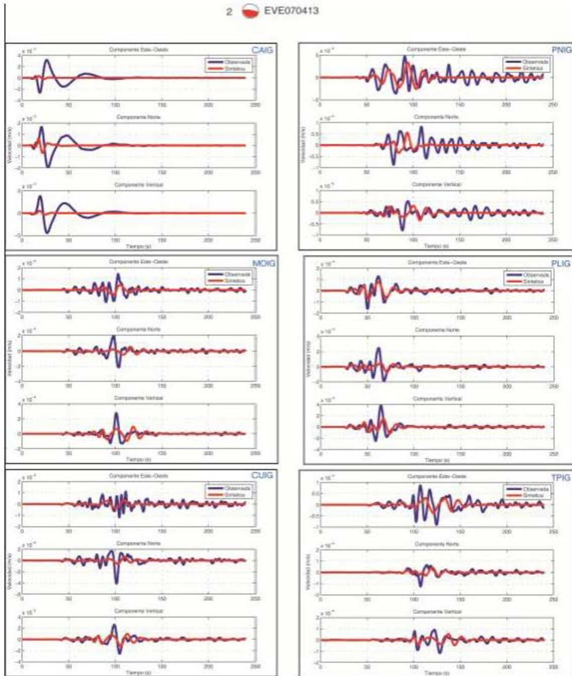
Figura A.3-A, comparaciones de sismogramas Observados y Sintéticos para el sismo de Atoyac Mw 5.9 del 13 de Abril de 2007, registrado por 8 estaciones del SSN dentro de nuestra área de estudio (cuadro rojo) empleando el modelo cortical PREM (1982). Se presentan las 3 componentes (Este, Norte, Vertical), la línea azul representa los sismogramas observados y la roja los sintéticos, ambos filtrados con un filtro pasabajas a 10 s (0.1 Hz). Esta es la sección A con 6 estaciones
