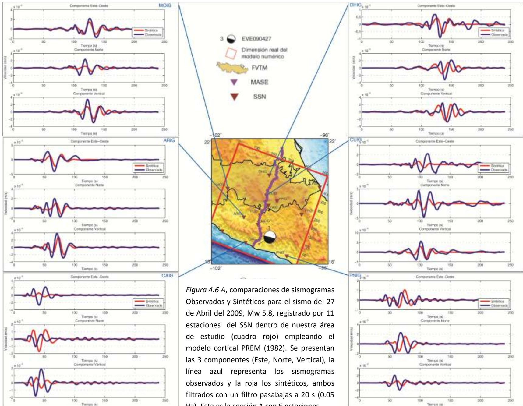
Figura 4.6 A, comparaciones de sismogramas Observados y Sintéticos para el sismo del 27 de Abril del 2009, Mw 5.8, registrado por 11 estaciones del SSN dentro de nuestra área de estudio (cuadro rojo) empleando el modelo cortical PREM (1982). Se presentan las 3 componentes (Este, Norte, Vertical), la línea azul representa los sismogramas observados y la roja los sintéticos, ambos filtrados con un filtro pasabajas a 20 s (0.05 Hz). Esta es la sección A con 6 estaciones.
