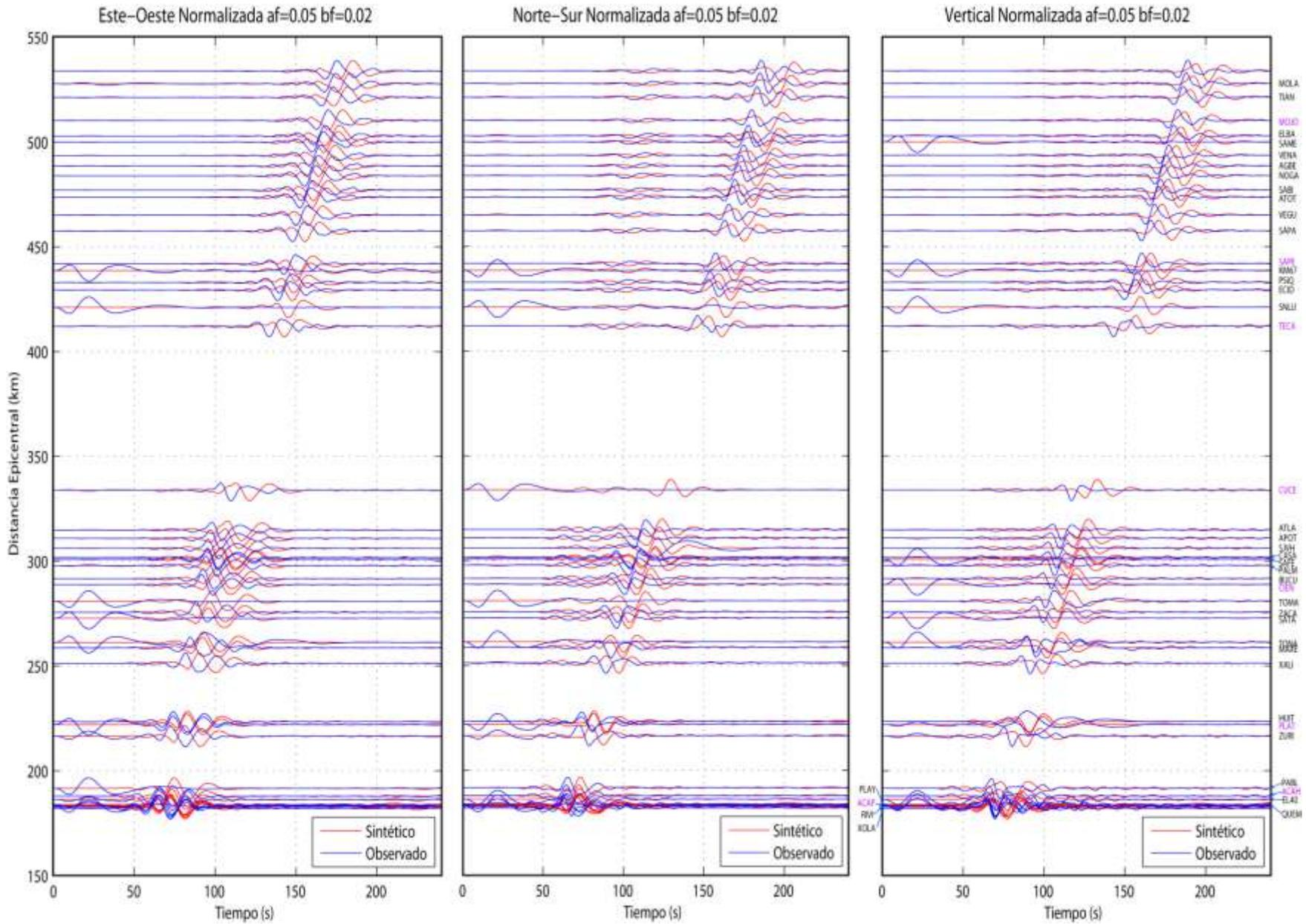
Figura 4.10, Comparaciones de sismogramas Observados y Sintéticos para el sismo del 14 de agosto del 2005 Mw 5.4, empleando el modelo cortical Campillo et al., 1996 a lo largo de 44 estaciones del arreglo MASE. Se presentan las 3 componentes (Este, Norte, Vertical) los sismogramas están ordenados por distancia epicentral a partir de la costa (Acapulco), la línea azul representa los sismogramas observados y la roja los sintéticos, ambos filtrados con un filtro pasabajas a 20 s (0.05 Hz).
