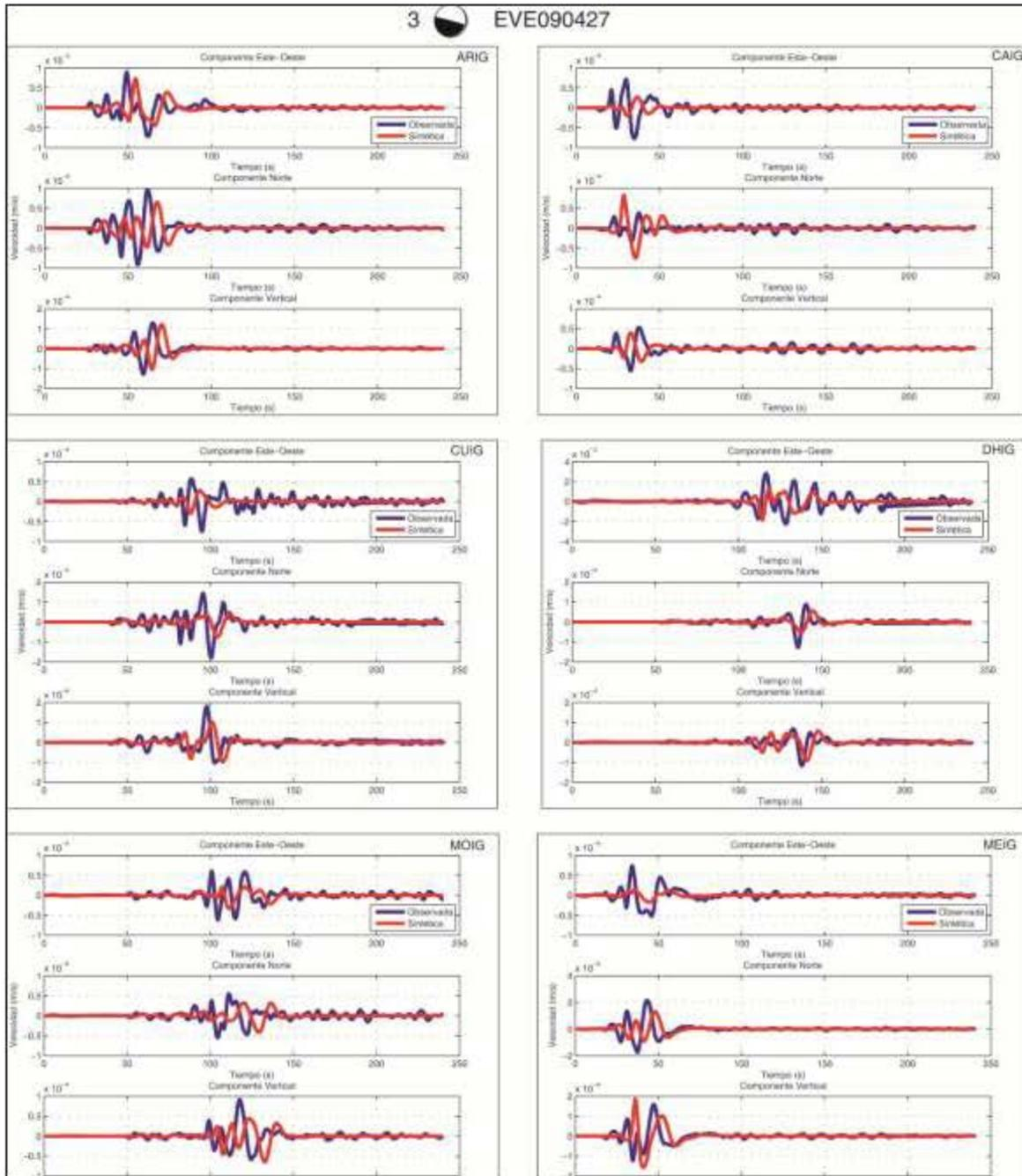
Figura A.13 A, comparaciones de sismogramas Observados y Sintéticos para el sismo del 27 de Abril del 2009, Mw 5.8, registrado por 11 estaciones del SSN dentro de nuestra área de estudio (cuadro rojo) empleando el modelo cortical Campillo et al., 1996. Se presentan las 3 componentes (Este, Norte, Vertical), la línea azul representa los sismogramas observados y la roja los sintéticos, ambos filtrados con un filtro pasabajas a 10 s (0.1 Hz). Esta es la sección A con 6 estaciones.
