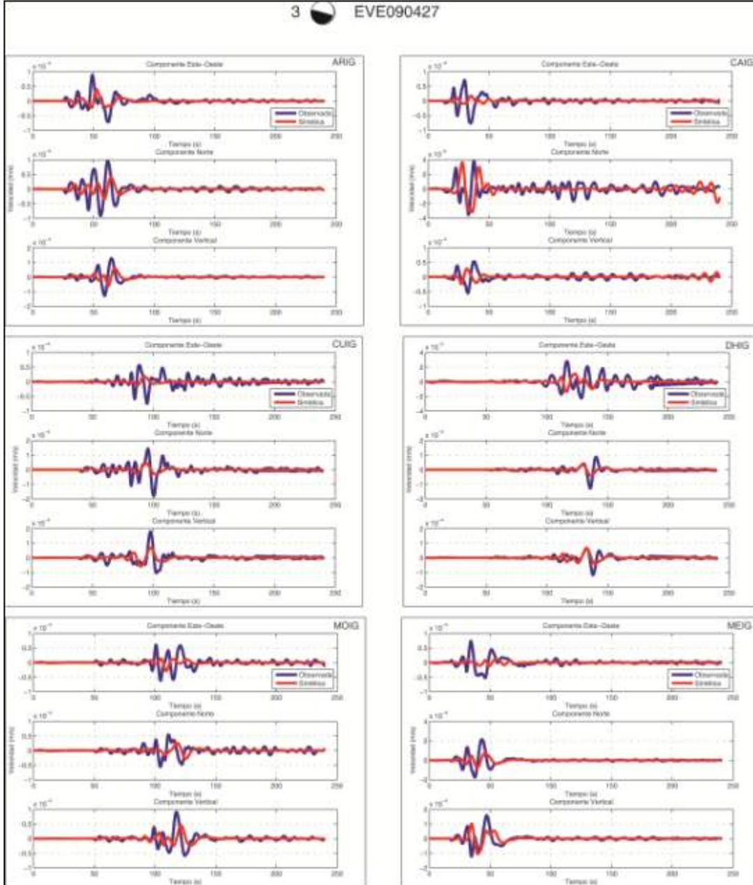
Figura A.26 A, comparaciones de sismogramas Observados y Sintéticos para el sismo del 27 de Abril del 2009, Mw 5.8, registrado por 11 estaciones del SSN dentro de nuestra área de estudio (cuadro rojo) empleando el modelo cortical Modificado. Se presentan las 3 componentes (Este, Norte, Vertical), la línea azul representa los sismogramas observados y la roja los sintéticos, ambos filtrados con un filtro pasabajas a 10 s (0.1 Hz). Esta es la sección A con 6 estaciones.
