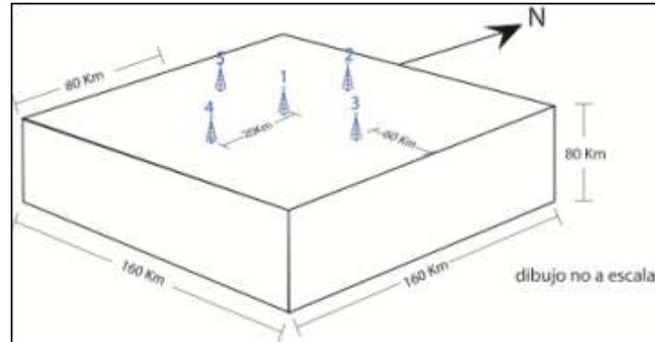
Figura 3.5, Dimensión del modelo numérico en FD y DWN,  $x = 160 \text{ km}$ ,  $y = 160 \text{ km}$ ,  $z = 80 \text{ km}$ ,  $dx = 800 \text{ m}$ ,  $dt = 0.05 \text{ s}$ , con 5 estaciones.
