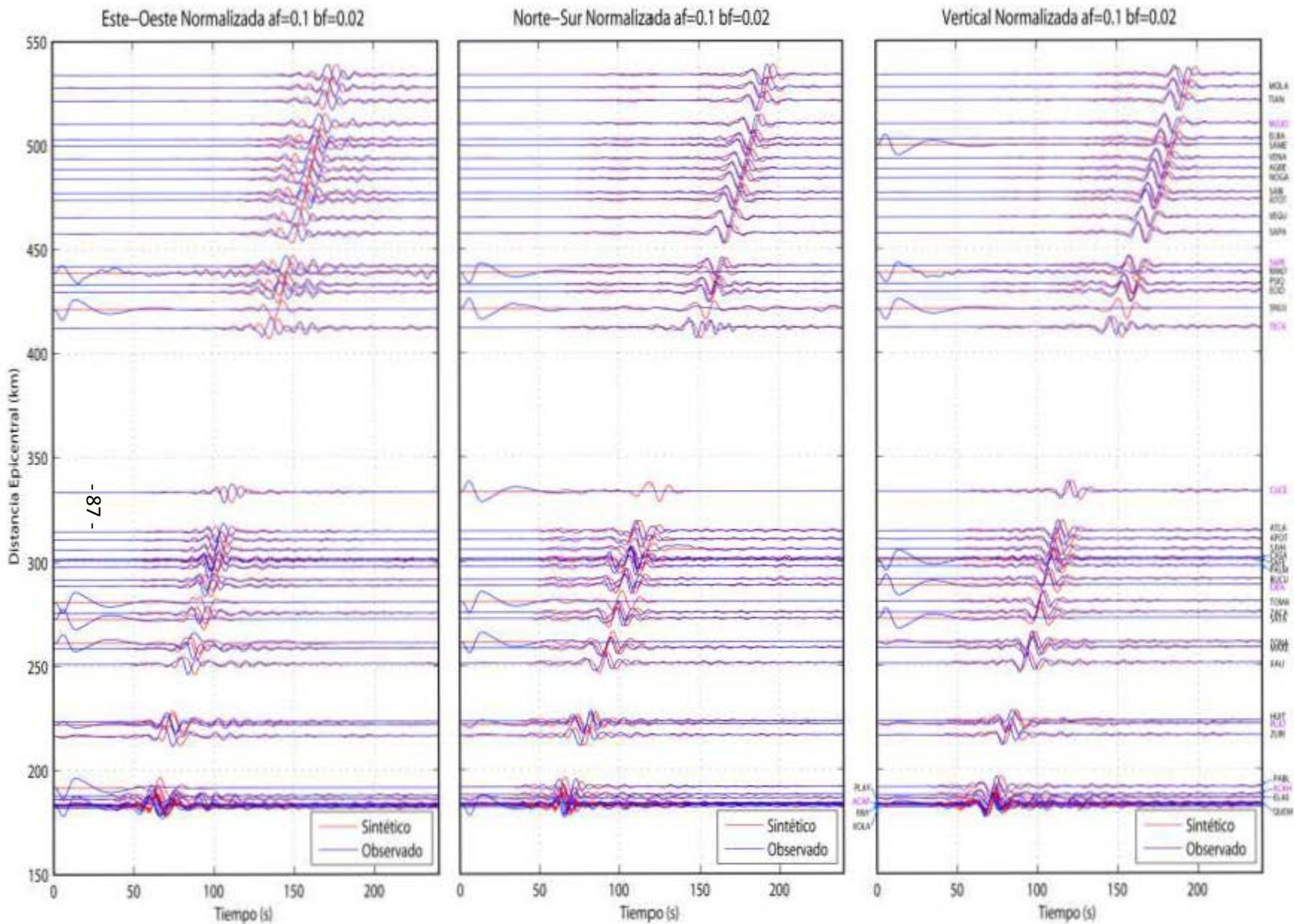
Figura 4.18, Comparaciones de sismogramas Observados y Sintéticos para el sismo del 14 de agosto del 2005 Mw 5.4, empleando el modelo cortical Iglesias et al., 2010 a lo largo de 44 estaciones del arreglo MASE. Se presentan las 3 componentes (Este, Norte, Vertical) los sismogramas están ordenados por distancia epicentral a partir de la costa (Acapulco), la línea azul representa los sismogramas observados y la roja los sintéticos, ambos filtrados con un filtro pasabajas a 10 s (0.1 Hz).
