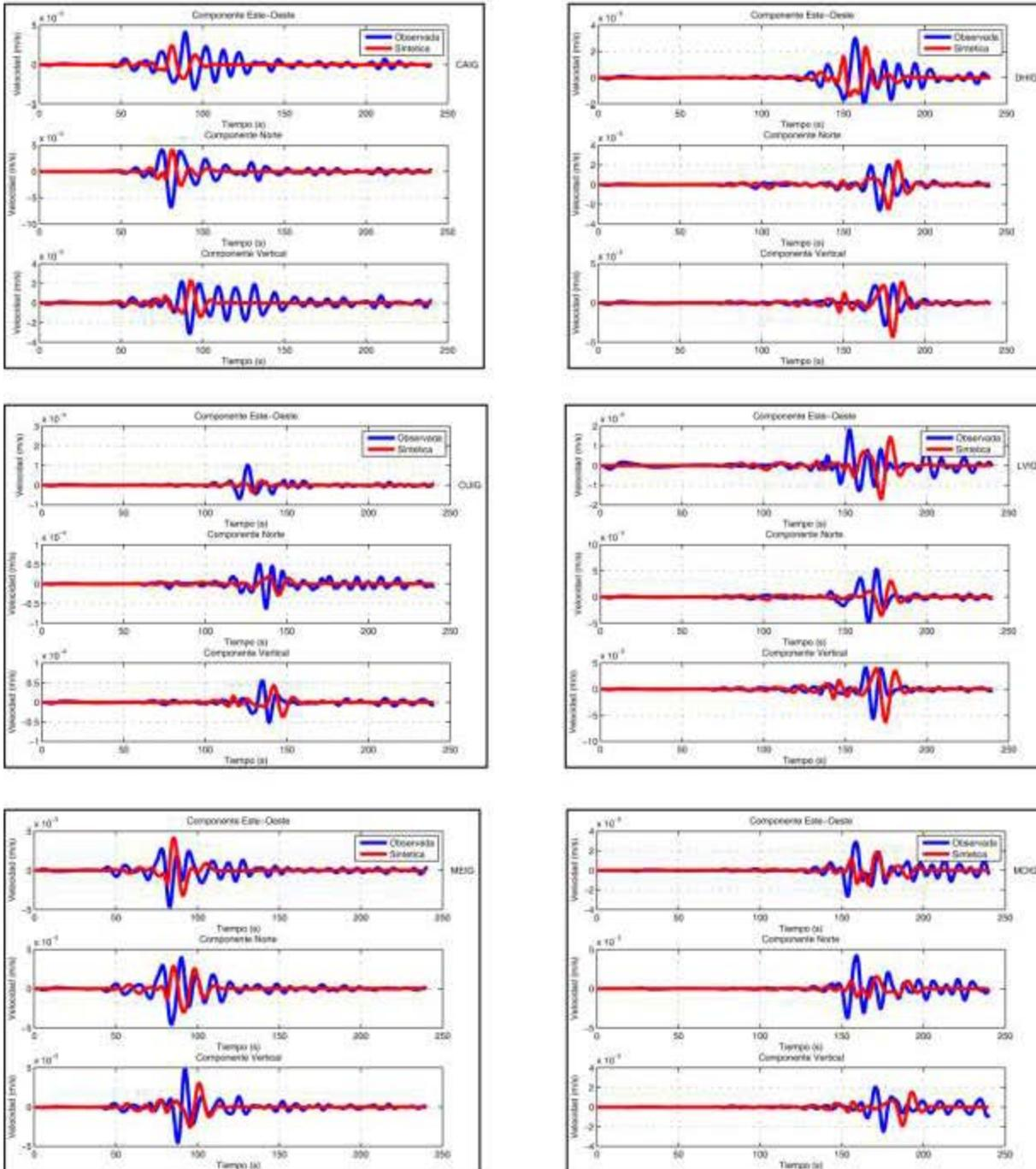
Figura A.9- A, comparaciones de sismogramas Observados y Sintéticos para el sismo del 14 de Agosto del 2005, Mw 5.4, registrado por 9 estaciones del SSN dentro de nuestra área de estudio (cuadro rojo) empleando el modelo cortical Campillo et al., 1996. Se presentan las 3 componentes (Este, Norte, Vertical), la línea azul representa los sismogramas observados y la roja los sintéticos, ambos filtrados con un filtro pasabajos a 10 s (0.1 Hz). Esta es la sección A con 6 estaciones.
