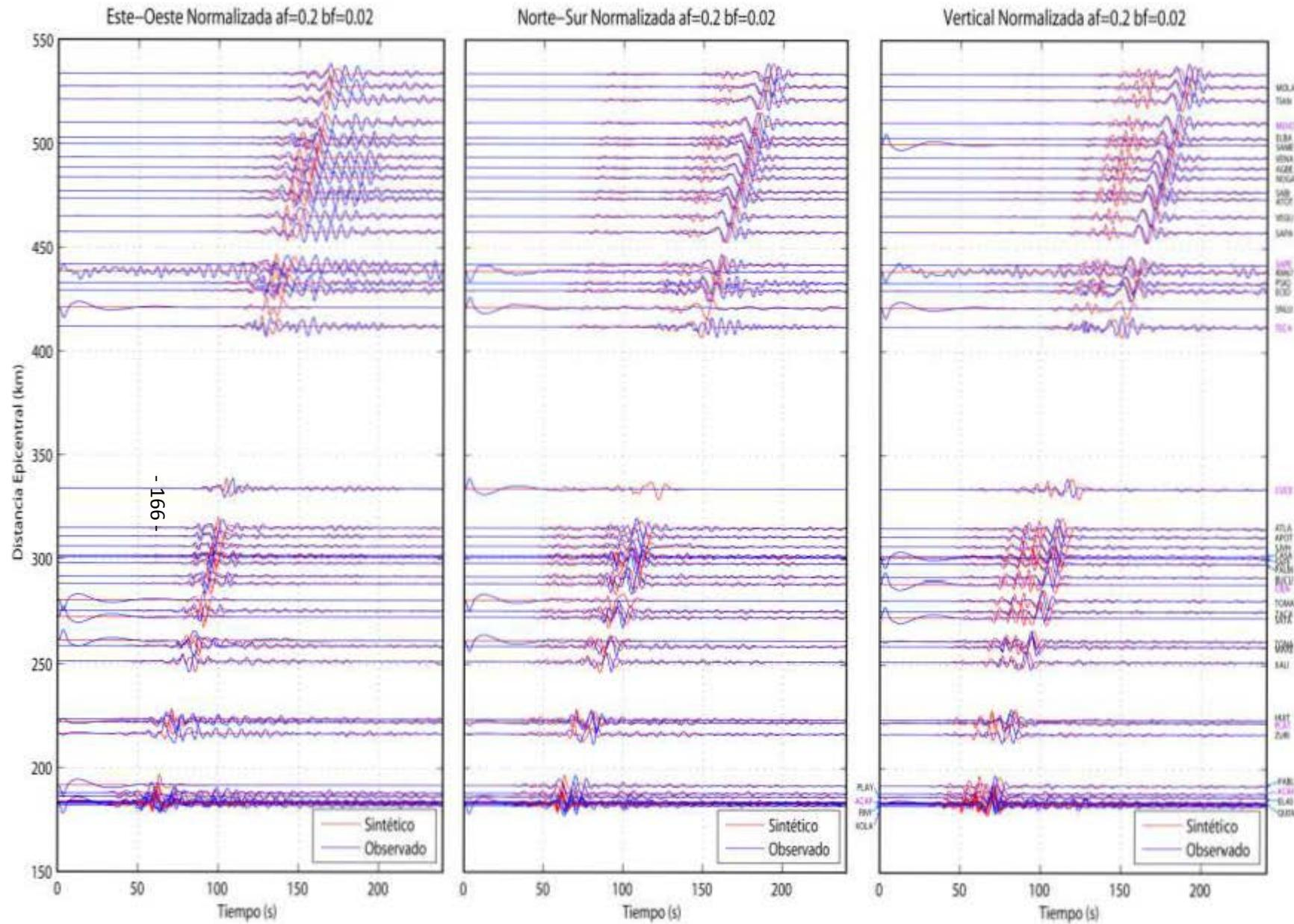
Figura A.16, Comparaciones de sismogramas Observados y Sintéticos para el sismo del 14 de agosto del 2005 Mw 5.4, empleando el modelo cortical Iglesias et al., 2010 a lo largo de 44 estaciones del arreglo MASE. Se presentan las 3 componentes (Este, Norte, Vertical) los sismogramas están ordenados por distancia epicentral a partir de la costa (Acapulco), la línea azul representa los sismogramas observados y la roja los sintéticos, ambos filtrados con un filtro pasabajas a 5 s (0.2 Hz).
