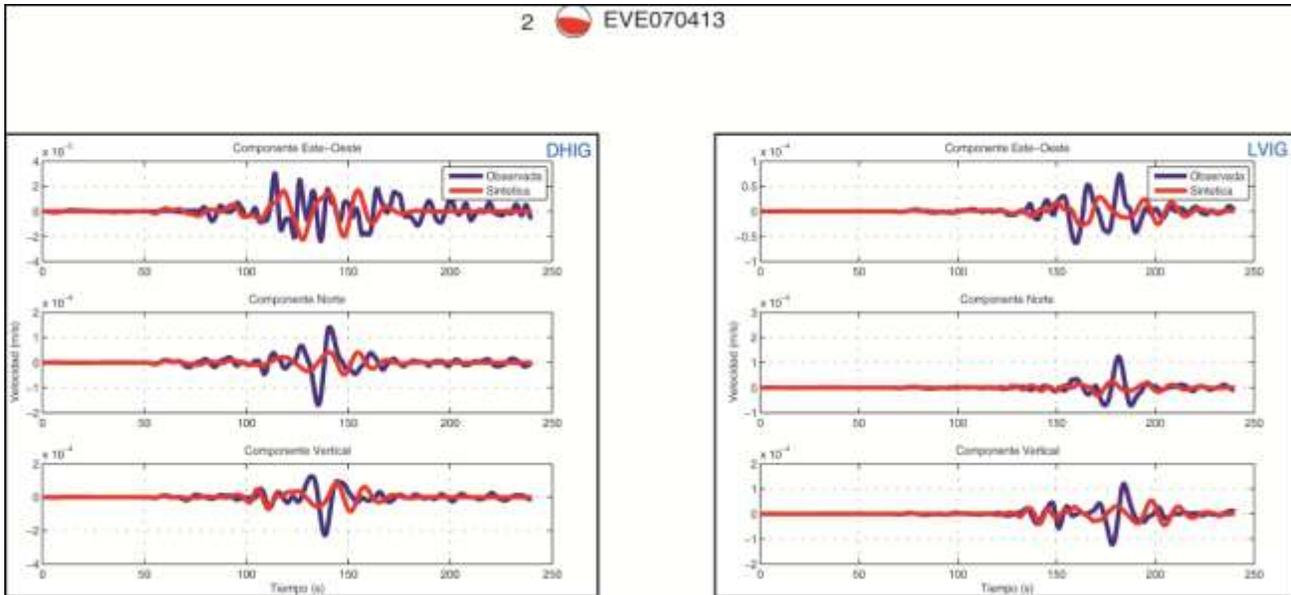
Figura A.3-B, comparaciones de sismogramas Observados y Sintéticos para el sismo de Atoyac Mw 5.9 del 13 de Abril de 2007, registrado por 8 estaciones del SSN dentro de nuestra área de estudio (cuadro rojo) empleando el modelo cortical PREM (1982). Se presentan las 3 componentes (Este, Norte, Vertical), la línea azul representa los sismogramas observados y la roja los sintéticos, ambos filtrados con un filtro pasabajas a 10 s (0.1 Hz). Esta es la sección B con 2 estaciones
