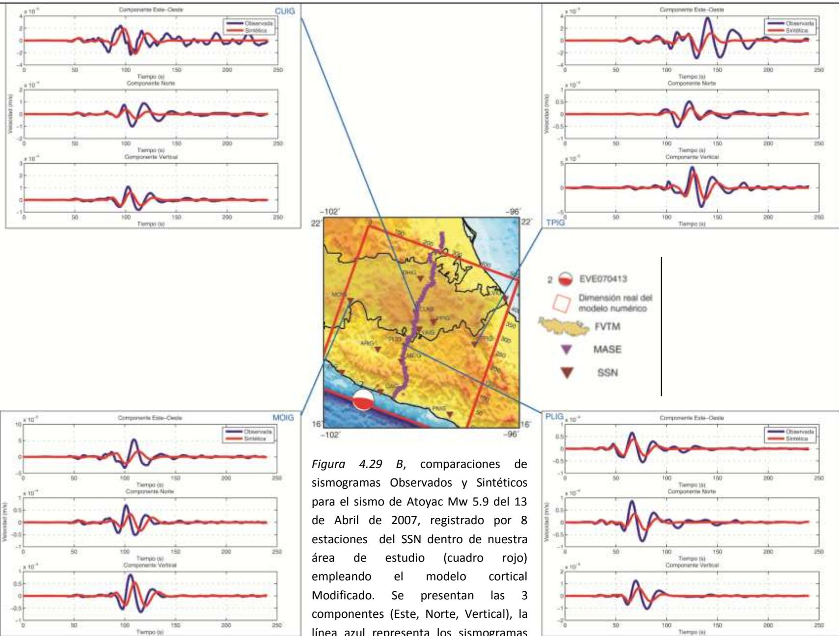
Figura 4.29 B, comparaciones de sismogramas Observados y Sintéticos para el sismo de Atoyac Mw 5.9 del 13 de Abril de 2007, registrado por 8 estaciones del SSN dentro de nuestra área de estudio (cuadro rojo) empleando el modelo cortical Modificado. Se presentan las 3 componentes (Este, Norte, Vertical), la línea azul representa los sismogramas observados y la roja los sintéticos, ambos filtrados con un filtro pasabajas a
