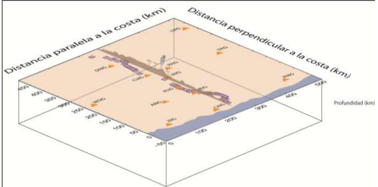
Figura 3.3, Dimensiones del modelo 3D utilizado en este trabajo para realizar las simulaciones numéricas, con una dimensión paralela a la costa de 519 km, una perpendicular a la costa de 490 km y la dimensión en profundidad del modelo numérico de 140 km. Se muestra también la localización regional del arreglo de estaciones usado para evaluar la estructura regional. Estaciones del Servicio Sismológico Nacional (parda) y del proyecto MASE (morado).
