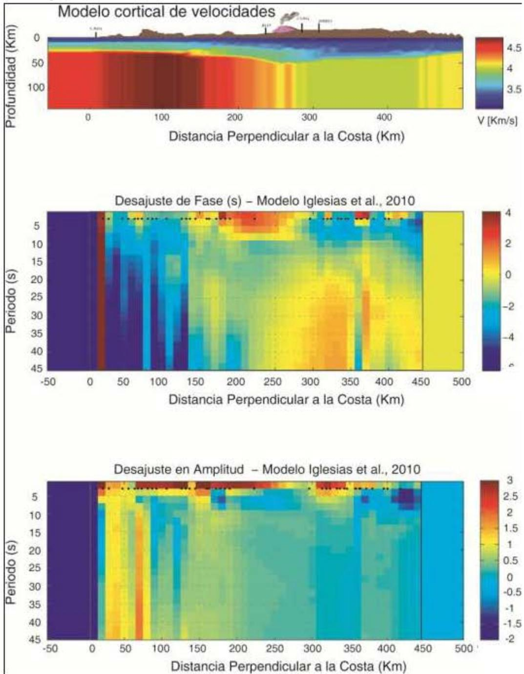
Figura 5.5 Resultados del análisis espectral para el evento 2 EVE070413 en el modelo cortical de velocidades propuesto por Modelo Iglesias et al., 2010 (Sección 3.4), Modelo cortical de velocidades de ondas S (arriba), desajuste en fase (en medio) y desajuste en amplitud (abajo) para periodos de 2-50 s (0.5-0.02 Hz). Los puntos negros muestran las estaciones usadas en el análisis.
