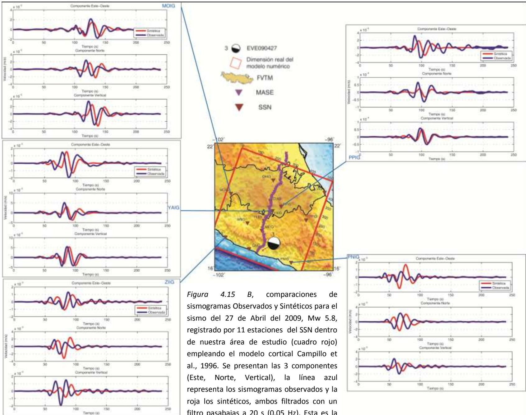
Figura 4.15 B, comparaciones de sismogramas Observados y Sintéticos para el sismo del 27 de Abril del 2009, Mw 5.8, registrado por 11 estaciones del SSN dentro de nuestra área de estudio (cuadro rojo) empleando el modelo cortical Campillo et al., 1996. Se presentan las 3 componentes (Este, Norte, Vertical), la línea azul representa los sismogramas observados y la roja los sintéticos, ambos filtrados con un filtro pasabajas a 20 s (0.05 Hz). Esta es la
