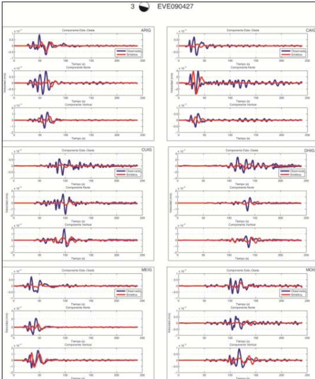
Figura A.4 A, comparaciones de sismogramas Observados y Sintéticos para el sismo del 27 de Abril del 2009, Mw 5.8, registrado por 11 estaciones del SSN dentro de nuestra área de estudio (cuadro rojo) empleando el modelo cortical PREM (1982). Se presentan las 3 componentes (Este, Norte, Vertical), la línea azul representa los sismogramas observados y la roja los sintéticos, ambos filtrados con un filtro pasabajos a 10 s (0.1 Hz). Esta es la sección A con 6 estaciones.
