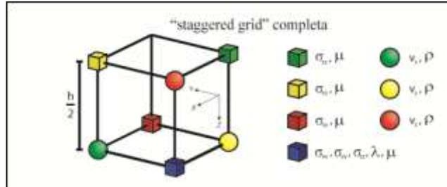
Figura 3.2, Malla intercalada en 3D "staggered-grid", tensor de esfuerzos denotado con  $\sigma$ ,  $\lambda$  y  $\mu$  son los coeficientes de Lamé y  $\rho$ , la densidad, las componentes de velocidad y esfuerzos, deben de estar especificadas para las diferentes posiciones dentro de la rejilla. (tomado de Cruz-Atienza, 2006, página 54).
