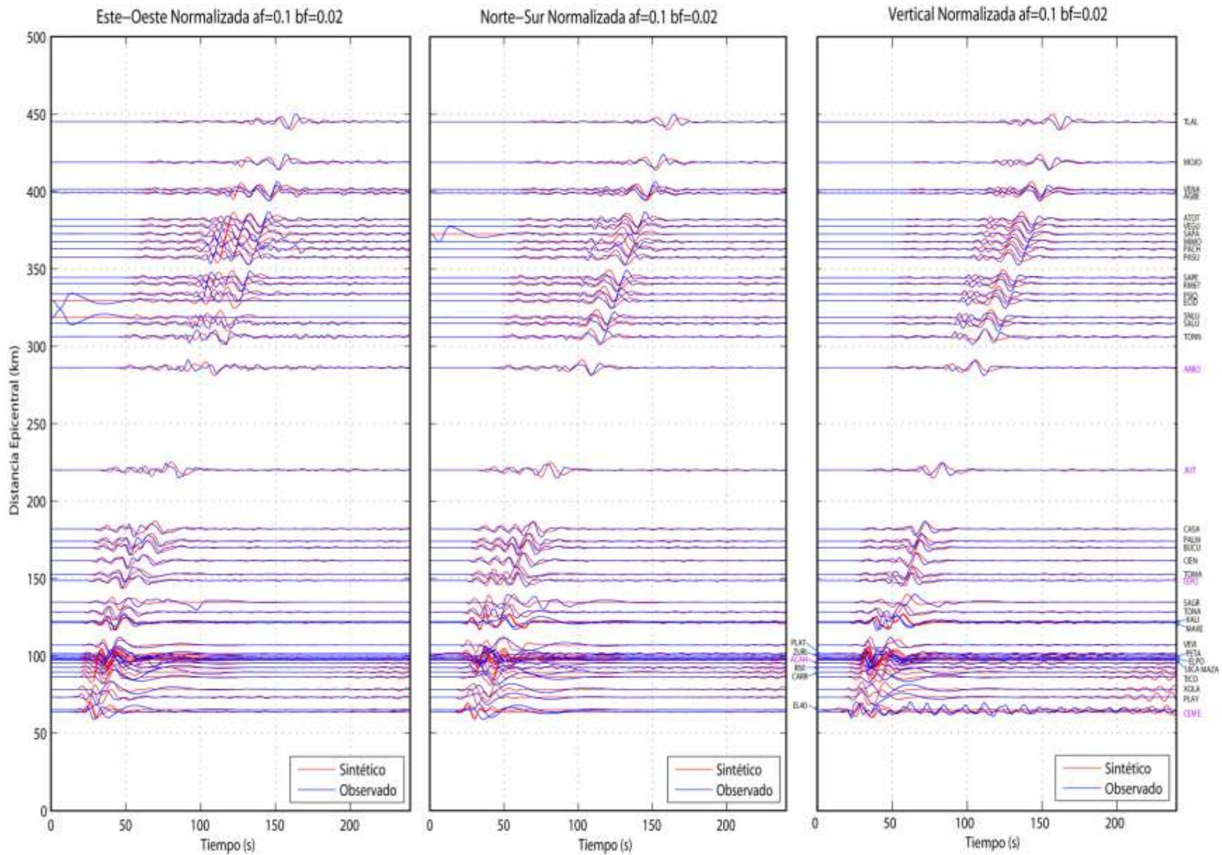
Figura 4.27, Comparaciones de sismogramas Observados y Sintéticos para el sismo de Atoyac del 13 de abril del 2007, Mw 5.9, empleando el modelo Modificado a lo largo de 45 estaciones del arreglo MASE. Se presentan las 3 componentes (Este, Norte, Vertical) los sismogramas están ordenados por distancia epicentral a partir de la costa (Acapulco), la línea azul representa los sismogramas observados y la roja los sintéticos, ambos filtrados con un filtro pasabajas a 10 s (0.1 Hz).
