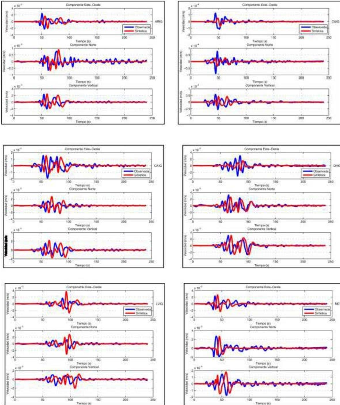
Figura A.14 A, comparaciones de sismogramas Observados y Sintéticos para el sismo del 22 de Mayo del 2009, Mw 5.6, registrado por 12 estaciones del SSN dentro de nuestra área de estudio (cuadro rojo) empleando el modelo cortical Campillo et al., 1996. Se presentan [Fig. 163](#) componentes (Este, Norte, Vertical), la línea azul representa los sismogramas observados y la roja los sintéticos, ambos filtrados con un filtro pasabajas a 10 s (0.1 Hz). Esta es la sección A con 6 estaciones.
