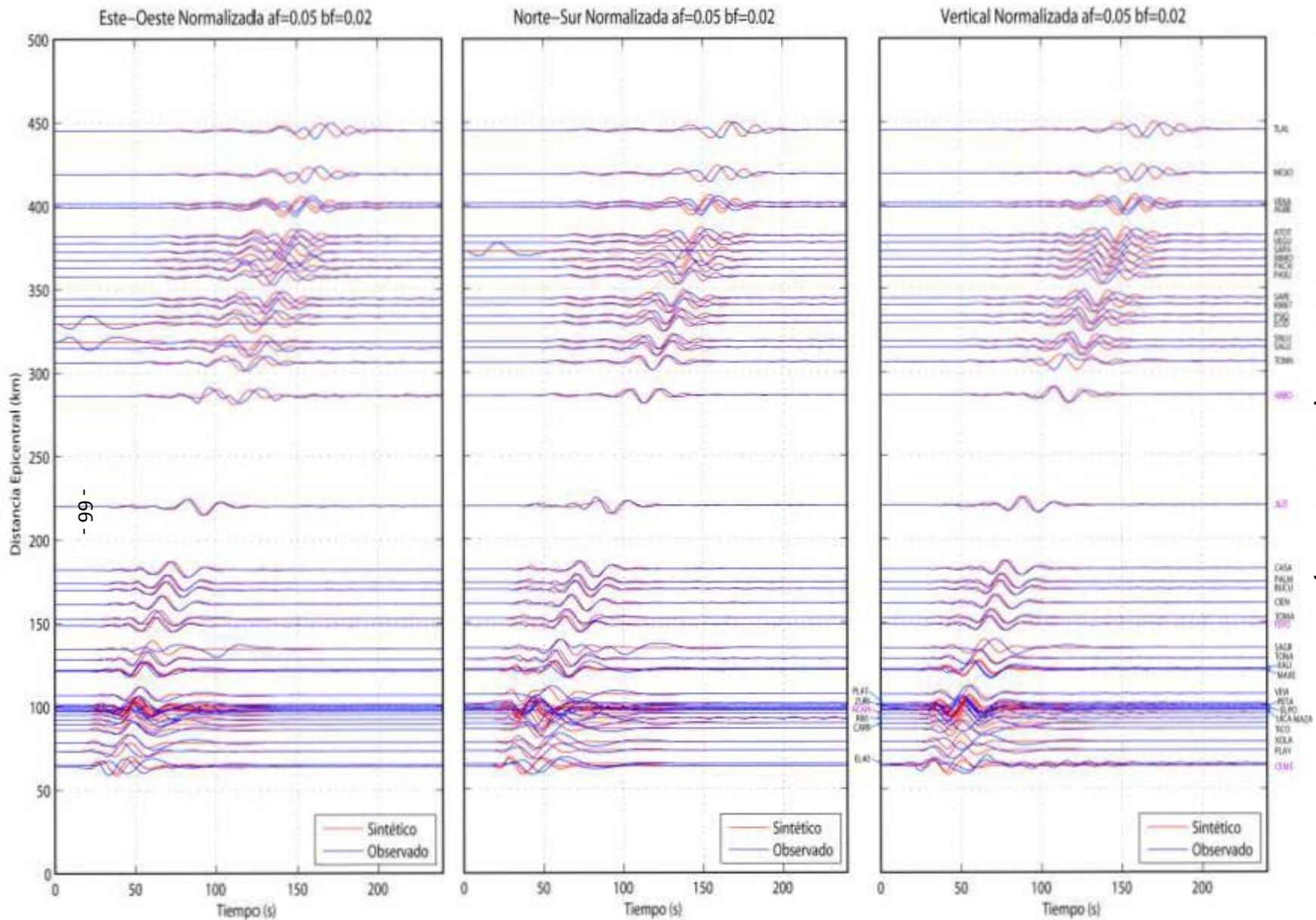
Figura 4.4, Comparaciones de sismogramas Observados y Sintéticos para el sismo de Atoyac Mw 5.9 del 13 de Abril de 2007 empleando el modelo cortical PREM (1982) a lo largo de 45 estaciones del arreglo MASE. Se presentan las 3 componentes (Este, Norte, Vertical) los sismogramas están ordenados por distancia epicentral a partir de la costa (Acapulco), la línea azul representa los sismogramas observados y la roja los sintéticos, ambos filtrados con un filtro pasabajas a 20 s (0.05 Hz).
