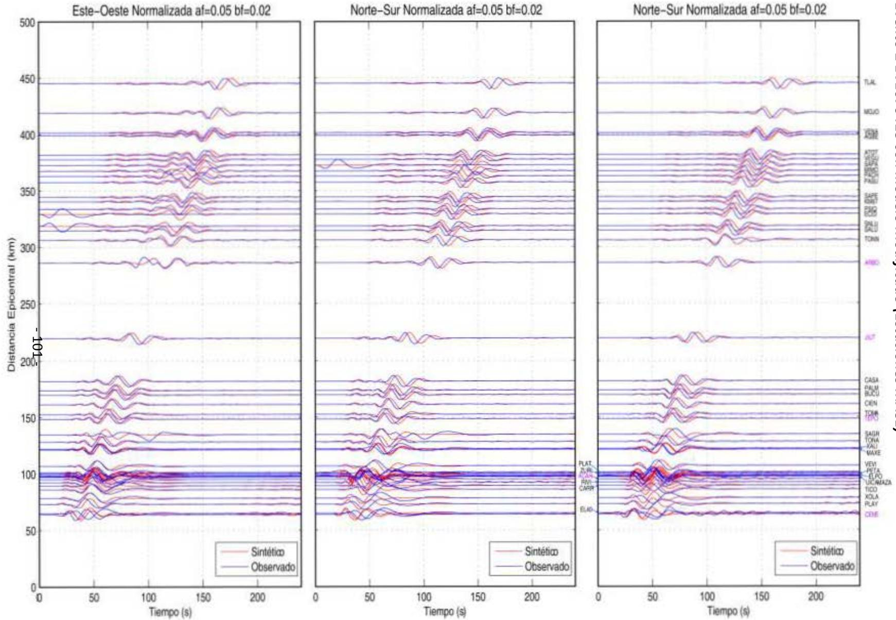
Figura 4.28, Comparaciones de sismogramas Observados y Sintéticos para el sismo de Atoyac del 13 de abril del 2007, Mw 5.9, empleando el modelo Modificado a lo largo de 45 estaciones del arreglo MASE. Se presentan las 3 componentes (Este, Norte, Vertical) los sismogramas están ordenados por distancia epicentral a partir de la costa (Acapulco), la línea azul representa los sismogramas observados y la roja los sintéticos, ambos filtrados con un filtro pasabajas a 20 s (0.05 Hz).
