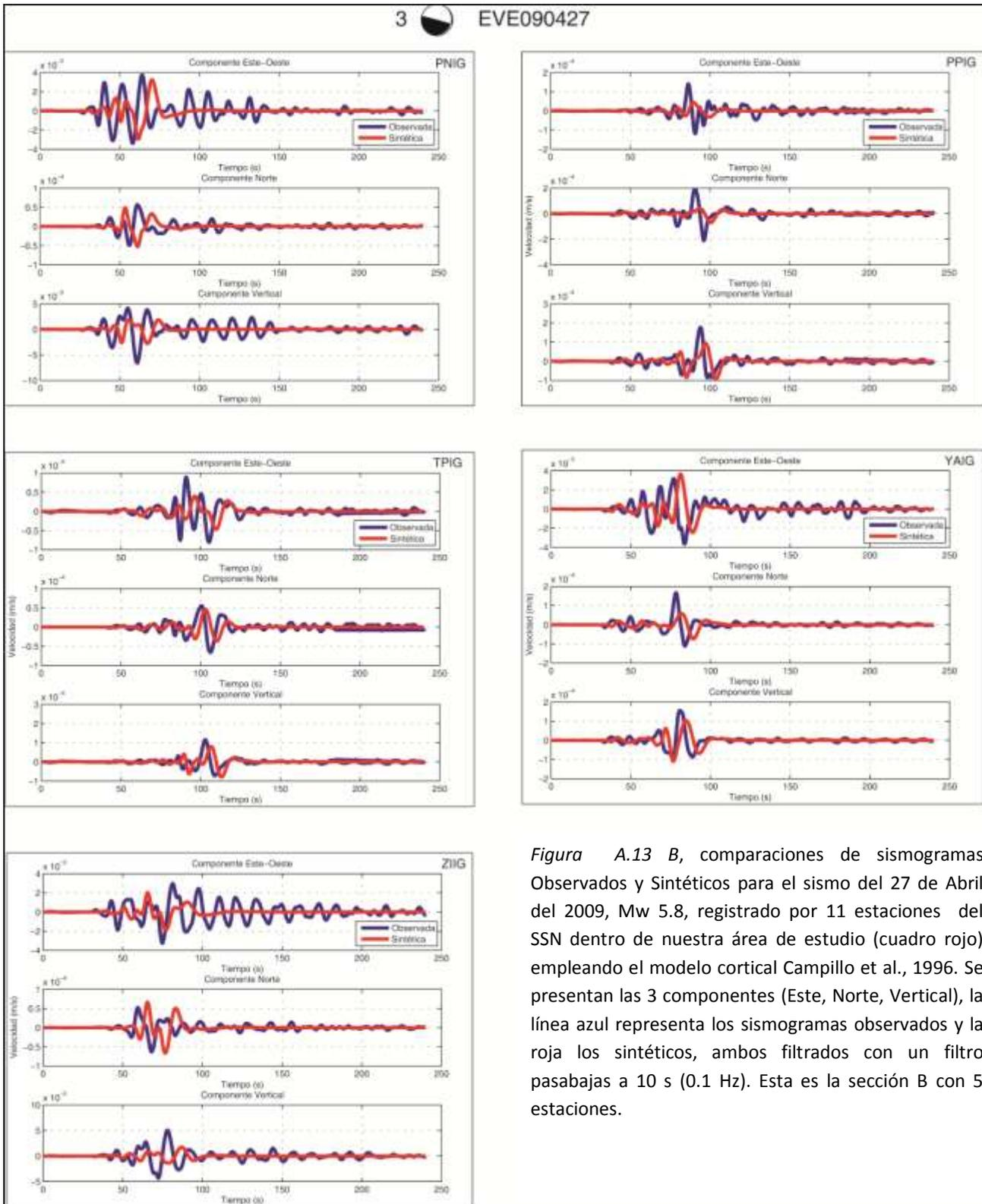
*Figura A.13 B*, comparaciones de sismogramas Observados y Sintéticos para el sismo del 27 de Abril del 2009, Mw 5.8, registrado por 11 estaciones del SSN dentro de nuestra área de estudio (cuadro rojo) empleando el modelo cortical Campillo et al., 1996. Se presentan las 3 componentes (Este, Norte, Vertical), la línea azul representa los sismogramas observados y la roja los sintéticos, ambos filtrados con un filtro pasabajas a 10 s (0.1 Hz). Esta es la sección B con 5 estaciones.
