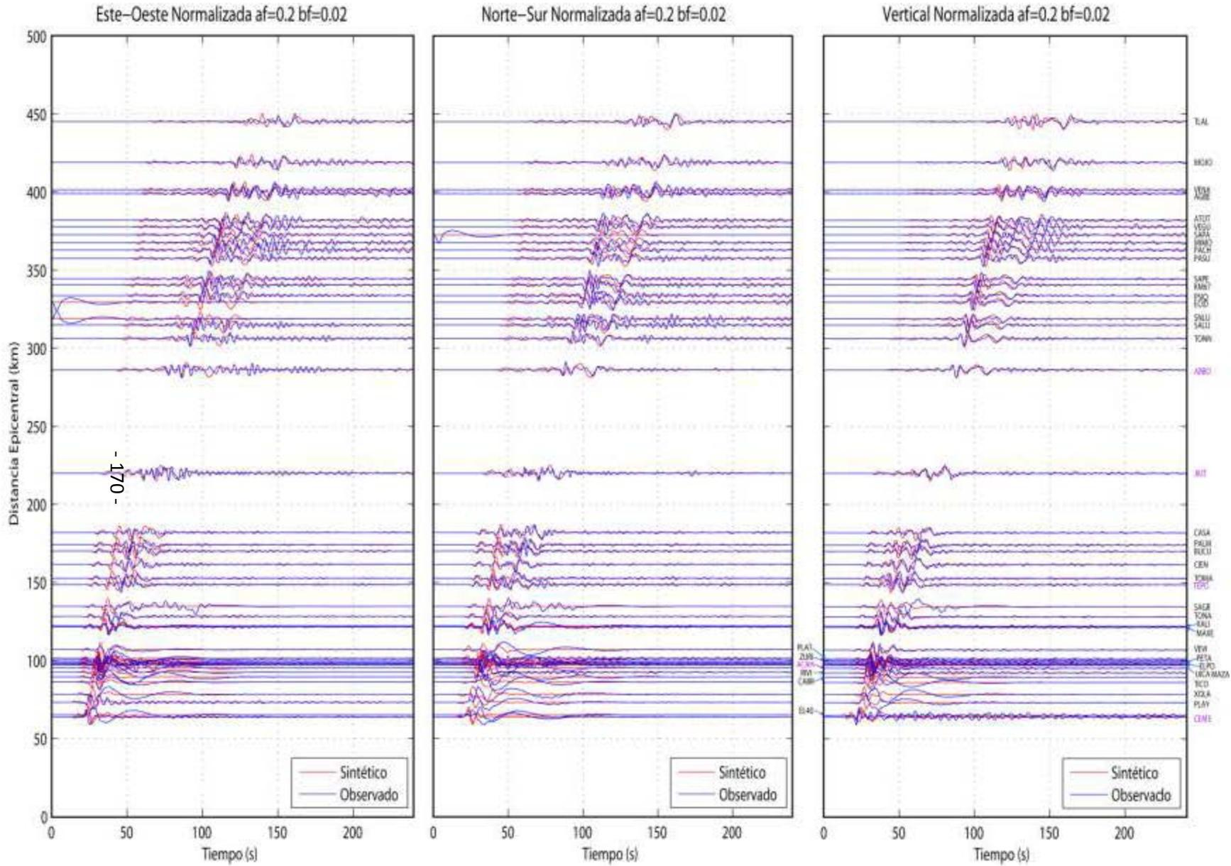
Figura A-19, Comparaciones de sismogramas Observados y Sintéticos para el sismo de Atoyac del 13 de abril del 2007, Mw 5.9, empleando el modelo cortical Iglesias et al., 2010 a lo largo de 45 estaciones del arreglo MASE. Se presentan las 3 componentes (Este, Norte, Vertical) los sismogramas están ordenados por distancia epicentral a partir de la costa (Acapulco), la línea azul representa los sismogramas observados y la roja los sintéticos, ambos filtrados con un filtro pasabajos a 5 s (0.2 Hz).
