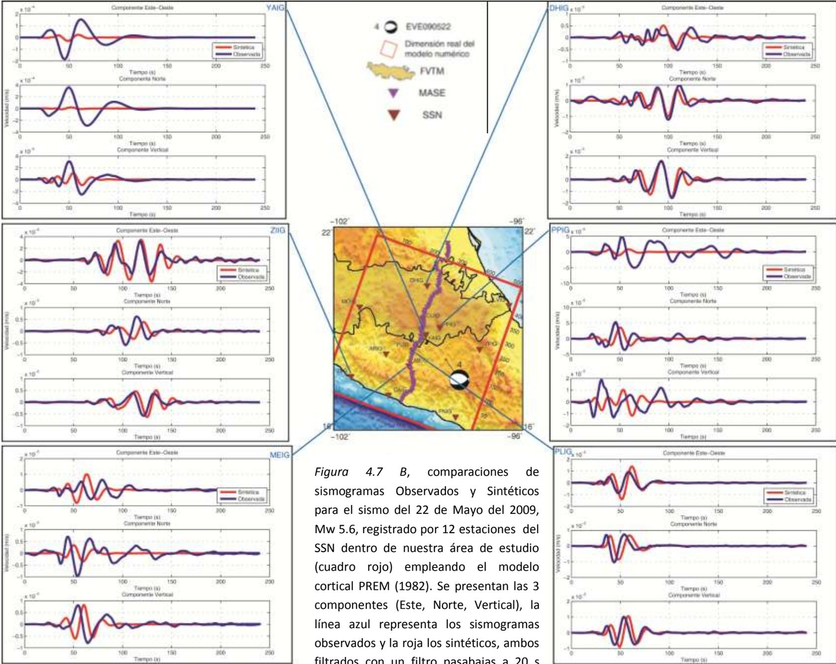
Figura 4.7 B, comparaciones de sismogramas Observados y Sintéticos para el sismo del 22 de Mayo del 2009, Mw 5.6, registrado por 12 estaciones del SSN dentro de nuestra área de estudio (cuadro rojo) empleando el modelo cortical PREM (1982). Se presentan las 3 componentes (Este, Norte, Vertical), la línea azul representa los sismogramas observados y la roja los sintéticos, ambos filtrados con un filtro pasabajas a 20 s (0.05 Hz). Este es la sección B con 6
