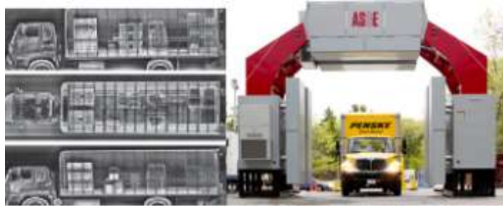
Figura 6.10.3 scanner rayos-x para vehículos “z- Granty”
