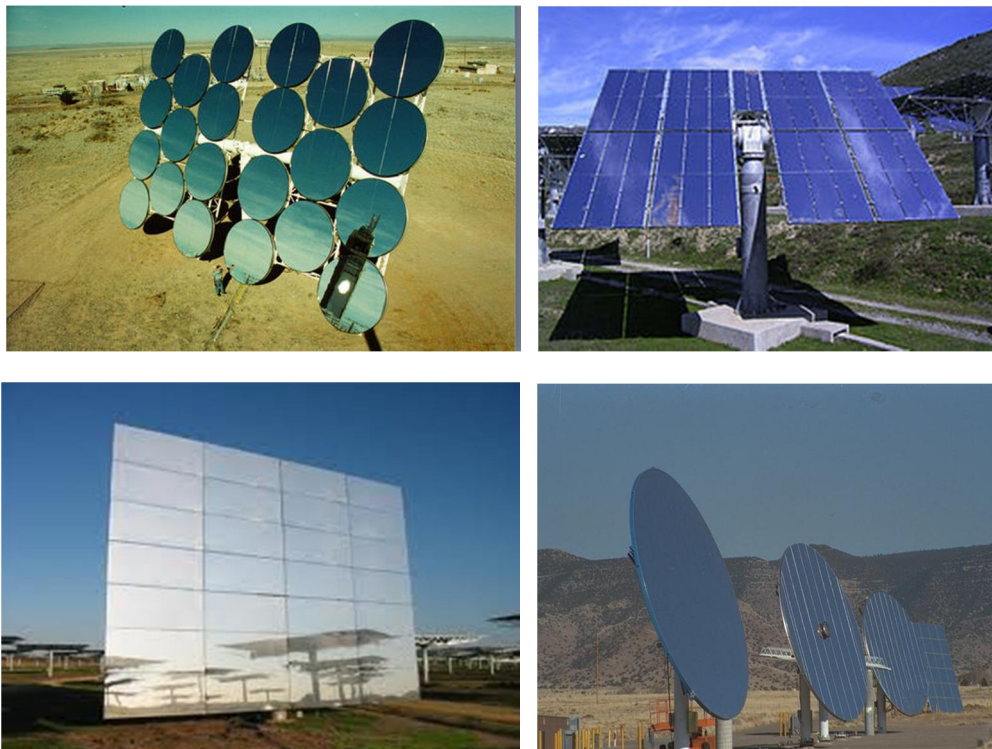
Figura 2.4. Algunos tipos de heliostatos. Helióstatos de facetas circulares cóncavas (superior izquierda), Helióstatos de Herradura (superior derecha), Helióstatos plano de múltiples facetas (inferior izquierda) y Helióstatos de membrana estrecha (inferior derecha).
