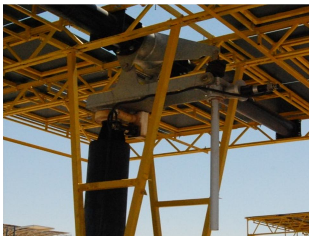
Figura 4.6. Conjunto Mecánico y ejes de giro
