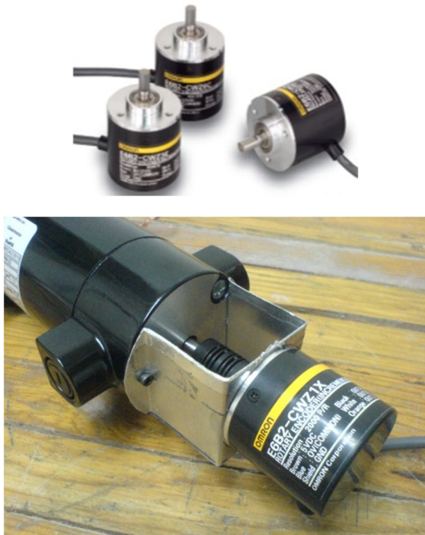
Figura 4.10. Sensor OMRON (arriba) y el mismo montado en la salida de la flecha posterior de un motor (abajo)
