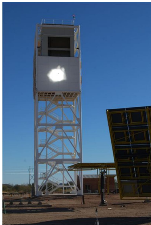
Figura 1.20. Torre Central y blanco de pruebas ópticas
