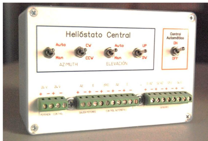
Figura 4.14. Caja de control manual
