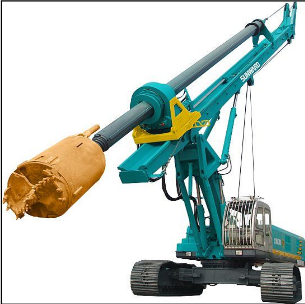
FIGUR0A I.15 PERFORADORA ROTATIVA.
