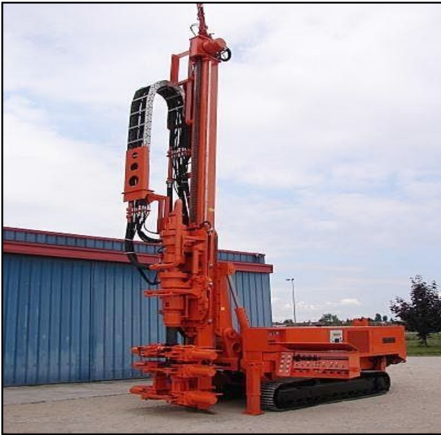
FIGUR0A I.17 PERFORADORA A MARTILLO.
