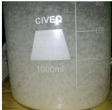
Figura 21. Purga de torre de enfriamiento, al agregar Na_2CO_3 de manera estequiométrica, como etapa previa al proceso de electrocoagulación
