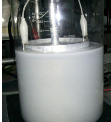
Figura 23. Reactor electroquímico batch, con ablandamiento químico ( \text{Na}_2\text{CO}_3 ) como etapa previa
