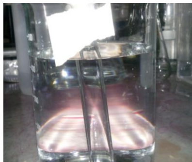
Figura 24. Purga de torre de enfriamiento, después del tratamiento, de ablandamiento químico, seguido de un proceso de electrocoagulación
