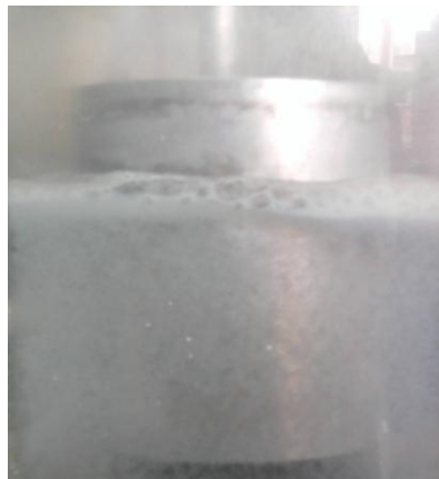
Figura 19. Reactor con electrodo rotatorio, Formación del coagulante
