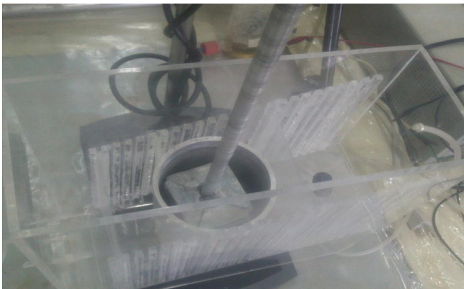
Figura 17. Vista Superior del reactor electroquímico para régimen continuo
