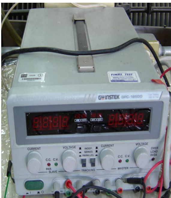
Figura 33. Fuente de poder GW INSTEK modelo GPC-1850 D
