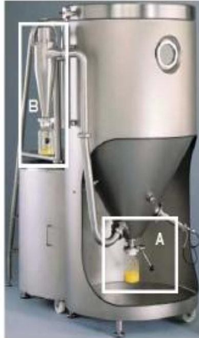
Figura 6. Recuperación del producto (GEA Process Engineering, 2008). A) Separación primaria, B) Separación secundaria
