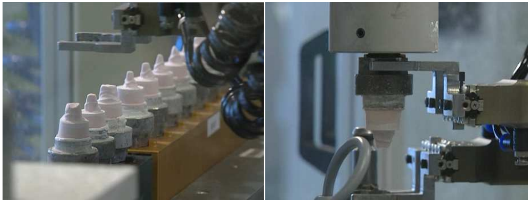
Fig. 105 Los troqueles son separados y llevados para la construcción de la cofia de alúmina.
