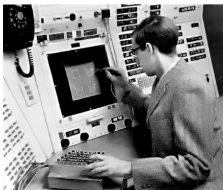
Fig. 2 Ivan Sutherland usando Sketchpad en el MIT TX-2 computer system.
