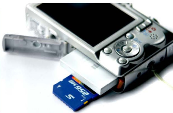
Fotografía: Pantalla LCD de la cámara, tarjeta de memoria y batería. Fuente: Internet
