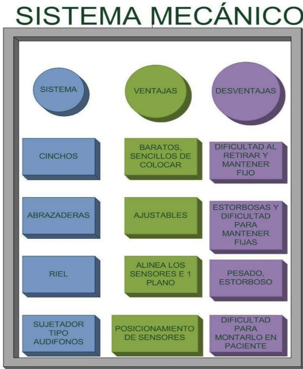
Fig. 2.7.- Análisis sistema mecánico
