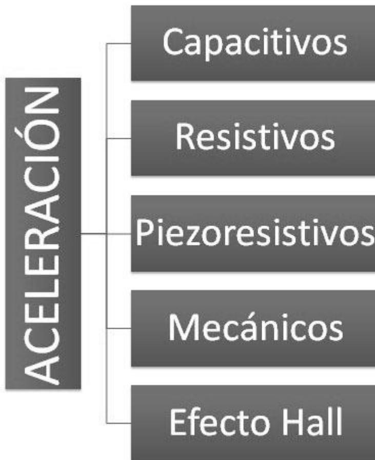
*Fig. 2.12.- Clasificación de acelerómetros*
