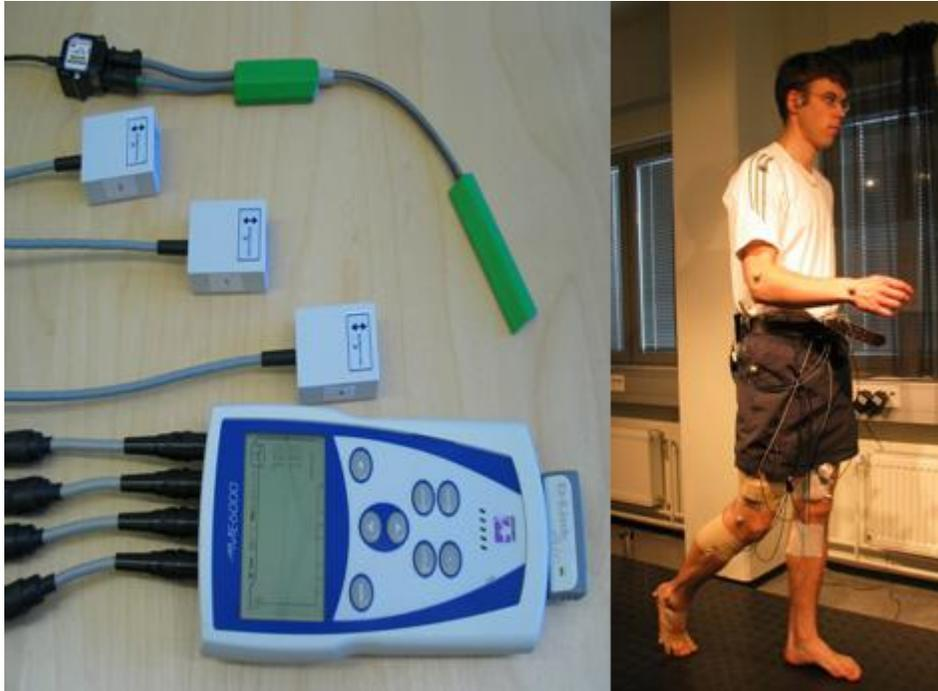
*Fig. 1.19.- Uso de acelerómetros en el análisis de la marcha humana*
