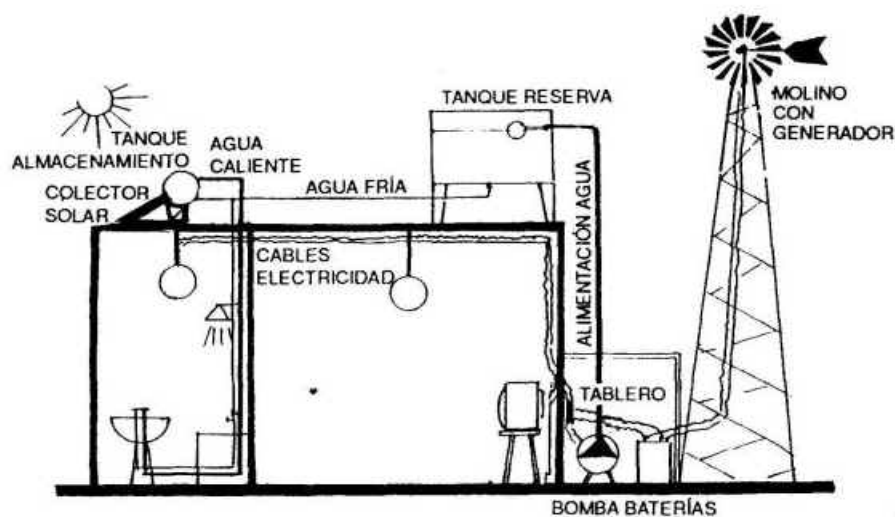
Fig. 2.5 Detalle esquemático del uso múltiple de la energía eólica
