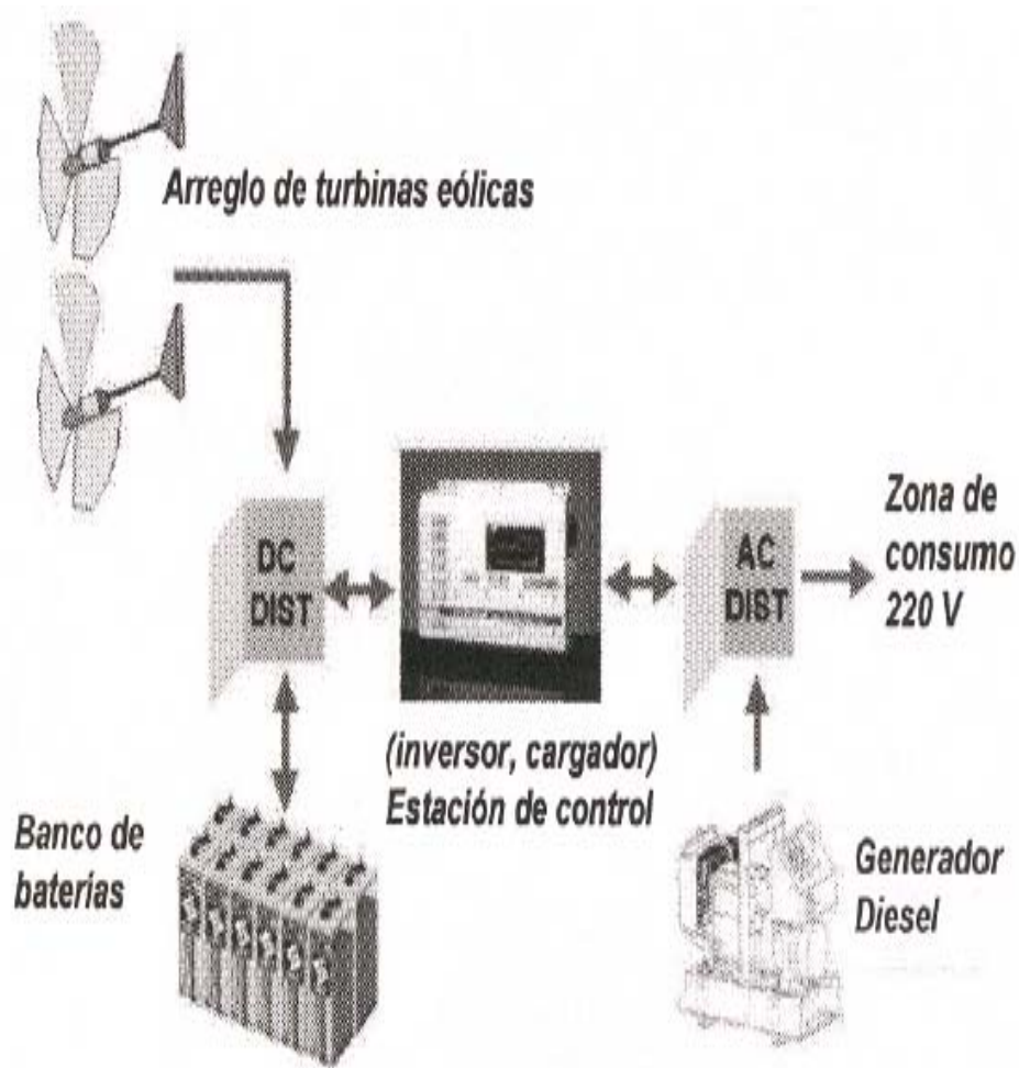
Fig. 4.2 Sistema híbrido eólico – diesel.
