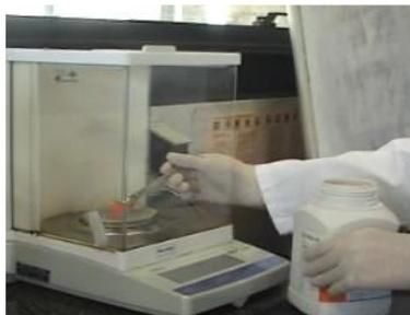
Pesar 1.0 mg de cada uno de los compuestos en una la placa con horadaciones
