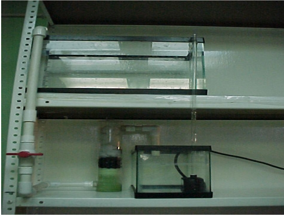
Fig. 3.- Sistema con pecera contenedora donde se encontraba una bomba sumergible, además de la filtración mecánica y química.
