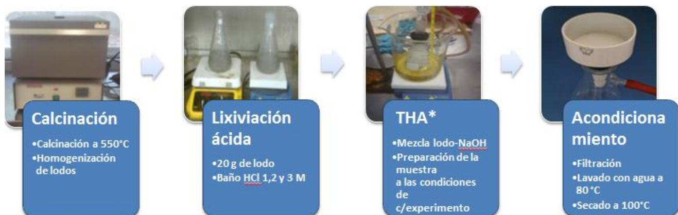
Figura 5. Diagrama de flujo “Síntesis de zeolitas”.\*THA. Tratamiento Hidrotermal Alcalino
