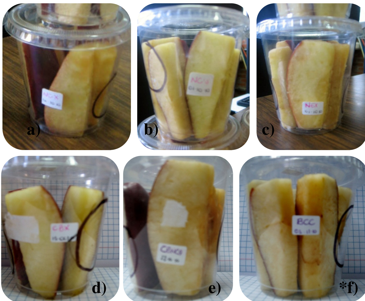
Fig. 15 Efectos sobre el color de diferentes recubrimientos después de 14 días de almacenamiento (a) NCSX; (b) NCS; (c) NEX; (d) GX; (e) NESf; (*f) BCC. *sólo dos días de almacenamiento debido a la rápida descomposición que presenta sin otro recubrimiento.
