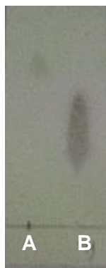
Figura 26. CCF al finalizar la síntesis del sustrato. A) Acetofenona ( R_f=0.65 ), B) 1-Fenietanol ( R_f=0.43 ).
