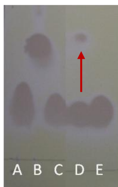
Figura 35. Evaluación de la reacción de síntesis del 1-Fenilacetato en éter diisopropílico. A) Estándar de 1-Feniletanol, B) Estándar de 1-Fenilacetato, C) Producto de la reacción con la estersa StcI, D) Producto de la reacción con Novozym 435, E) Blanco (reacción sin enzima),
