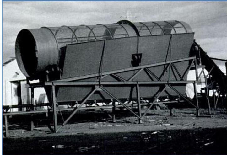
Figura 2.11 Ejemplo de un trommel de dos etapas (López y col., 1980)
