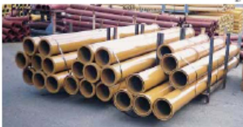
Fig. 2.5.12 Tubería para transporte del concreto hacia la cimbra
