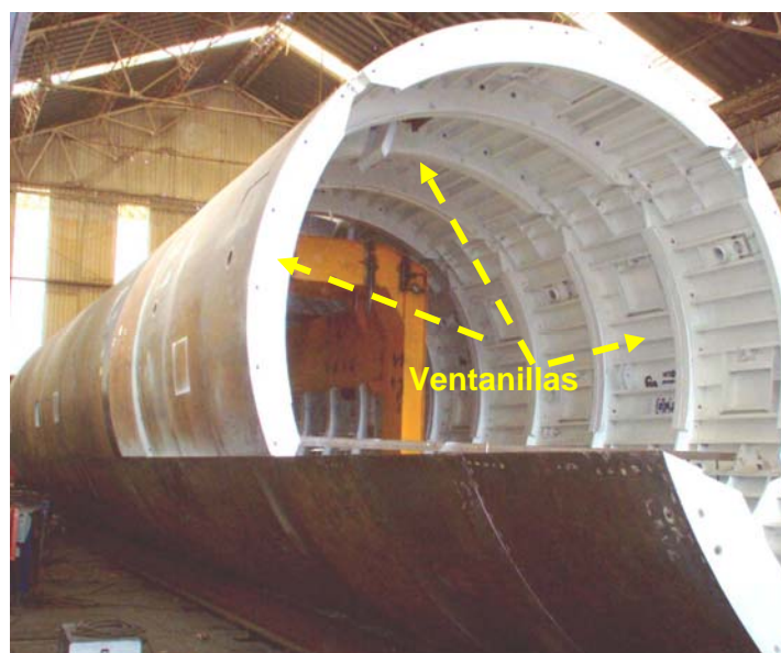
Fig. 2.5.2 Ventanillas de la Cimbra metálica telescópica.
