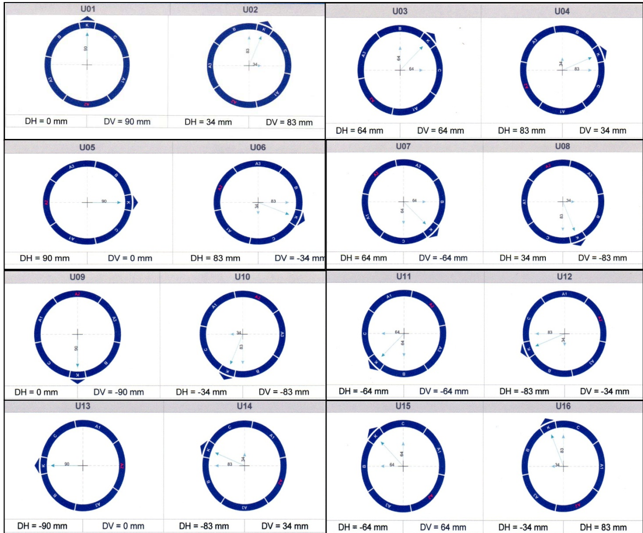
Fig. 4.1.3 Configuración de anillos en sus 16 posiciones
