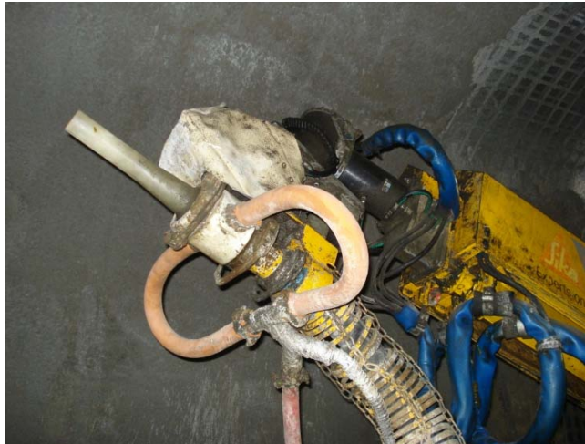
Fig. 2.5.14 Boquilla para lanzado de concreto
