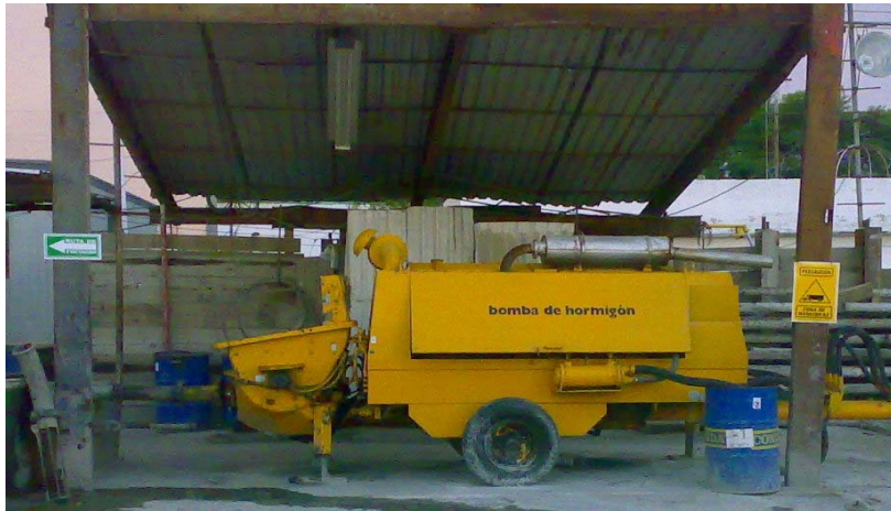
Fig. 2.5.11 Bomba para suministro de concreto
