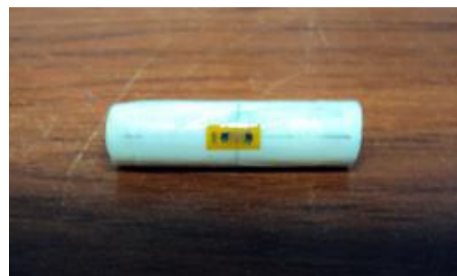
Figura 2.11. Fijación de los extensómetros en las muestra cilíndricas.
