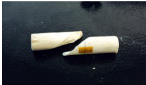
Figura 3.19. La zona de fractura se presentó en la región central de las muestras formando un ángulo aproximado de 45^\circ .
