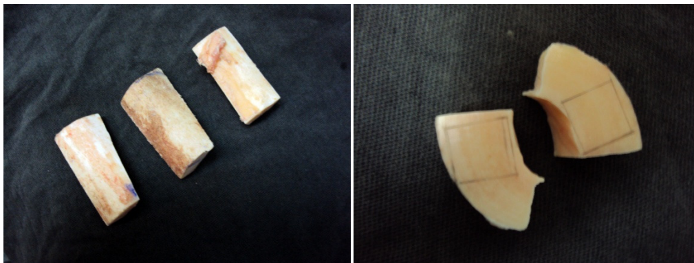
Figura 2.3. Fotos que muestran tres tiras elaboradas a partir de los cortes transversales previamente obtenidos y la guía marcada en estas.
