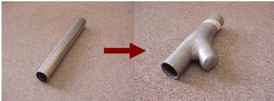
**Figura 4.6 Tubo Hidroformado**
