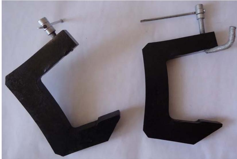
**Figura 6.2 Prensas deformadas por exceso de pólvora**
