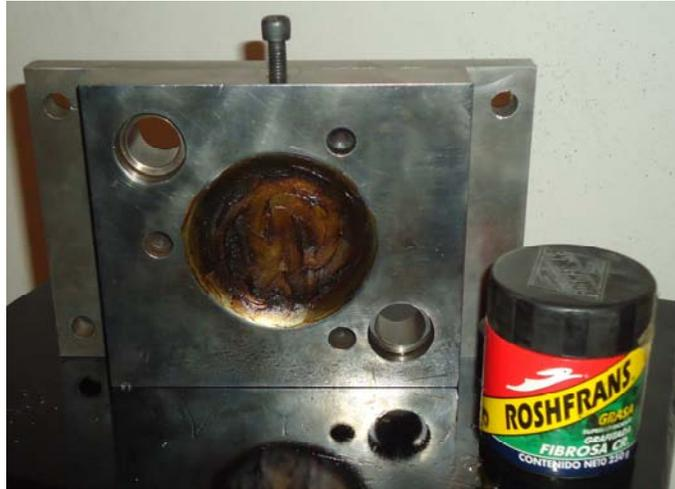
**Figura 6.7 Placa de cavidad con capa de grasa grafitada**
