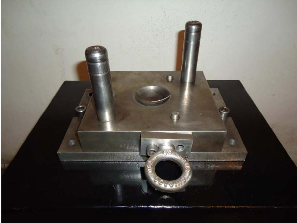
**Figura 5.10 Parte fija del molde**
