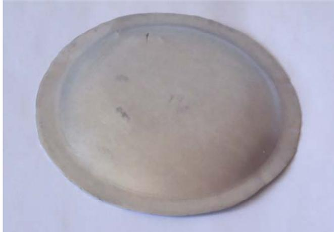
***Figura 6.5 Prueba sin éxito por falta de pólvora***
