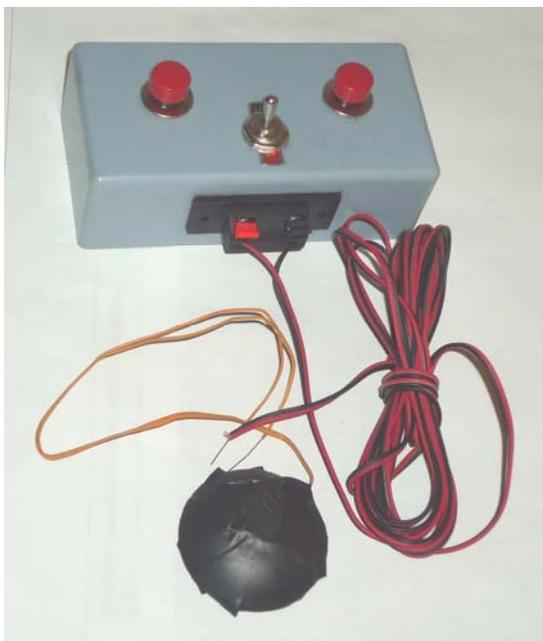
**Figura 5.23** Conjunto para detonación a distancia
