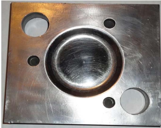
**Figura 5.6 Placa de cavidad acabado espejo**
