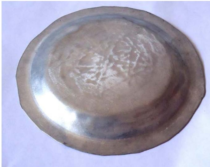
**Figura 6.11 Lamina detonada con 2.5 g de pólvora. Se obtiene la forma requerida**
