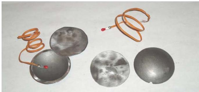
**Figura 6.8 Cerillos para encendido electrónico**
