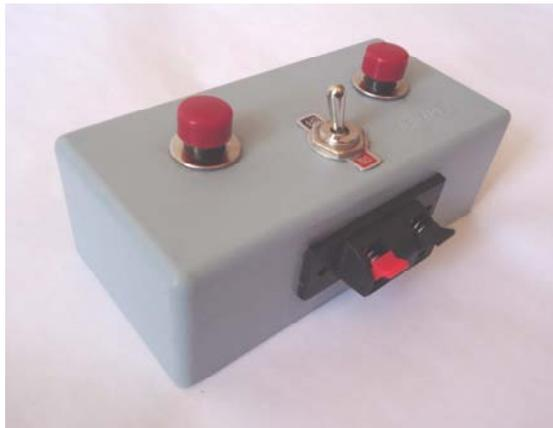
**Figura 5.22** Control electrónico para la detonación del explosivo
