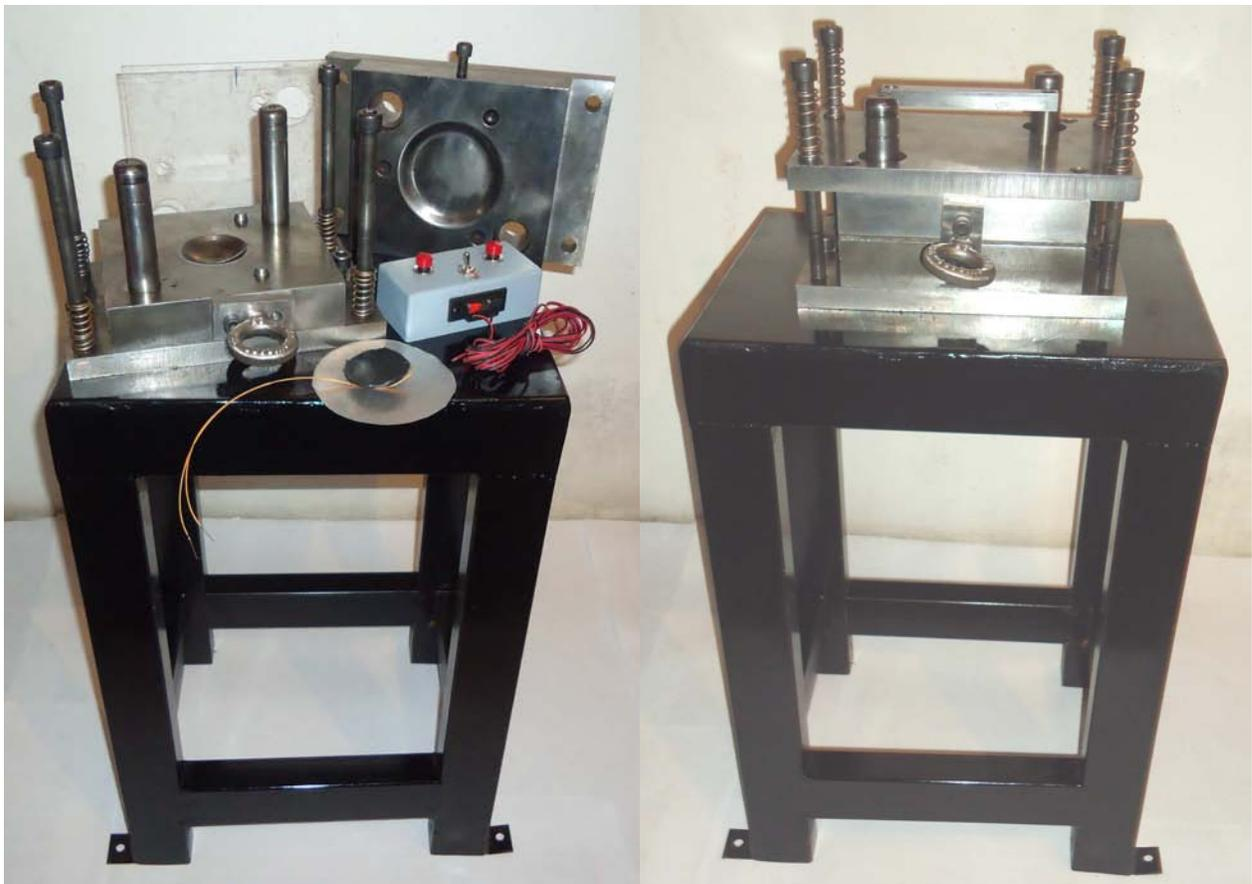
**Figura 6.13. Molde y aditamentos para la fabricación de un cenicero con explosivos**
