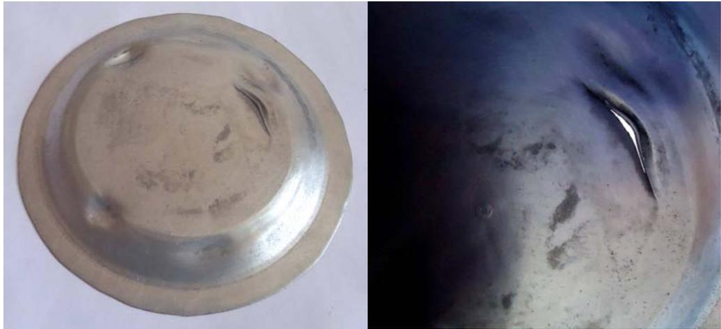
**Figura 6.10 Lamina fracturada por exceso de explosivo**
