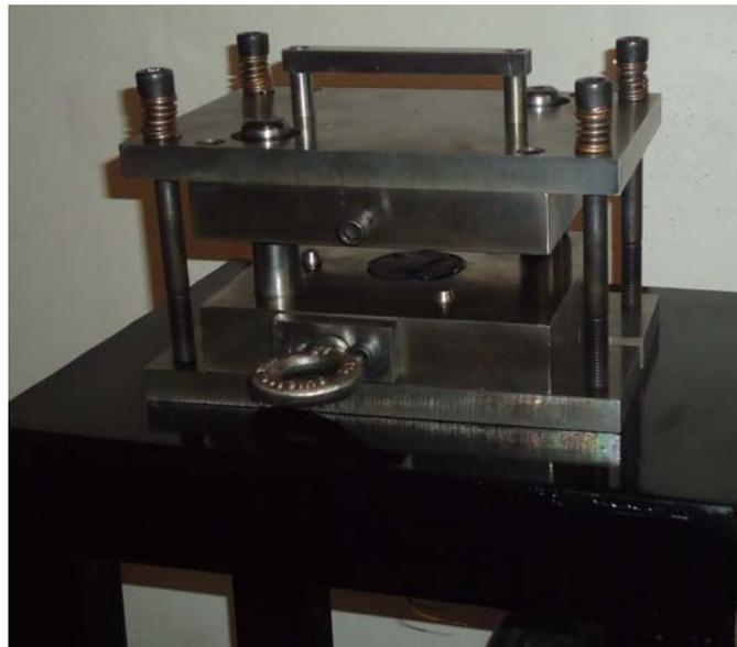
**Figura 6.4 Implementación del sistema de retorno**
