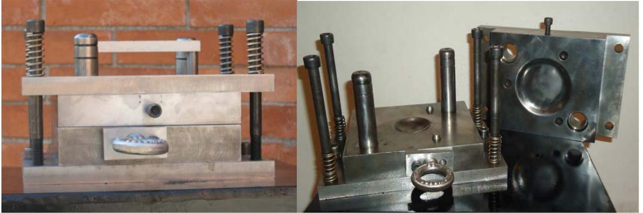
*Figura 5.17 Ensamble del molde*
