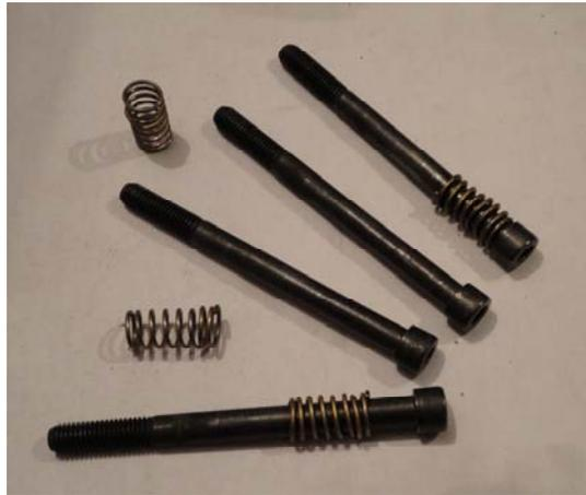
**Figura 5.8 Sistema de retorno para molde**
