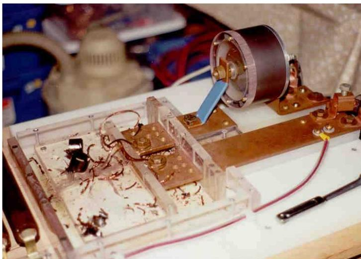
**Figura 4.11. Mesa de trabajo en la que se observa la bobina preparada para el disparo, el trigatrón (cilindro oscuro en el que se ve una bujía de encendido que asoma a la derecha) y las barras de alimentación de potencia. Se nota también el efecto de los disparos previos.**
