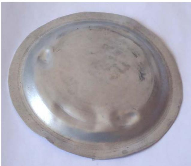
***Figura 6.9 Prueba con 1.5 g de pólvora “formación de bolsas de aire”***
