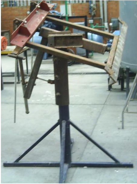
Figura 8.1.2 Estado inicial en el que se encontraba la base de seguimiento solar.
