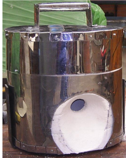
Figura 8.1.23 Crisol terminado, forrado con fibra cerámica y recubierto con lámina de acero inoxidable
