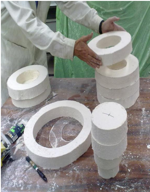
Figura 8.1.10 Recorte de círculos de fibra cerámica para el aislamiento del crisol metálico.
