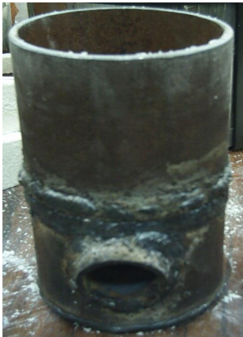
Figura 8.1.30 Pieza que se atornilla a la antena para detener la U de sujeción.
