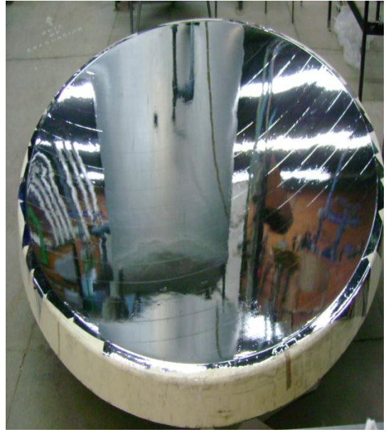
Figura 8.1.7 Superficie Parabólica recubierta con material reflejante.
