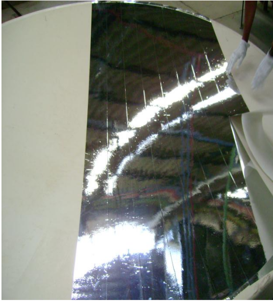
Figura 8.1.6 Colocación del material reflejante sobre la parábola.
