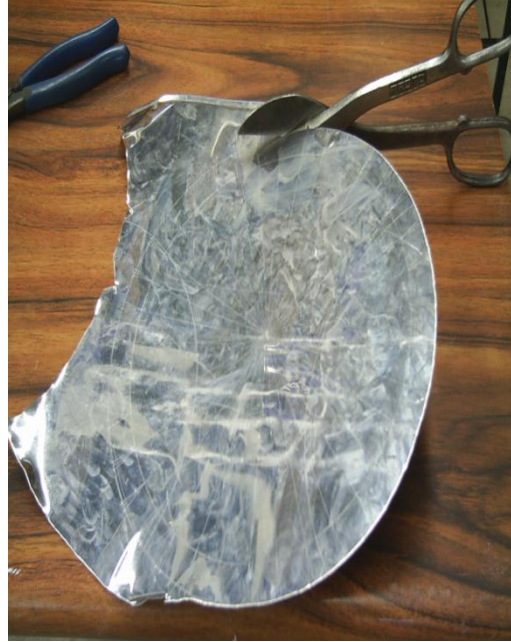
Figura 8.1.17 recorte de las tapas de los cilindros de lámina.
