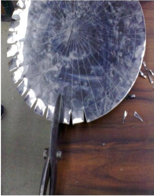
Figura 8.1.18 Corte para realizar ceja para fijación.
