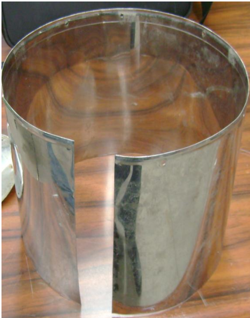
Figura 8.1.20 Lámina rolada para forrar la fibra cerámica.
