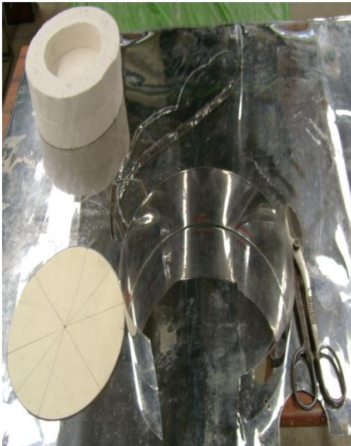
Figura 8.1.16 Lámina para forrar la fibra cerámica del crisol.
