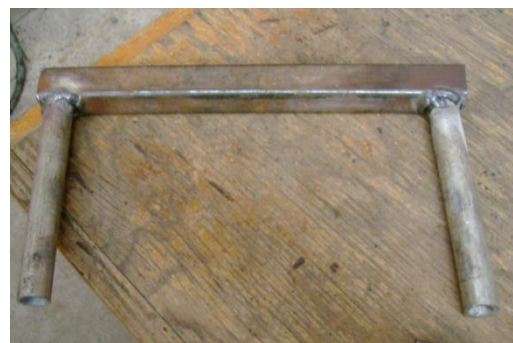
Figura 8.1.25 Agarradera que se soldará en el porta crisol.
