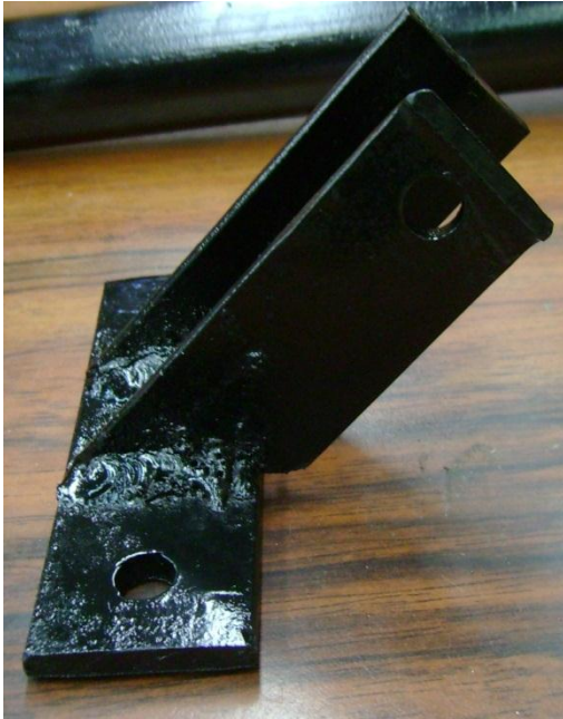
Figura 8.1.30 Pieza que se atornilla a la antena para detener la U de sujeción.
