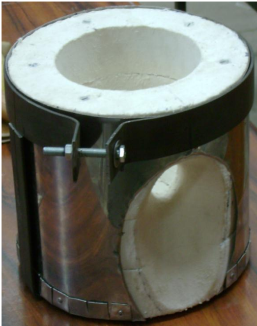
Figura 8.1.24 Cincho que sujetará al crisol.
