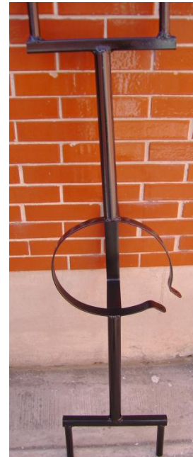
Figura 8.1.27 Porta crisol terminado.
