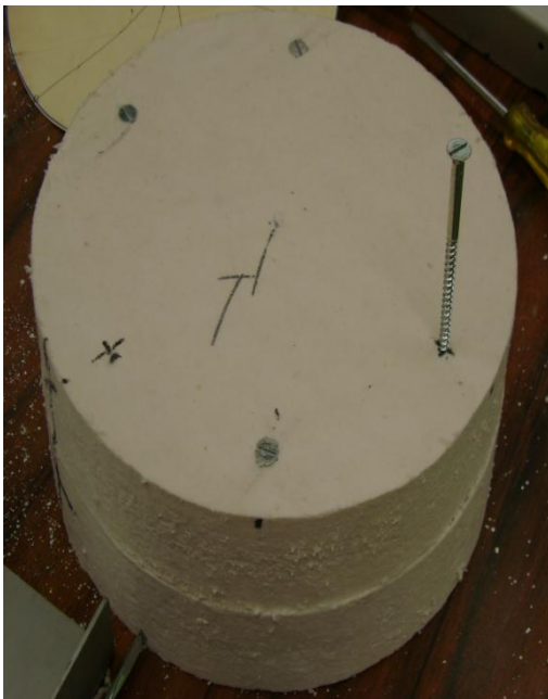
Figura 8.1.10 Recorte de círculos de fibra cerámica para el aislamiento del crisol metálico.
