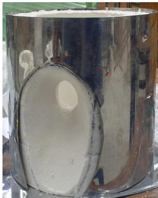
Figura 8.1.21 Fibra recubierta de lámina con corte para la entrada de radiación.
