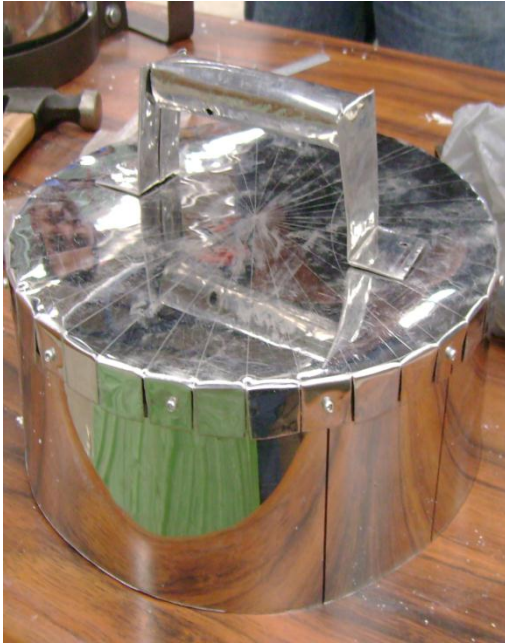
Figura 8.1.22 Tapadera del crisol forrada con lámina.
