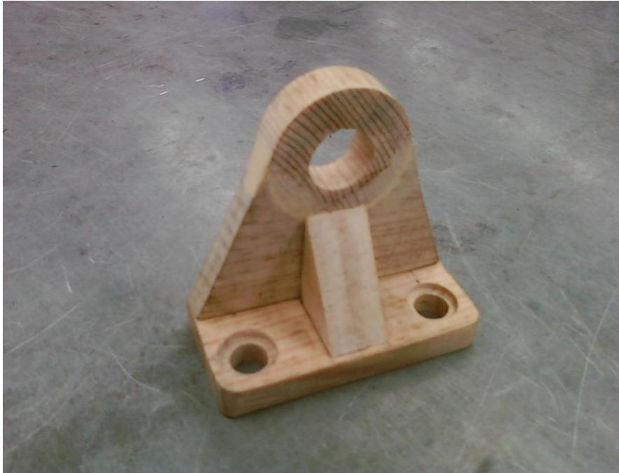
Figura B.4 Imagen real del soporte del eje.
