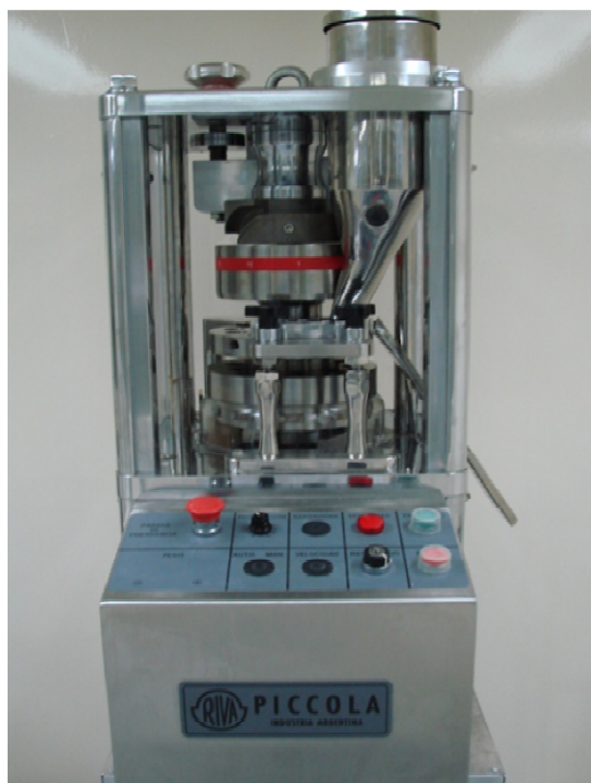
Figura 2. Estructura de la Tableteadora
