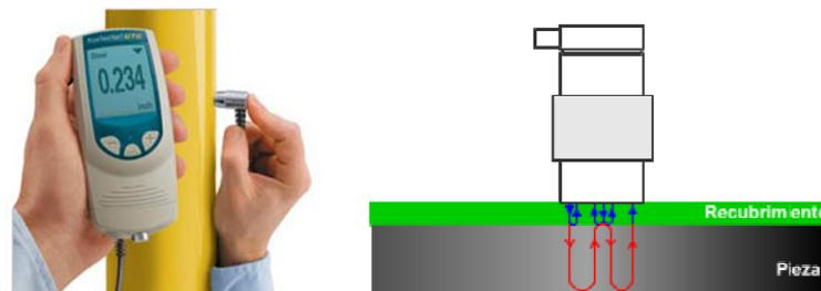
La dimensión mínima del espesor del recubrimiento representa una variable importante en su medición, debido a la capacidad del equipo y al rango de inspección del transductor. Para estos casos se puede contar con medidores de espesores de pequeñas dimensiones, que además pueden tener transductores de altas frecuencias.
