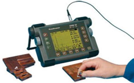
El **barrido “B”** es considerado como un corte transversal de la pieza inspeccionada, el cual muestra cómo se presenta físicamente el deterioro o cambio de sección.
