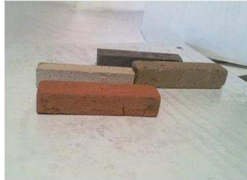
IMAGEN I.6. 13 Vista de suelos después de la prueba de contracción lineal
