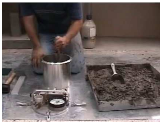
IMAGEN III.5. 2 Compactación del concreto fresco tal como se realiza una muestra cilíndrica.
