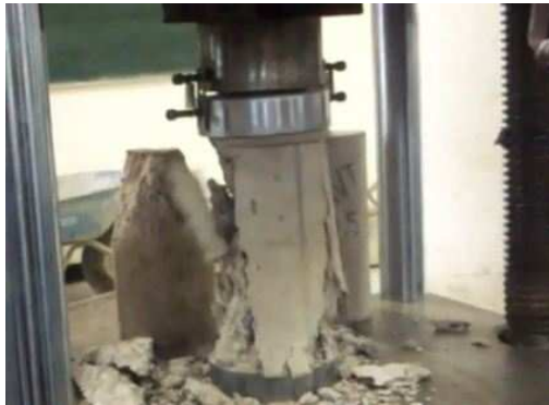
IMAGEN III.9 1 Colapso del espécimen
