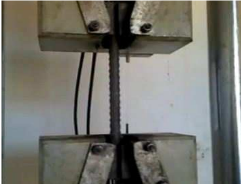
IMAGEN IV.4 1 Montaje de la probeta en la maquina y aplicación de la tensión.(Limite elástico)
