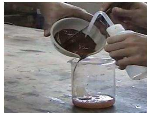
IMAGEN I.8 4 mezclar solución + suelo
