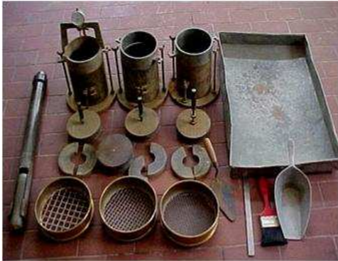
IMAGEN II.9. 1 Materiales para prueba de VRS
