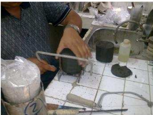
IMAGEN I.12. 3 Corte del material inalterado en base metálica
