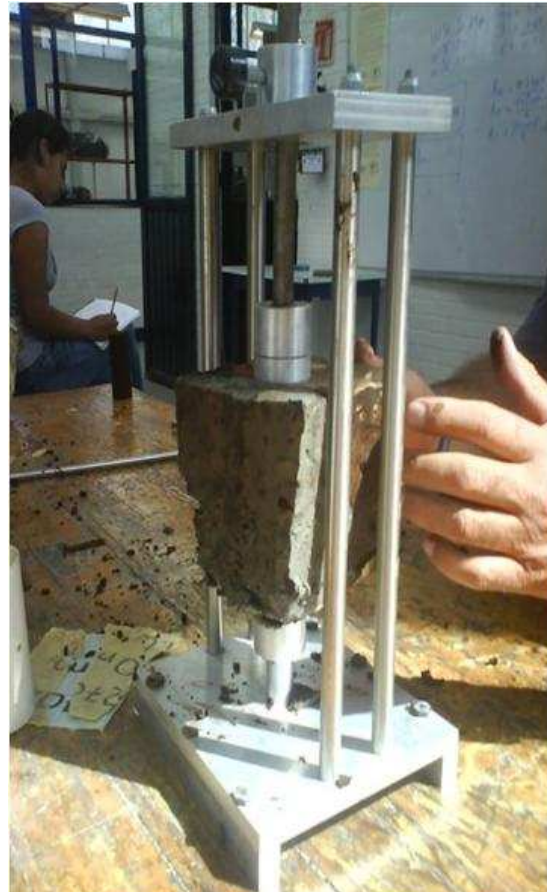
IMAGEN I.12. 10 Porción de material inalterado en el torno de labrado
