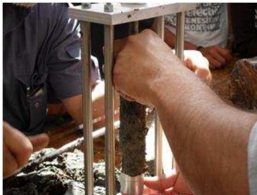
IMAGEN I.12. 11 Probeta labrada para y lista para la prueba
