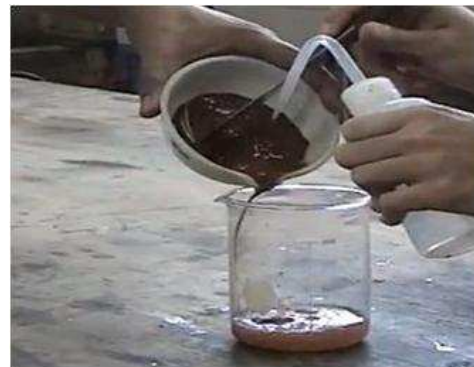
IMAGEN I.8 10 Mezclar suelo agua destilada.
