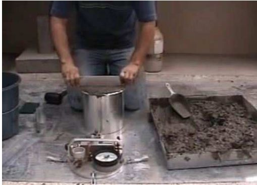
IMAGEN III.5. 3 Enrase del concreto fresco tal como se realiza una muestra cilíndrica.
