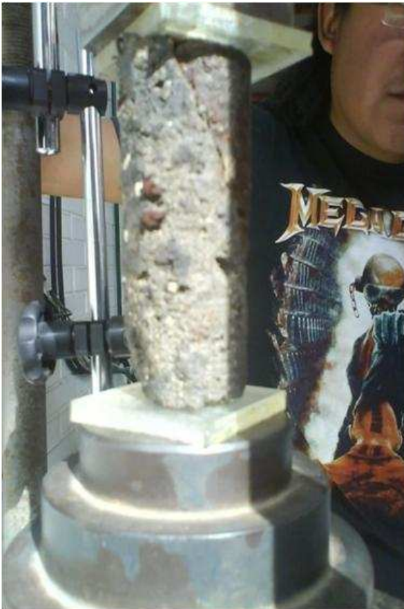
IMAGEN I.12. 14 Vista de la falla en la muestra de suelo
