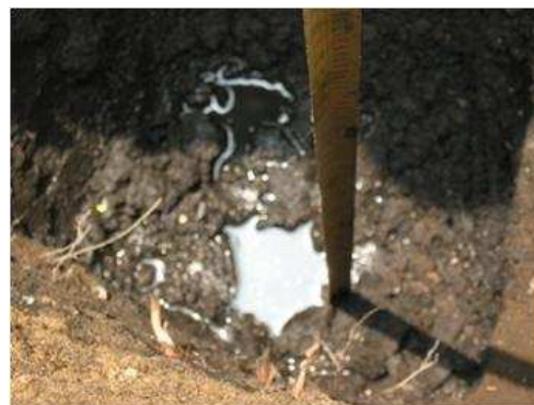
IMAGEN I.3. 12 Toma de medidas del nivel freático
