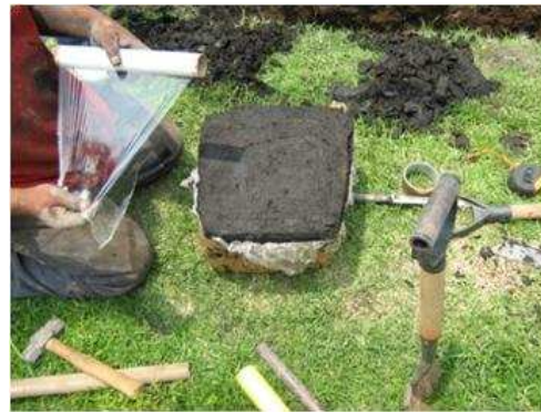
IMAGEN I.3. 10 Recubrimiento de la muestra en la cara faltante.
