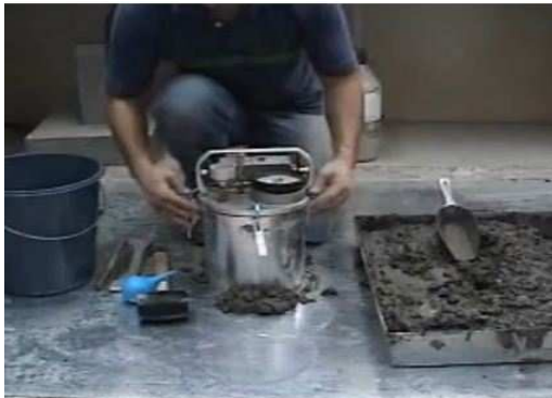
IMAGEN III.5. 5 Montaje del aparato y cierre de la cubierta y se abre la válvula de purga de agua
