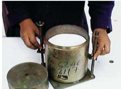
IMAGEN II.9. 10 Colocado de filtros
