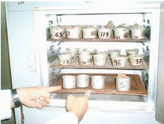
IMAGEN I.5 3 Colocación de los recipientes con las muestras dentro del horno.
