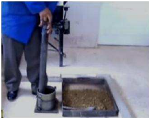
IMAGEN II.6. 7 Compactación de capas
