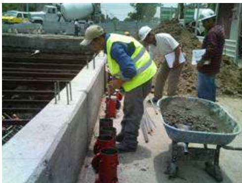
IMAGEN III.4. 3 Llenado de la primera capa de molde
