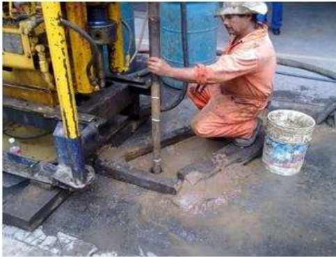
IMAGEN I.4 7 Vista del muestreo con tubo partido
