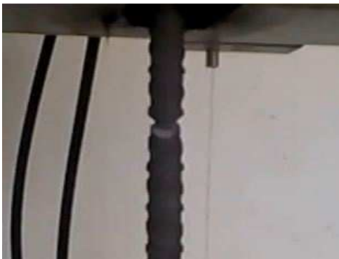
IMAGEN IV.4 3 Vista de la deformación de la probeta de acero.
