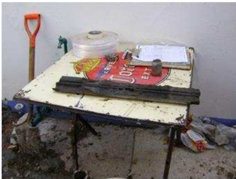
IMAGEN I.4 9 Vista del tubo partido con material inalterado
