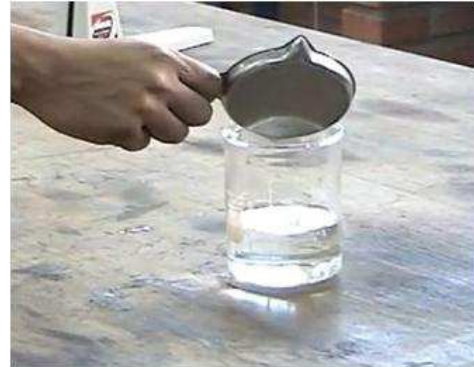
IMAGEN I.8 2 Agregar a 250 ml de agua destilada
