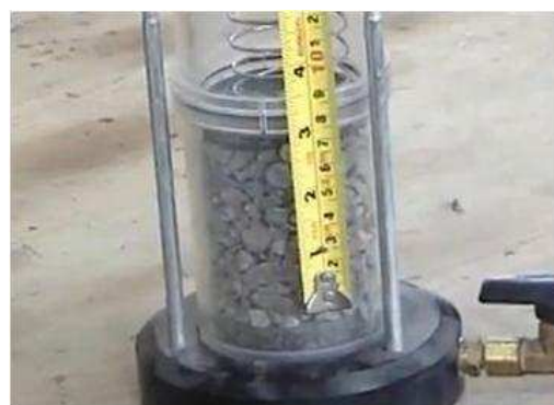
IMAGEN I.9. 6 Toma de medidas del estrato compactado
