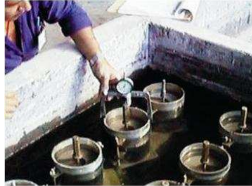
IMAGEN II.9. 14 Tanque de saturación
