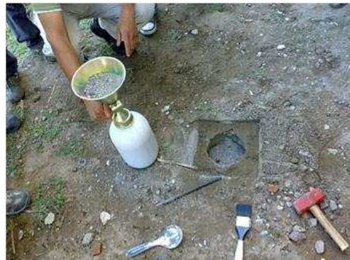
IMAGEN II.8. 4 Colocación de arena en cala.
