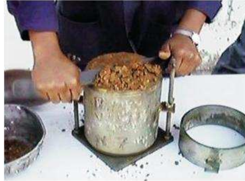
IMAGEN II.9. 8 Compactación del material
