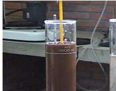
IMAGEN I.8 16 Colocar el termómetro en probeta No°1 así como el hidrómetro y hacer nuevas lecturas
