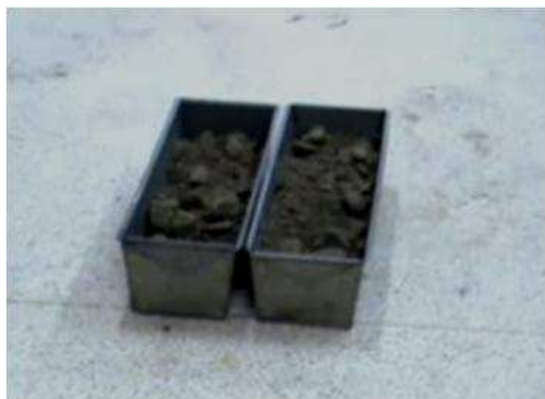
IMAGEN II.5. 6 Resultado de la prueba por cuarteo
