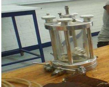
IMAGEN I.14. 7 Vista de la cámara triaxial
