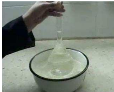
IMAGEN I.11. 4 Enfriamiento del picnómetro.
