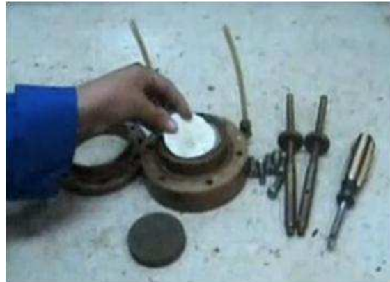
IMAGEN I.13. 10 Saturación de piedras porosas y papel filtro
