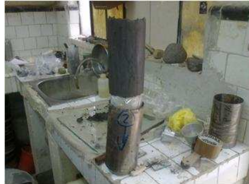
IMAGEN I.12. 2 Extracción del material inalterado del tubo Shelby
