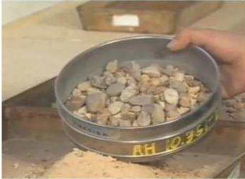
IMAGEN II.10. 13 Cribado del material
