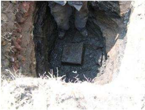
IMAGEN I.3. 7 Obtención de muestra cubica en el sitio
