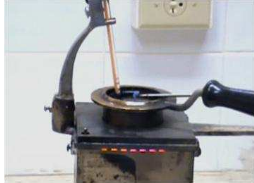
IMAGEN II.12 4 Colocación de la flama en la copa
