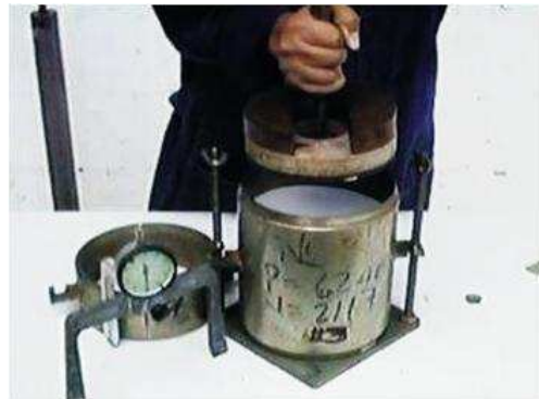
IMAGEN II.9. 12 Colocado de equipo de medición para la expansión
