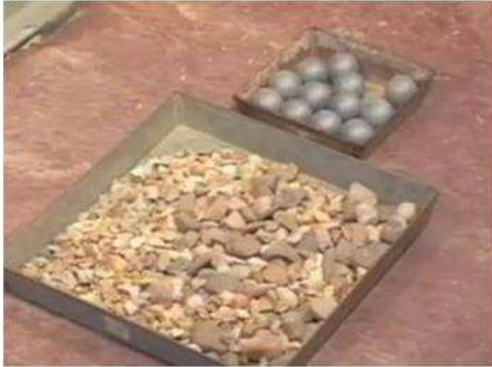
IMAGEN II.10. 7 Muestra de material y esferas de acero.
