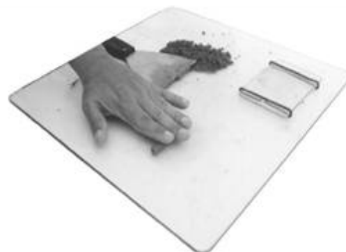
IMAGEN I.6. 10 Determinación del límite plástico.
