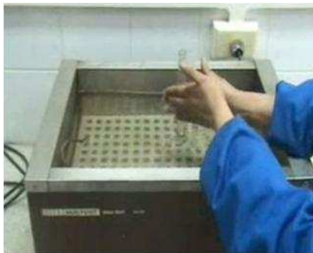
IMAGEN I.11. 3 Extracción de aire por baño maría.
