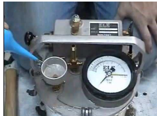
IMAGEN III.5. 6 Inyección de agua, y golpeteo del recipiente de manera suave
