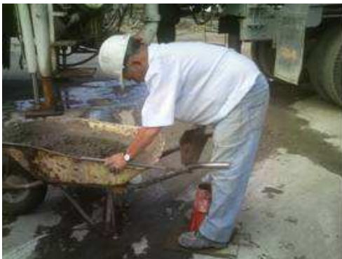
IMAGEN III.3. 3 Llenado de la tercera capa de molde
