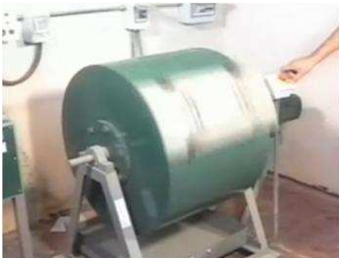
IMAGEN II.10. 11 Proceso de la máquina de los ángeles
