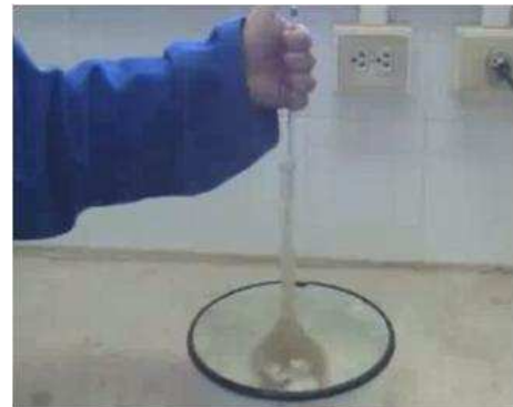
IMAGEN I.11. 8 Llenado de agua a la marca de aforo del picnómetro
