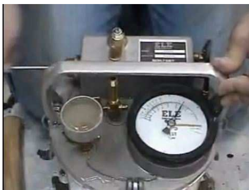
IMAGEN III.5. 7 Se abre la válvula y se golpean los lados para liberar las presiones y estabilizar el indicador
