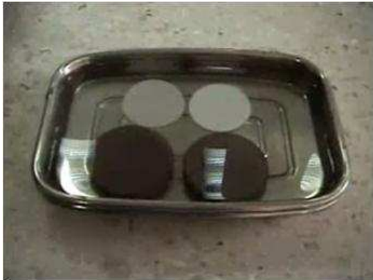
IMAGEN I.13. 9 Saturación de piedras porosas y papel filtro
