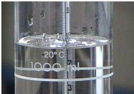
IMAGEN I.8 9 Tomar 2 Lectura en probeta N°2 el cual será la corrección.
