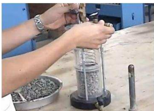
IMAGEN I.9. 5 Armado del permeámetro con la muestra compactada
