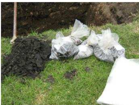
IMAGEN I.3. 11 Obtención de material alterado del pozo a cielo abierto
