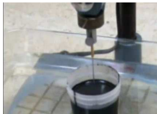
IMAGEN II.11 6 Penetración de producto asfáltico
