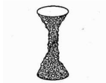
FIGURA III. 9 Falla de los cilindros de concreto.
