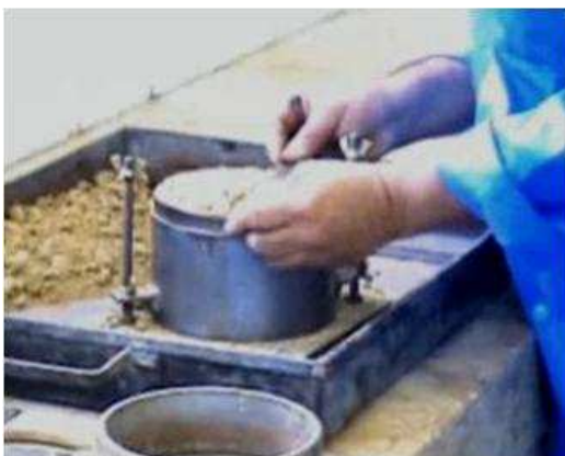
IMAGEN II.6. 9 Enrasado de material en el molde
