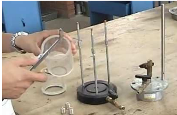
IMAGEN I.9. 2 Toma de diámetro permeámetro
