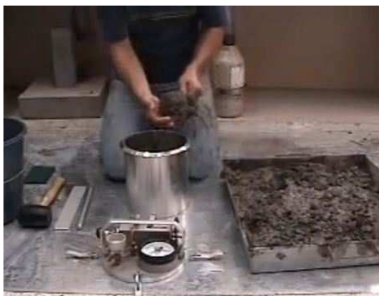
IMAGEN III.5. 1 Colocación del concreto fresco tal como se realiza una muestra cilíndrica..
