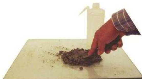
IMAGEN I.6. 2 Preparación del contenido de agua
