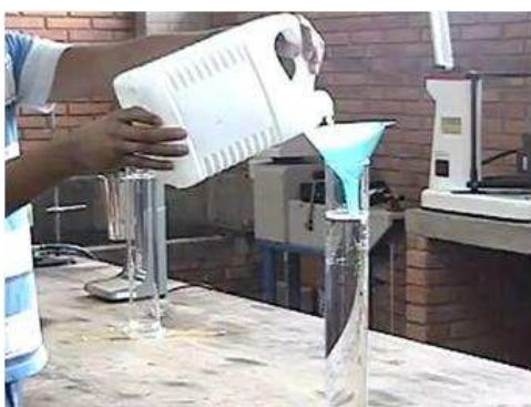
IMAGEN I.8 5 Corrección por menisco.
