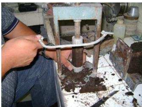
IMAGEN I.12. 5 labrado del material para ensayo
