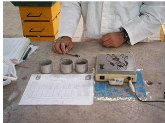
IMAGEN I.5 4 Peso de las muestras secas y registro de los datos para el cálculo.
