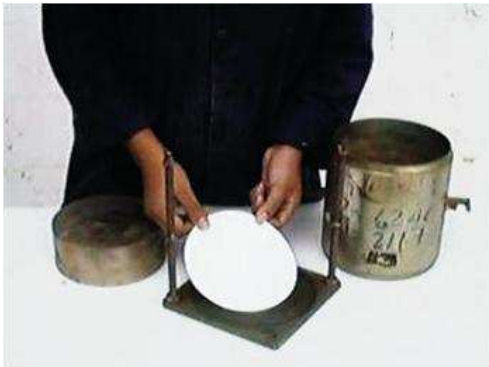
IMAGEN II.9. 9 Colocado de filtros
