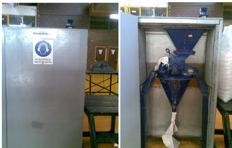
Fig. 3.6. Molino de martillos, proporcionado por el Laboratorio de Ingeniería Química, Facultad de Química, UNAM, México
