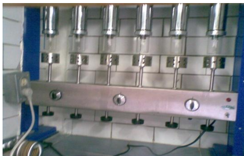
Figura I.3. Equipo Goldfish para extracción de grasa marca CRAFT
