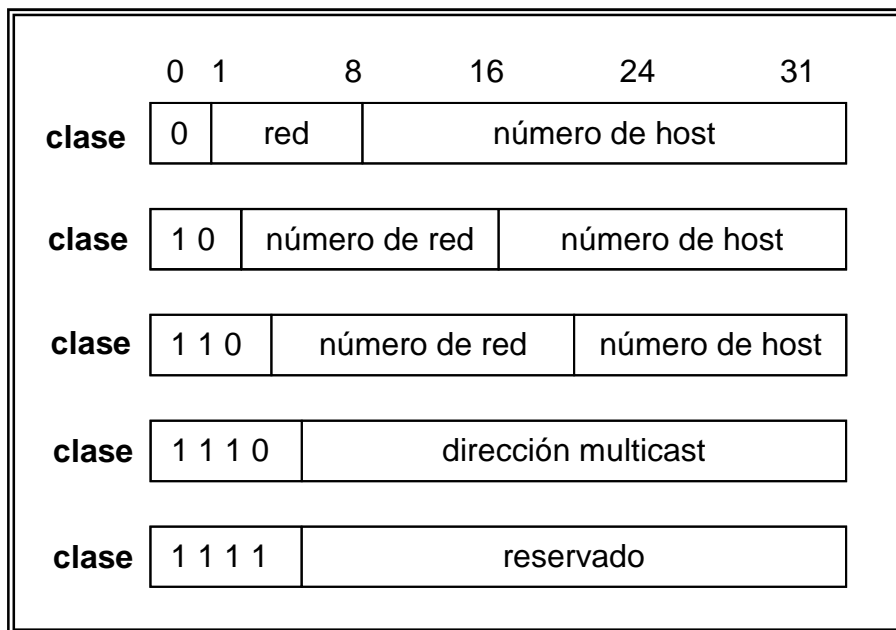
Fig. 1.2 Clases asignadas de direcciones de Internet.
