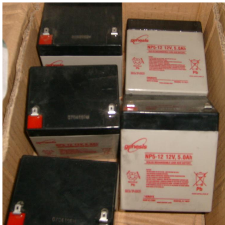
Fig. 3.20 Baterías de gel para UPS
