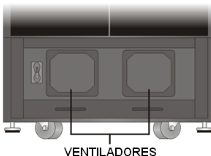
Fig. 3.14 Ubicación de los ventiladores en equipo
