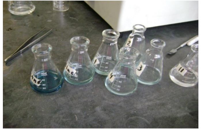
Fig.22 Fósforo soluble reactivo y total por el método del fosfomolibdato
