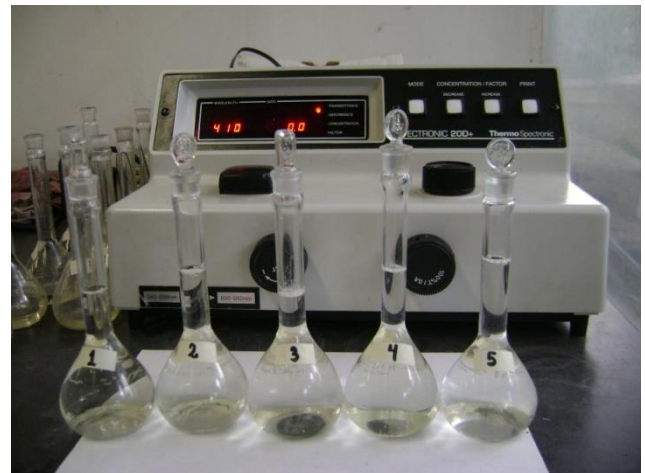
Fig.19 Determinación de nitratos por el método del ácido fenoldisulfónico.
