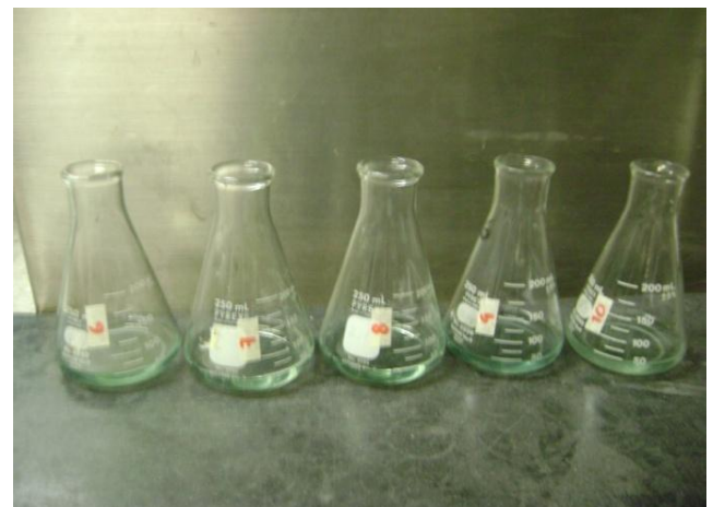
Fig.21 Determinación de amonio por el método del azul de indofenol.
