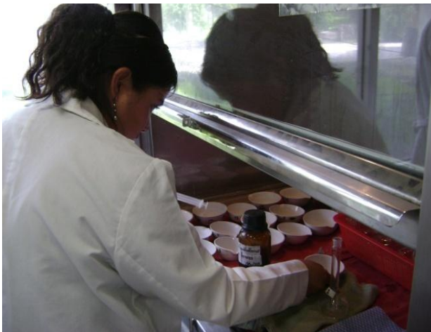
Fig.19 Determinación de nitratos por el método del ácido fenoldisulfónico.
