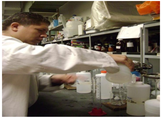
Fig.18 Filtración de muestras colectadas en campo para la determinación de nutrientes.
