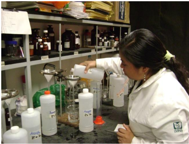
Fig.18 Filtración de muestras colectadas en campo para la determinación de nutrientes.
