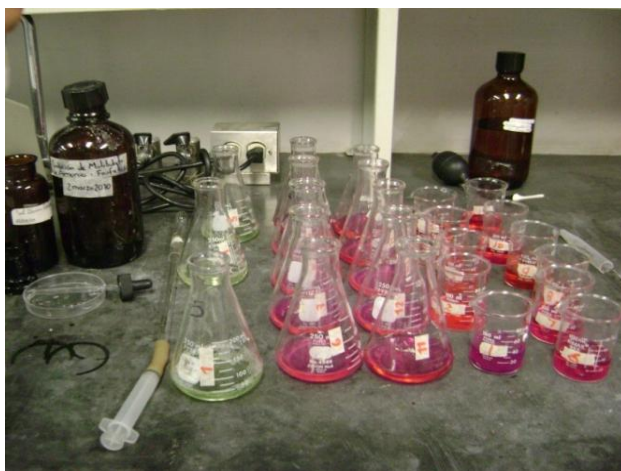
Fig.20 Determinación de nitritos por el método del ácido sulfanílico.
