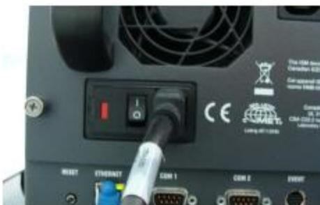
**Figura 11.** Conexión de energía TGA ubicada en la parte posterior del instrumento.
