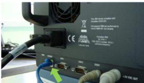
**Figura 22.** Conexión de red ubicada en la parte posterior de DSC.
