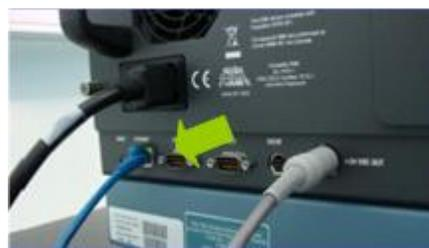
**Figura 14.** Conexión de red ubicada en la parte posterior de TGA.
