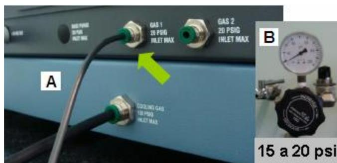
**Figura 12.** Conexión de gas de Purga.
