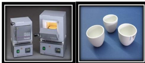
**Figura 30.** Mufla y crisoles utilizados en la técnica
