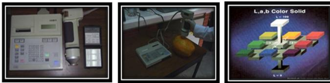
Figura 33. Colorímetro marca Minolta
