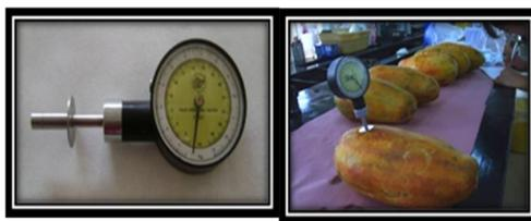
**Figura 32.** Penetrómetro
