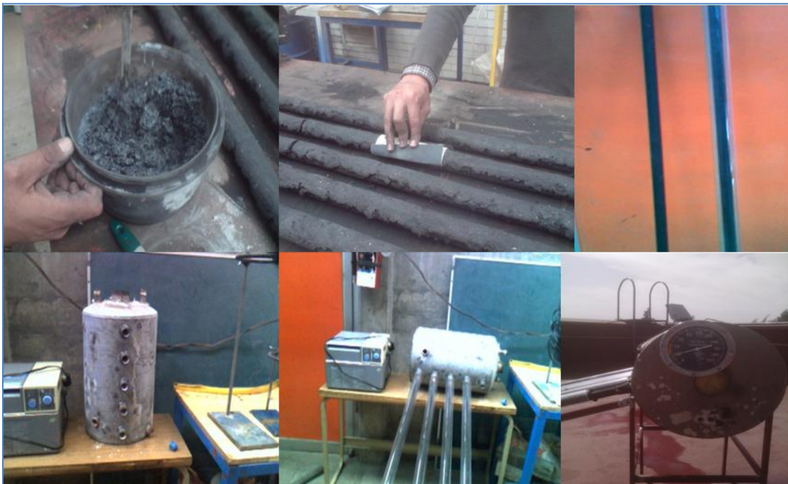
FIGURA 4. 1.- Detalles de construcción del prototipo a escala del sistema, desarrollado por alumnos de Servicio Social de la FES “Zaragoza”. Fuente: Informe de Servicio Social, “DESARROLLO DE TECNOLOGIA PARA EL APROVECHAMIENTO DE ENERGIAS RENOVABLES”.
