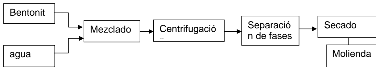
Figura 10. Procedimiento experimental para la preparación de la bentonita.
