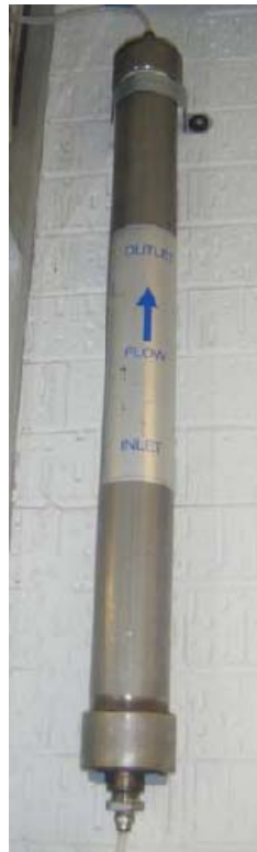
Figura A..4.5 Destructor catalítico de ozono
