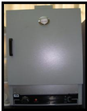
Figura 16. Estufa de aire caliente para determinar humedad
