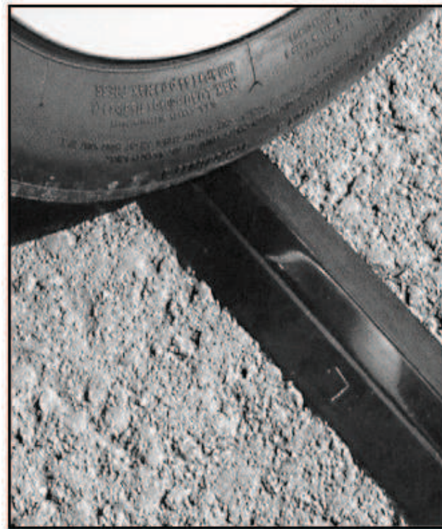
Figura 4.4. Ubicación del sensor de montaje superficial en el paso de las llantas.
