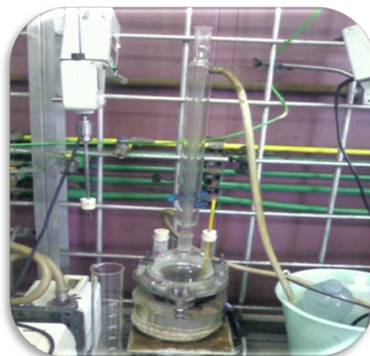
Figura 11. Hidrólisis débil de celulosa (105 °C).
