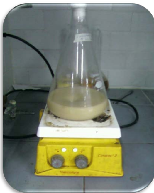
Figura 14. Fermentación anaeróbica de la solución hidrolizada.
