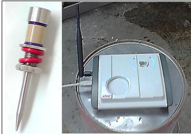
**Figura 11.** Sensor de temperatura y dispositivo receptor de señales.
