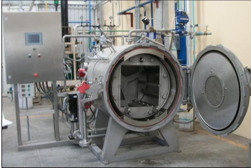
**Figura 10.** Autoclave Horizontal (MAQUINARIA JERSA S.A. de C.V.)
