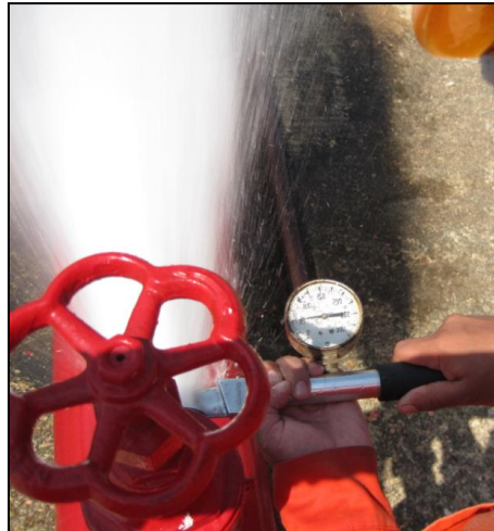
Figura 20. Medida de la presión de un lanza con un tubo Pitot
