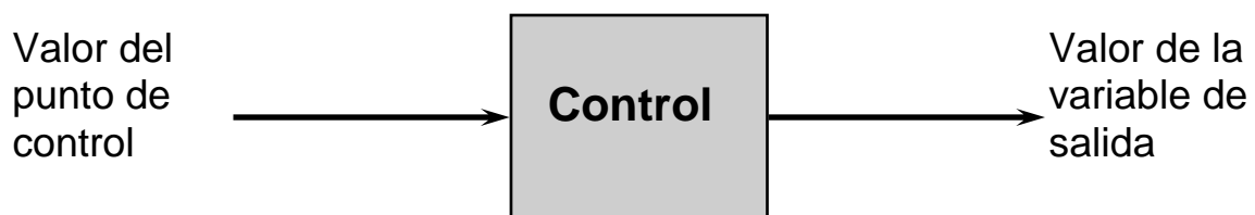
Figura. 1.5 Sistema de control en lazo abierto
